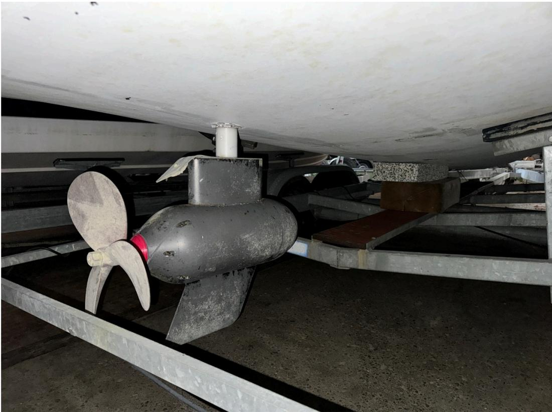
Abb.#17: Elektroantrieb Gondel, verbogene Platte für Opferanode
