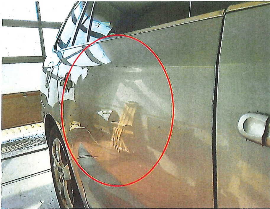
Bild 21 : Tür hinten rechts verformt
