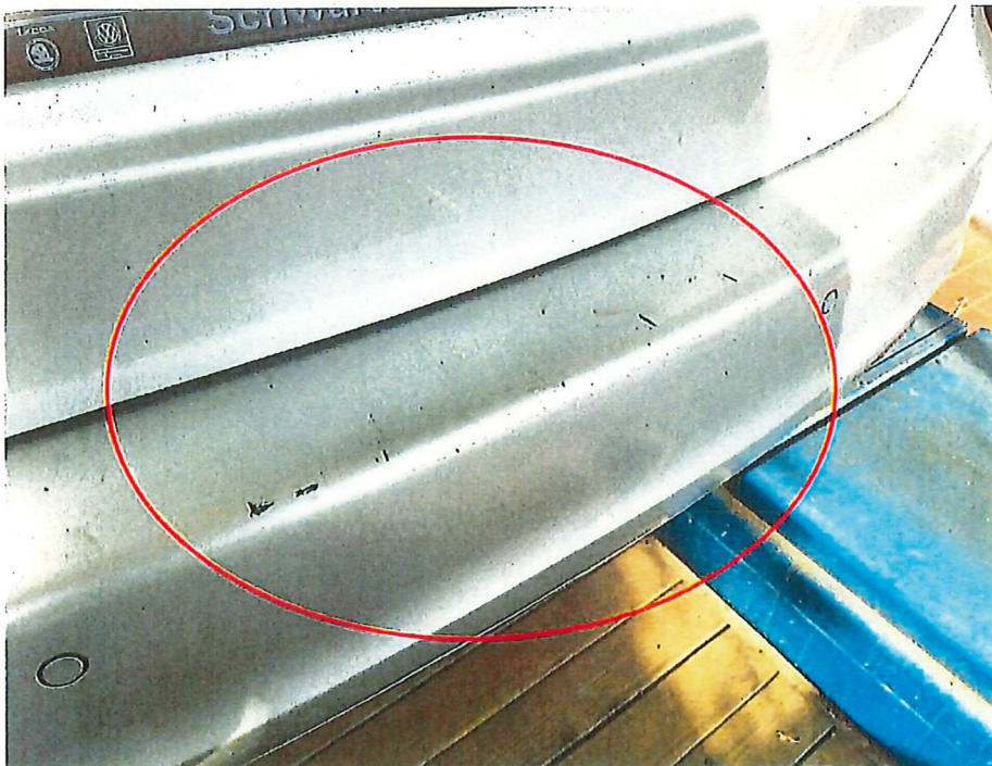
Bild 12 : Stoßfänger hinten verschrammt
