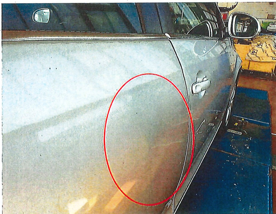
Bild 20 : Tür hinten rechts verformt
