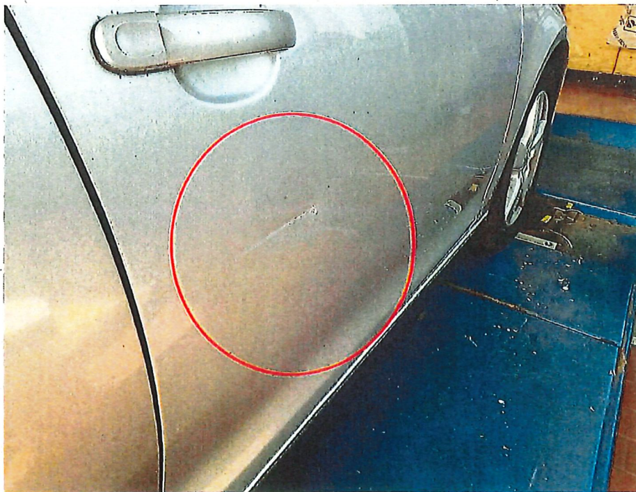
Bild 22 : Tür vorne rechts verformt
