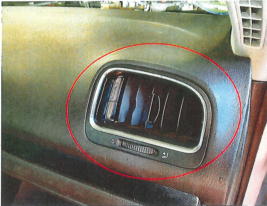
Bild 23 : Luftausströmer rechts gebrochen
