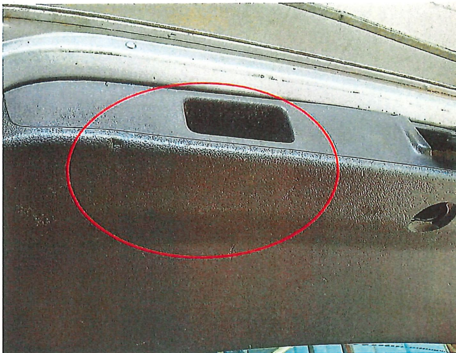
Bild 15 : Verkleidung Heckklappe gebrochen
