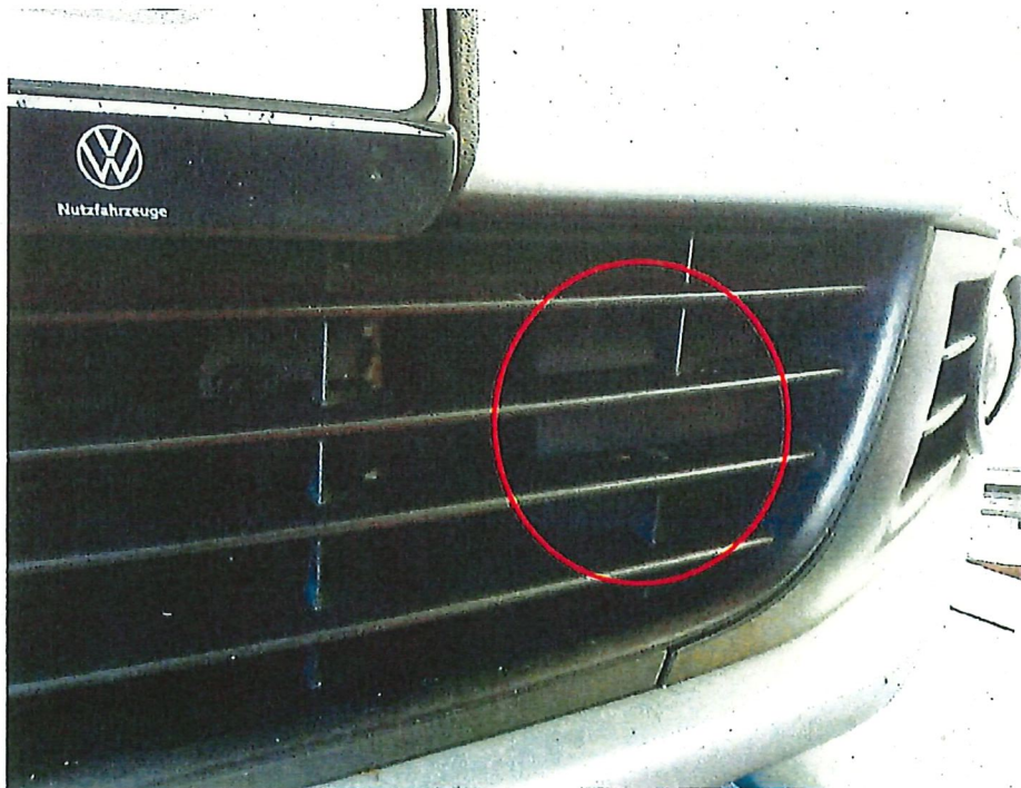
Bild 30 : Lüftungsgitter vorne unten gebrochen
