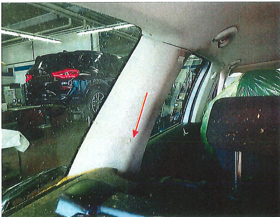
Bild 18: Verkleidung C-Säule links verschrammt
