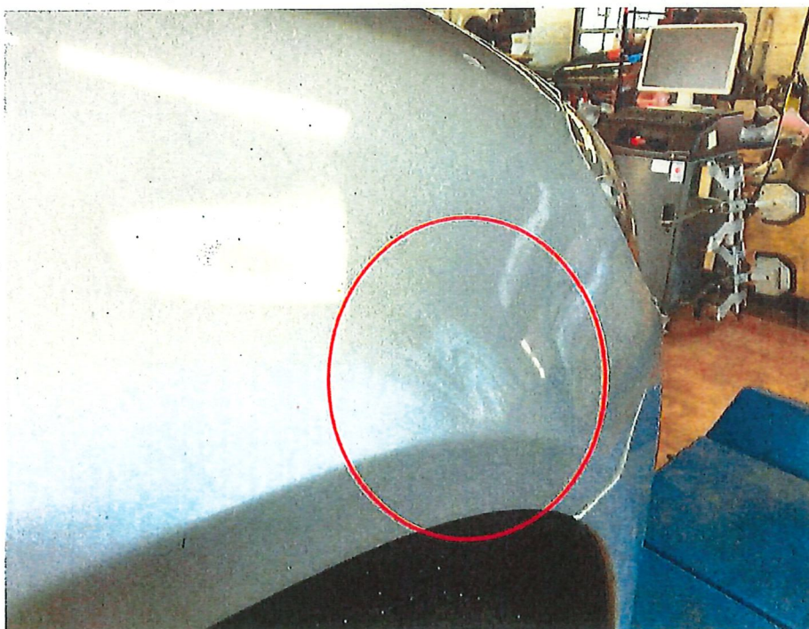
Bild 26 : Kotflügel vorne rechts verformt
