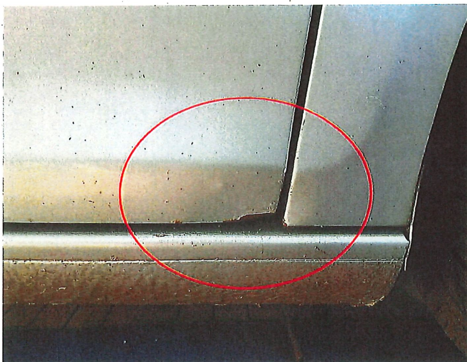
Bild 25 : Tür vorne rechts verformt
