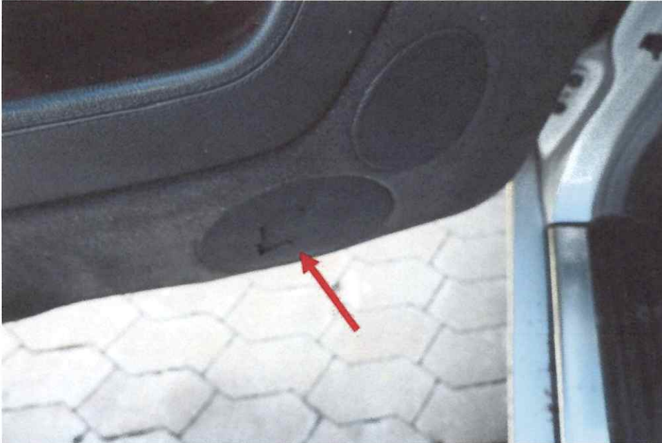
Türlautsprecher links gebrochen
