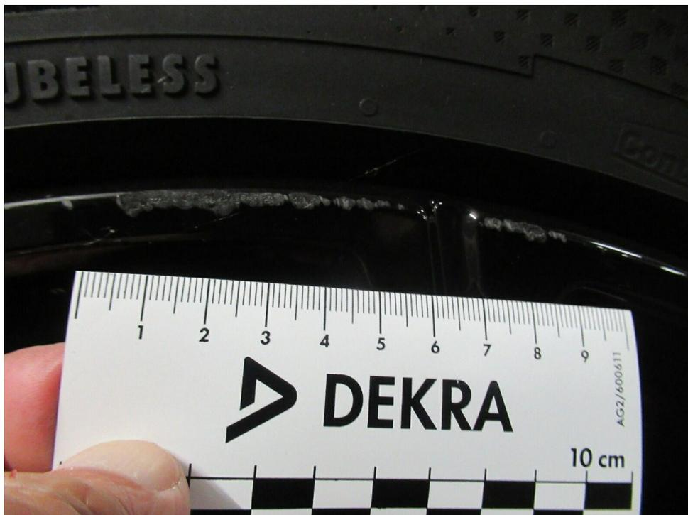
Bild 16 : Felge hinten rechts, zerkratzt, smart repair
