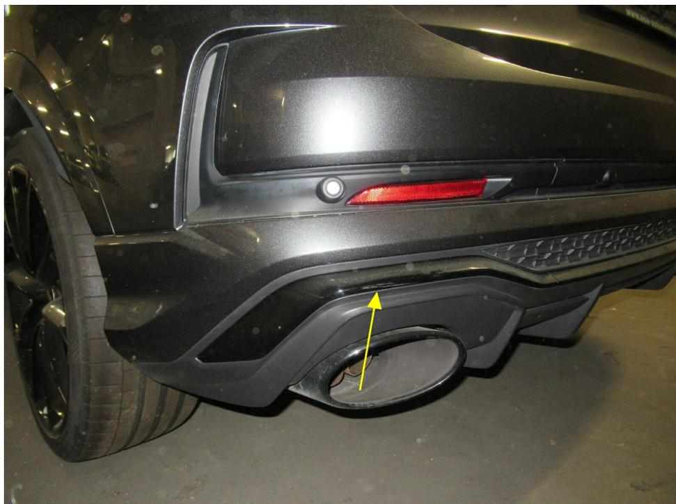
Bild 18 : Stoßfängerverkleidung hinten, Blende verkratzt
