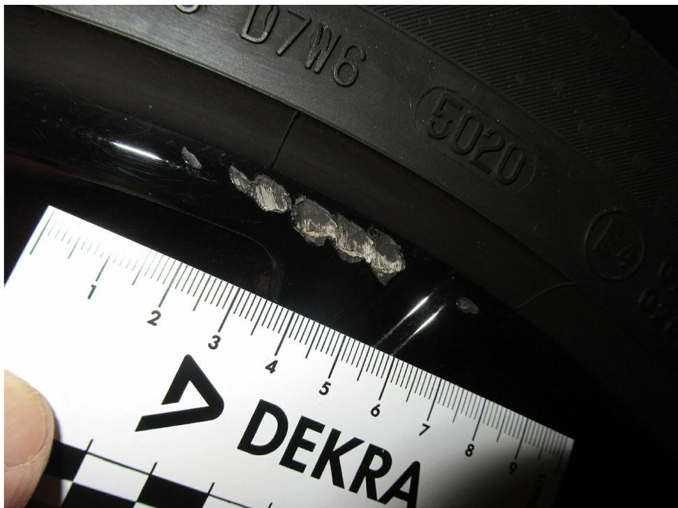
Bild 14 : Felge vorne rechts, verschrammt, smart repair
