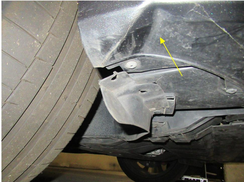
Bild 13 : Stoßfängerverkleidung vorne rechts eingedrückt
