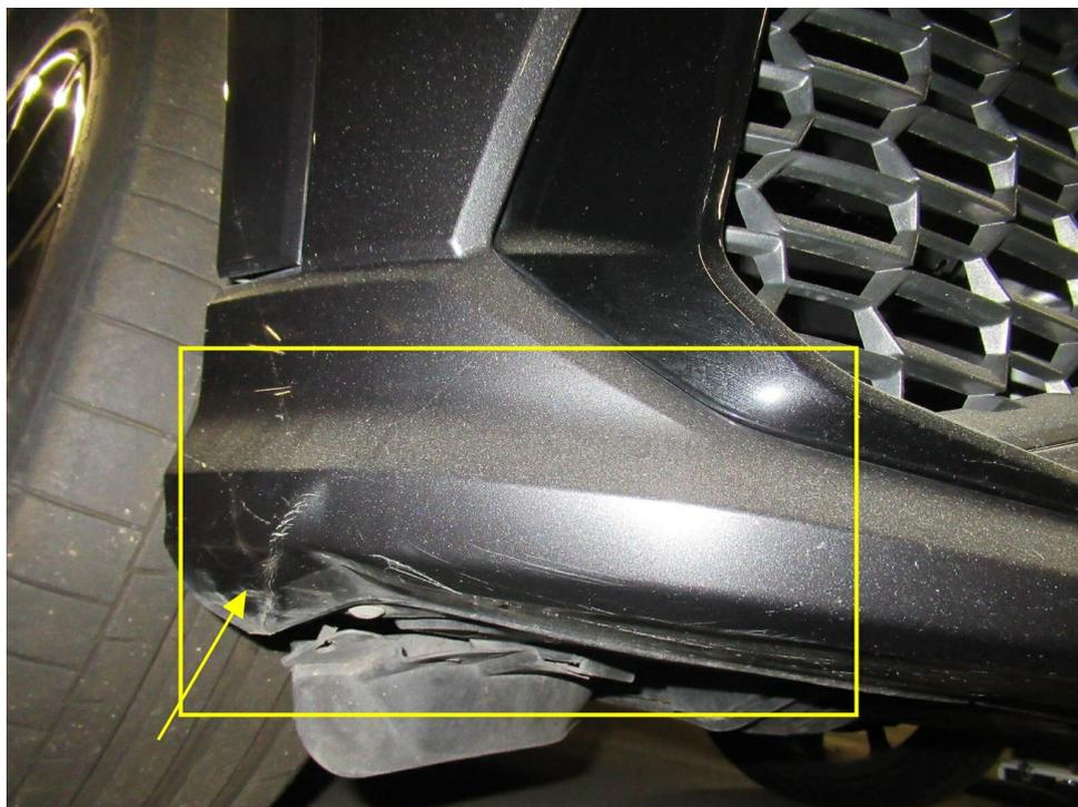
Bild 12 : Stoßfängerverkleidung vorne rechts eingedrückt
