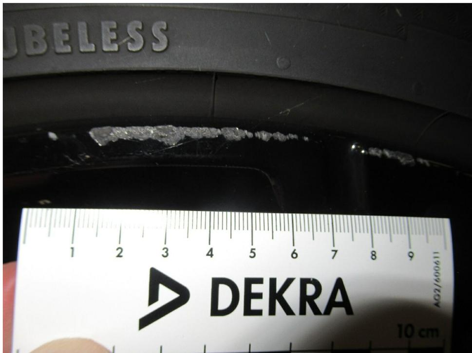
Bild 15 : Felge hinten rechts, zerkratzt, smart repair
