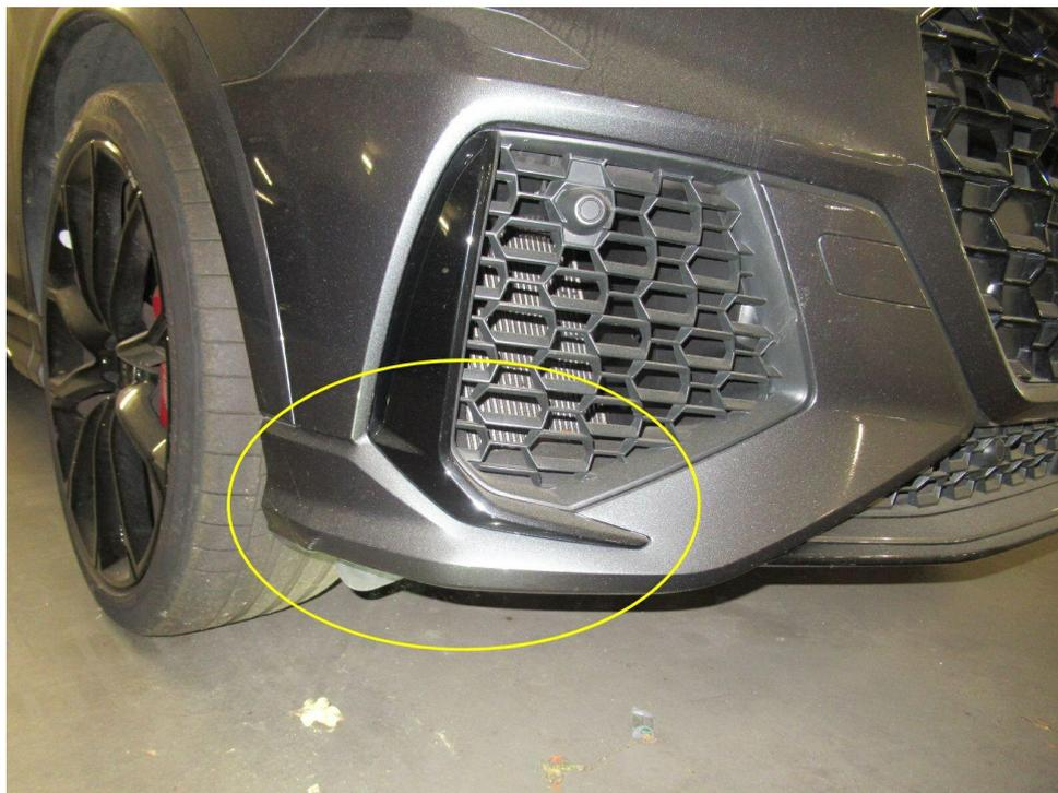
Bild 11 : Stoßfängerverkleidung vorne rechts eingedrückt
