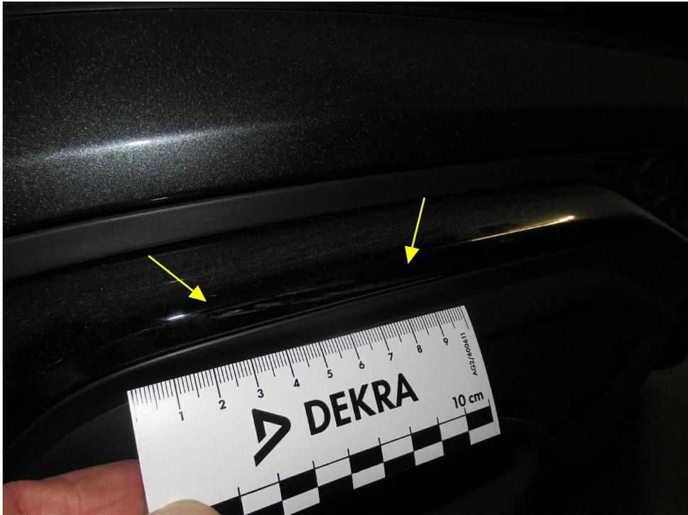
Bild 19 : Stoßfängerverkleidung hinten, Blende verkratzt
