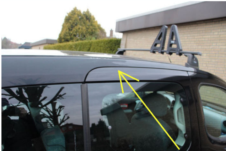
Bild 11 Lackschaden Dach re.
