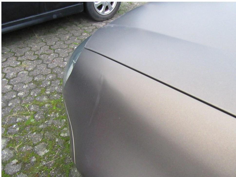
Bild 8 : Kotflügel eingedrückt
