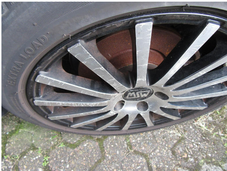
Bild 8 : Räder Lackierung beschädigt
