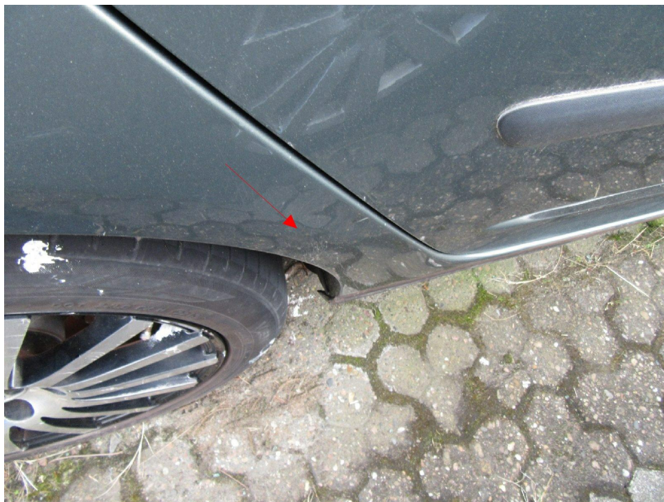
Bild 7 : Seitenwand rechts eingedellt
