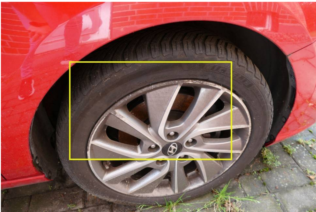
Felgen teilweise korrodiert
