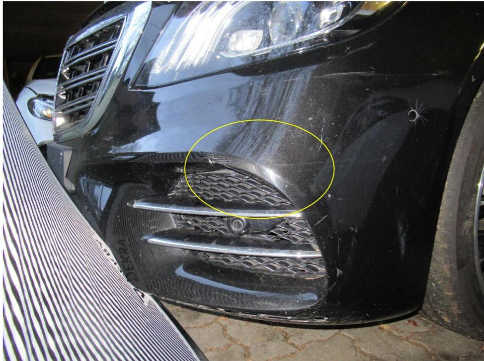
Bild 13 : Stoßfängerverkleidung vorn gebrochen
