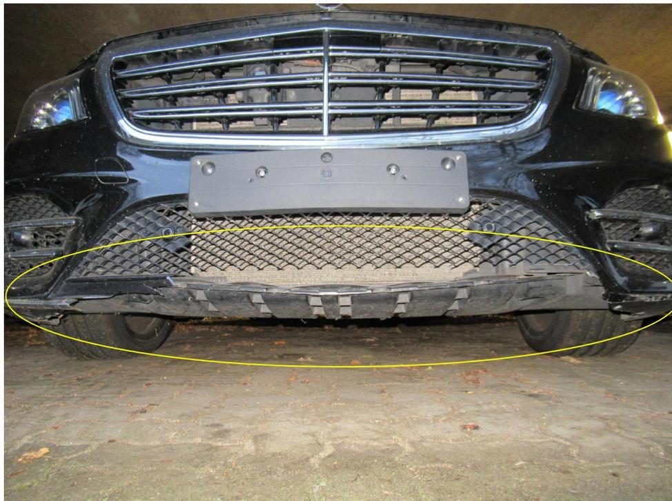
Bild 14 : Stoßfängerverkleidung vorn gebrochen
