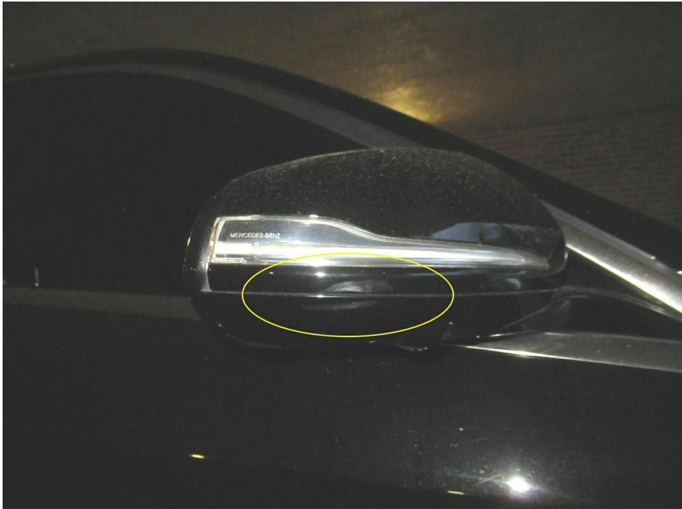
Bild 11 : Spiegelkappe rechts verschrammt
