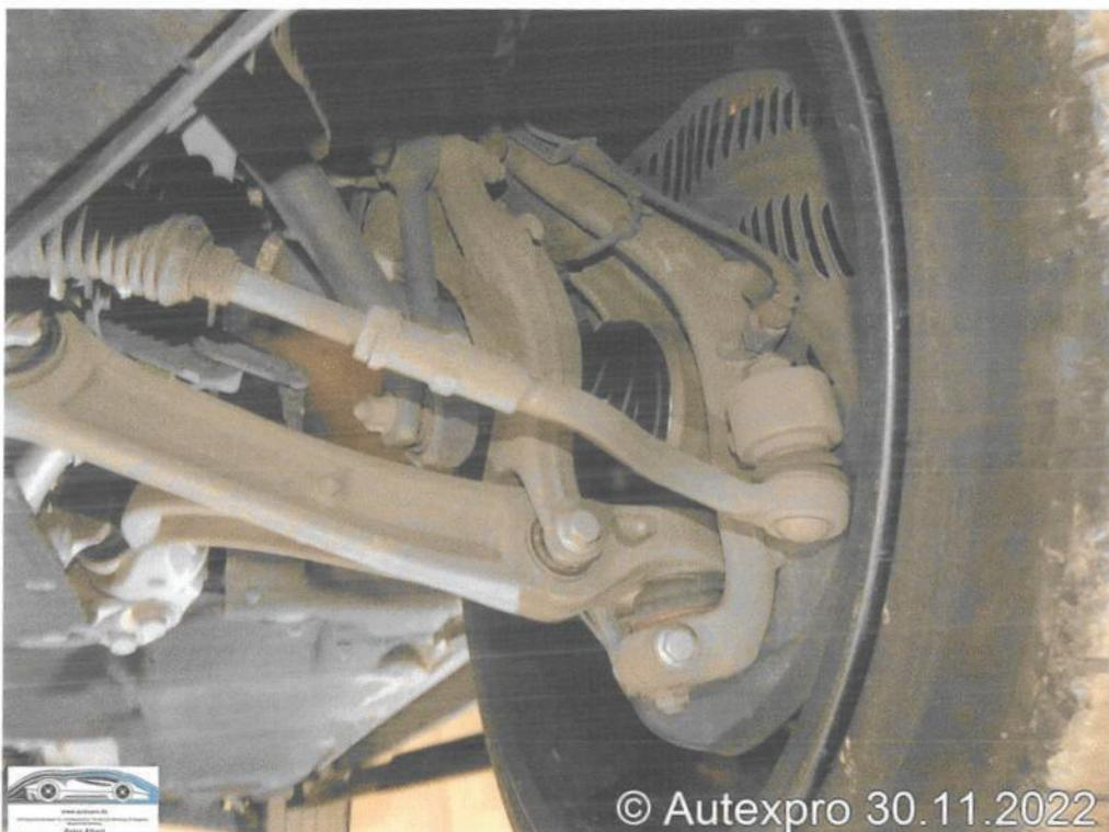
Foto 40: Radaufhängung/Achshälfte vorn links
