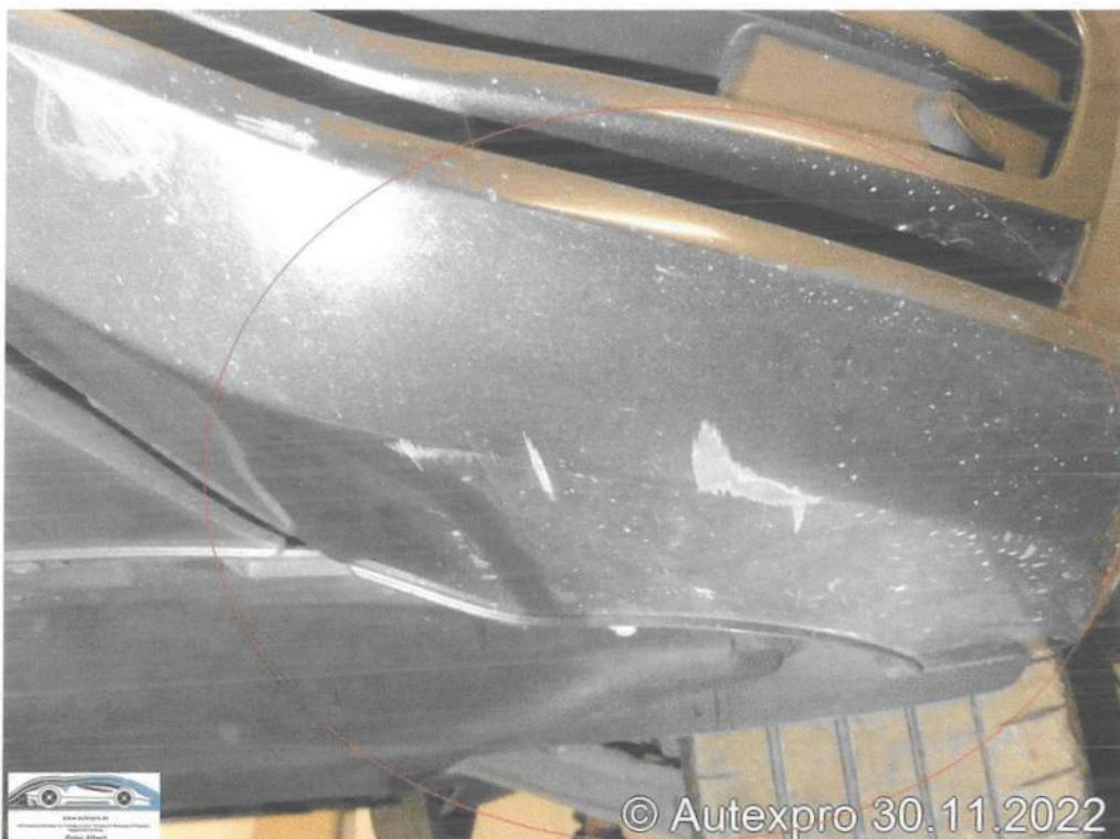
Foto 46: Anstoßkratzer Frontverkleidung/Spoiler vorn links unten
