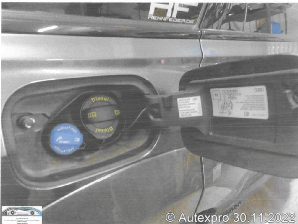
Foto 36: Tankklappe mit Einfüllstutzen Dieselmotorkraftstoff und Adblue
