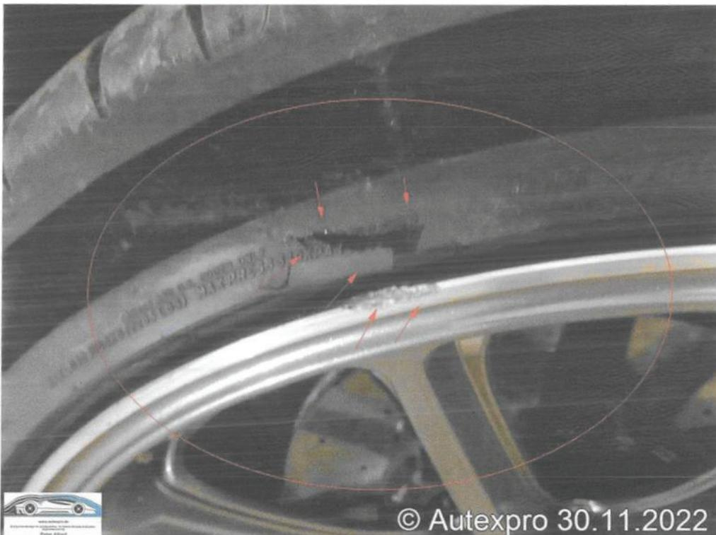
Foto 50: Anstoßkratzer mit Kerbungen an allen vier Radfelgen im Bereich Felgenhorn 1x wie hier angez. mit Einbezug Beschädigung an der Radreifenwand
