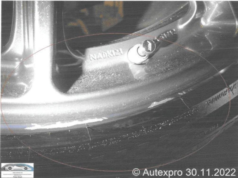
Foto 49: Anstoßkratzer mit Kerbungen an allen vier Radfelgen im Bereich Felgenhorn
