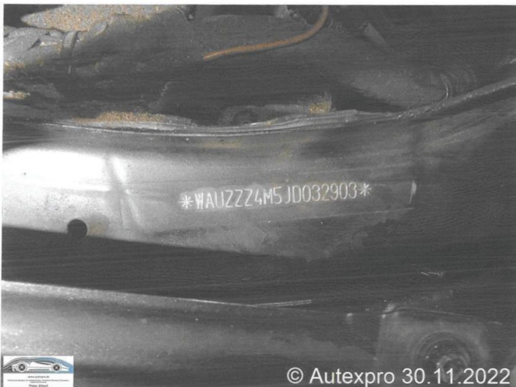
Foto 11: Herstellereinschlag der Fahrgestellnummer im Motorraum am rechten oberen Längsträger angebracht
