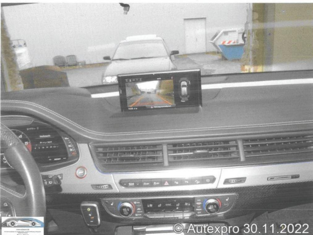
Foto 16: Schalttafel hier bei ausgefahrenen Bildschirm der Multi Media Einheit aktivierter Rückfahrkamera
