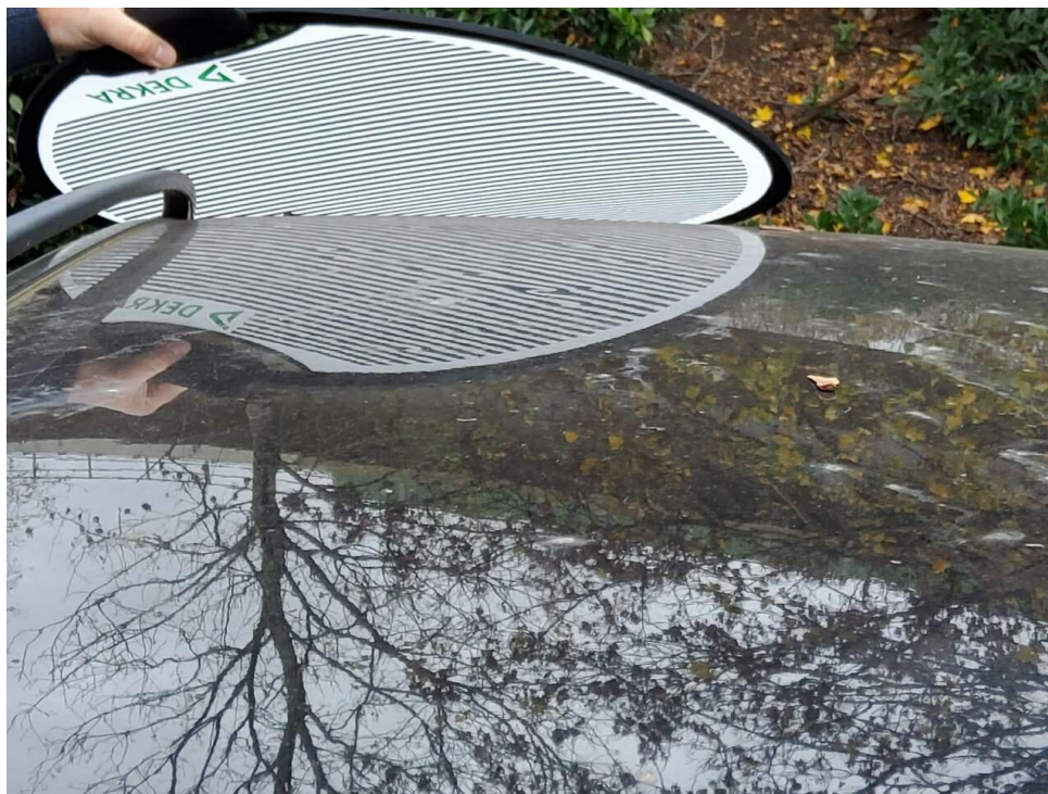
Bild 22 : Dach, eingedellt, drücken
