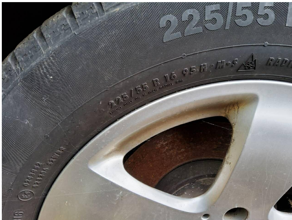
Bild 16 : Bremscheiben Vorderrachse angerostet
