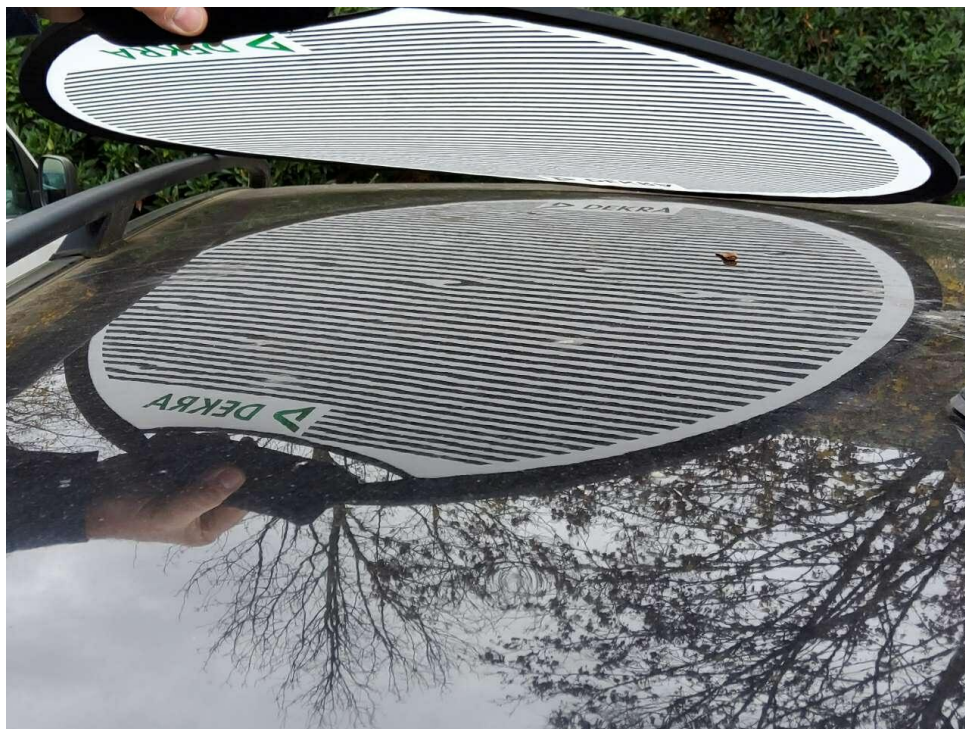
Bild 23 : Dach, eingedellt, drücken
