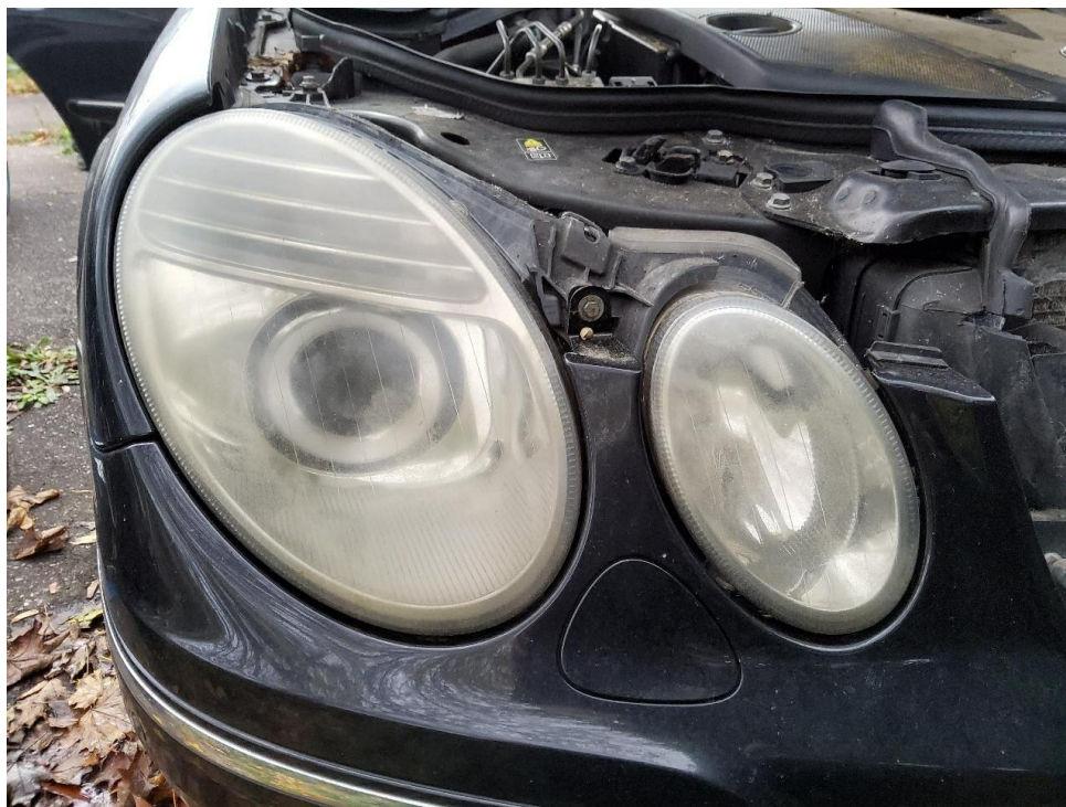
Bild 14 : Hauptscheinwerfer rechts Streuscheibe verbleicht
