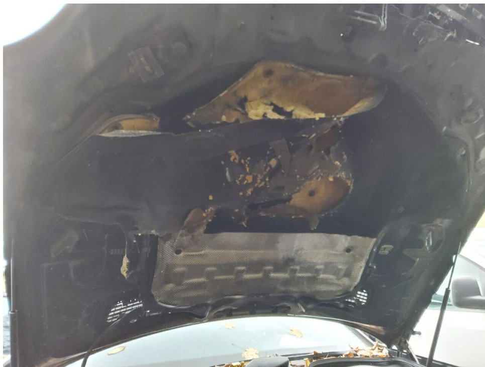
Bild 12 : Dämmatte Motorhaube Tierverschädigung
