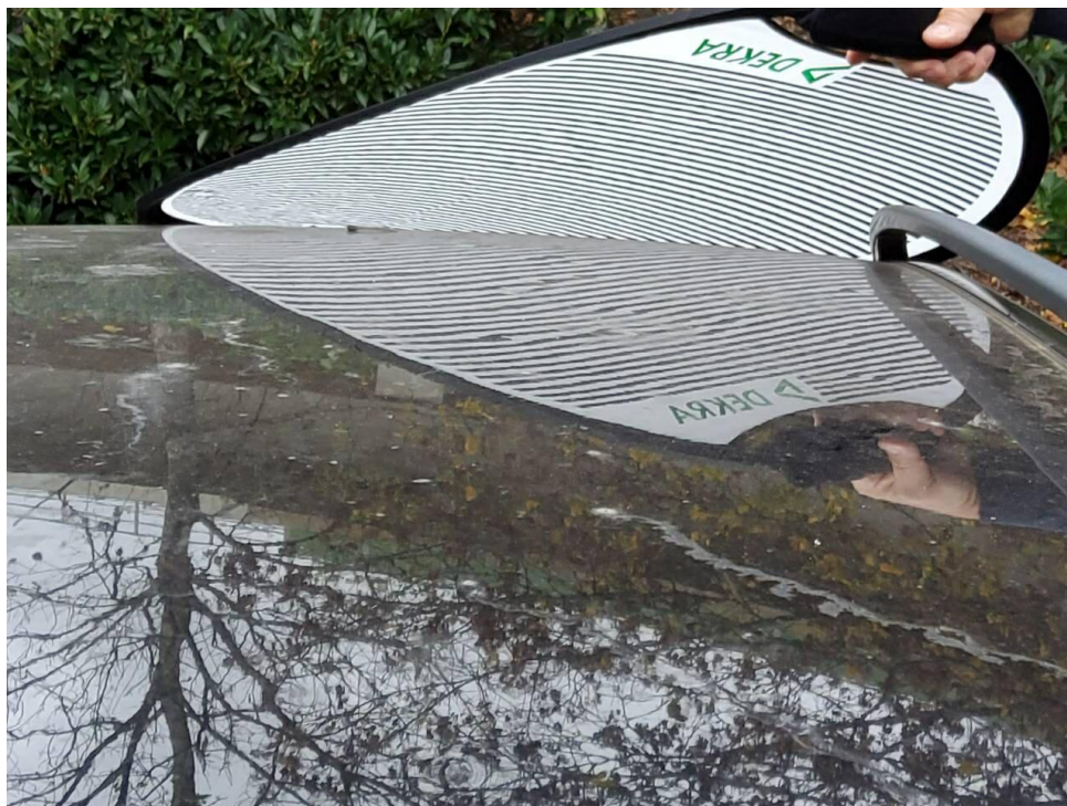
Bild 25 : Dach, eingedellt, drücken
