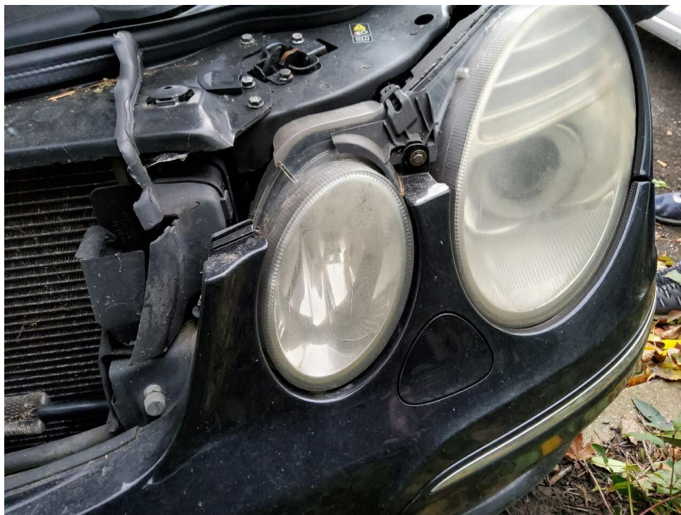
Bild 15 : Hauptscheinwerfer links Streuscheibe verbleicht
