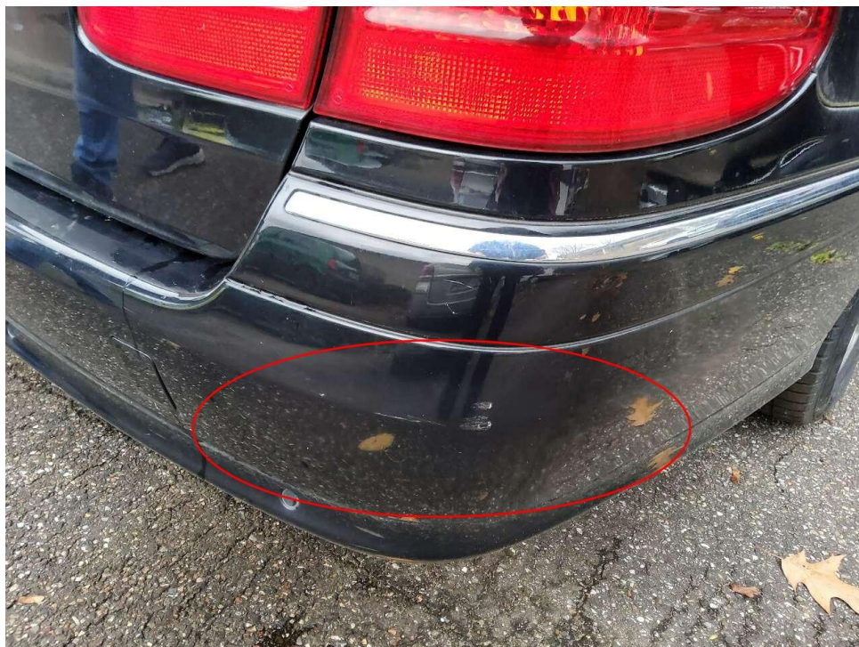
Bild 18 : Stoßfänger hinten Lackierung, zerkratzt, lackieren mit Lackaufbau
