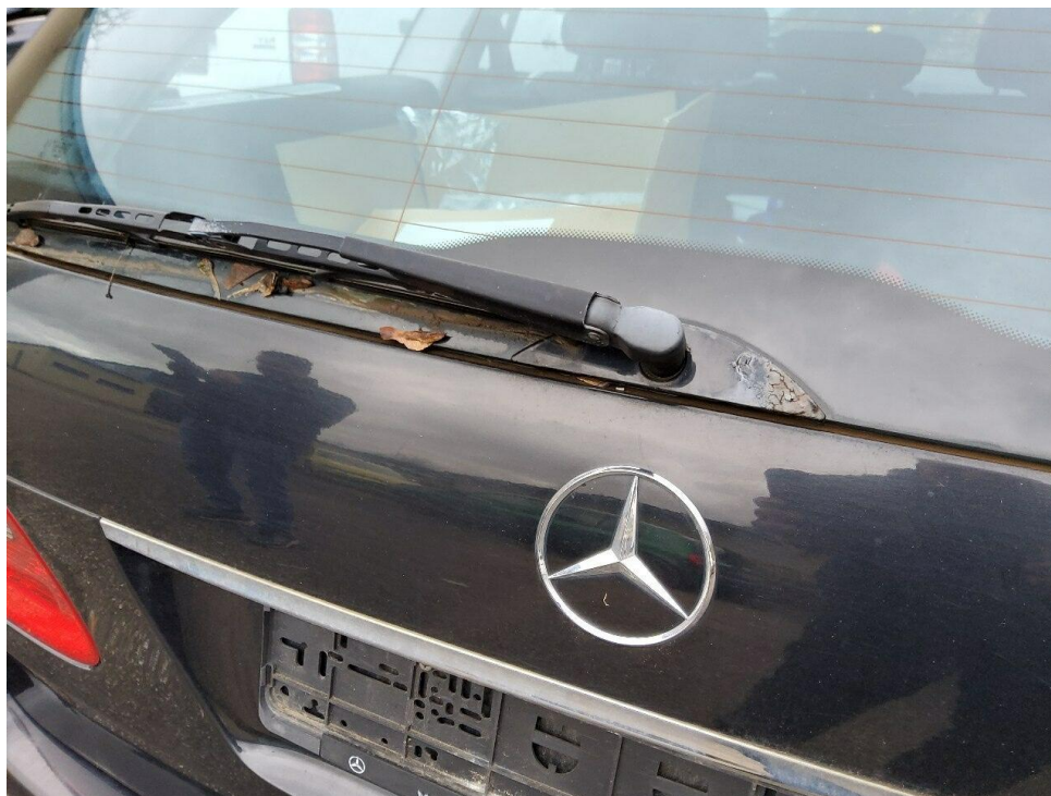
Bild 20 : Heckscheibenwischermotor Blende angerostet
