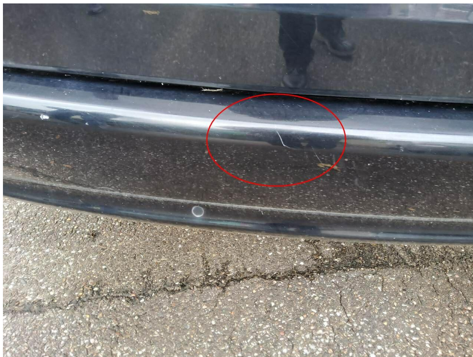
Bild 19 : Stoßfänger hinten Lackierung, zerkratzt, lackieren mit Lackaufbau
