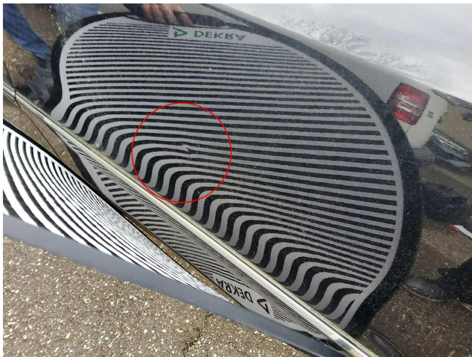
Bild 27 : Tür hinten links, eingedellt, drücken
