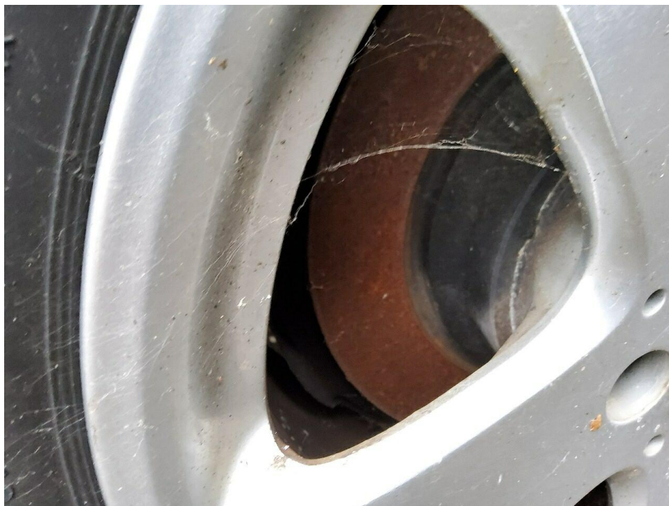
Bild 17 : Bremsscheiben Hinterachse angerostet
