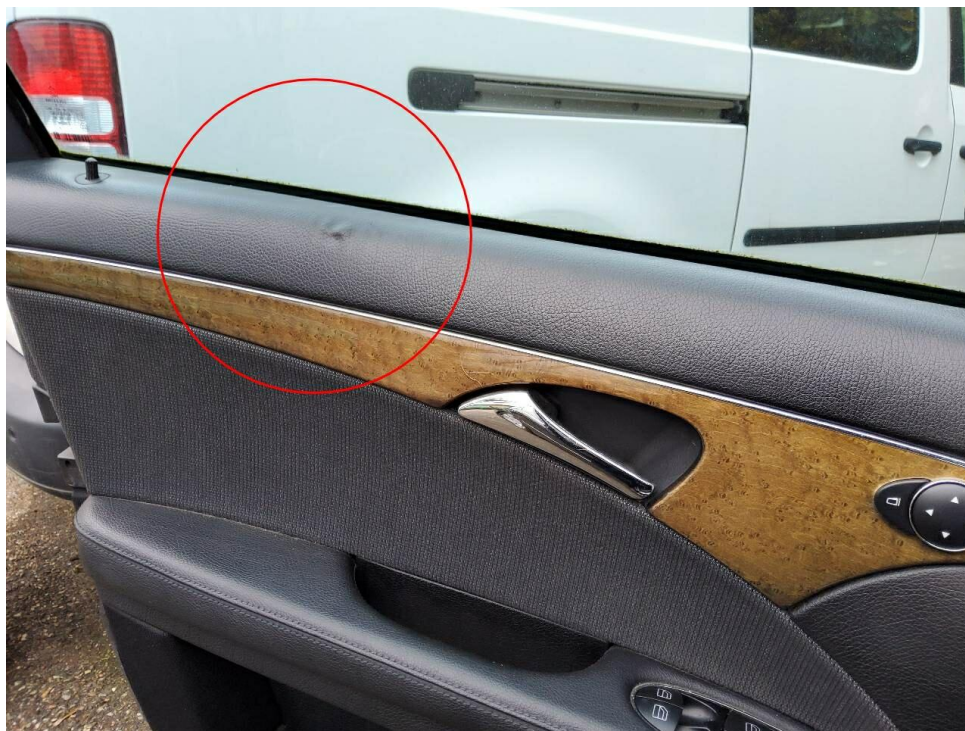
Bild 28 : Seitenverkleidung vorne links, eingedrückt ,Minderwert
