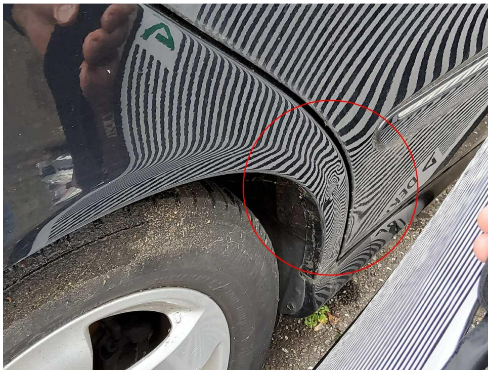
Bild 26 : Seitenteil hinten rechts, eingedellt, drücken
