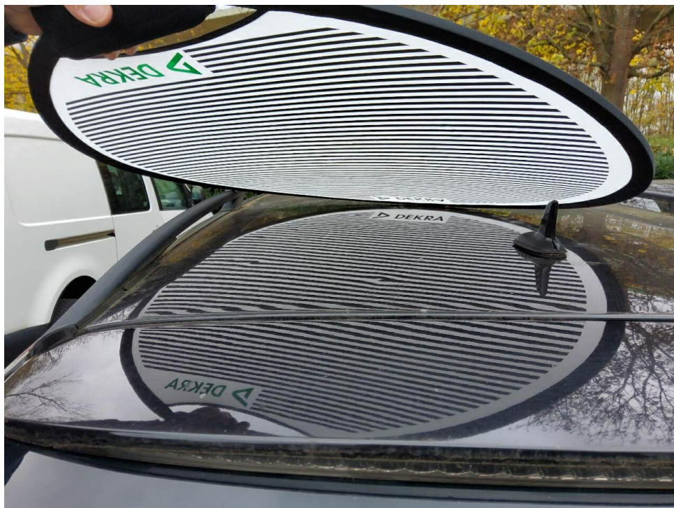
Bild 24 : Dach, eingedellt, drücken
