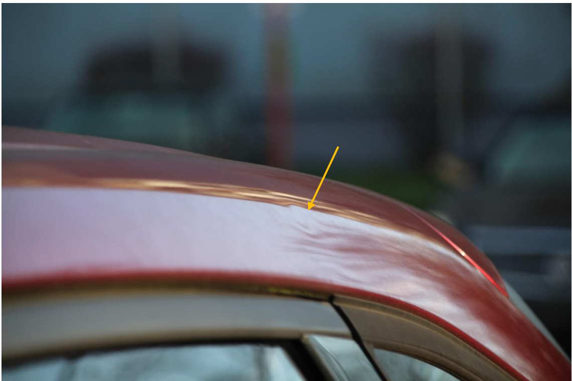
Seitenwand rechts Parkdelle mit Lackschaden, Dachrandzone beidseits Dellen.
