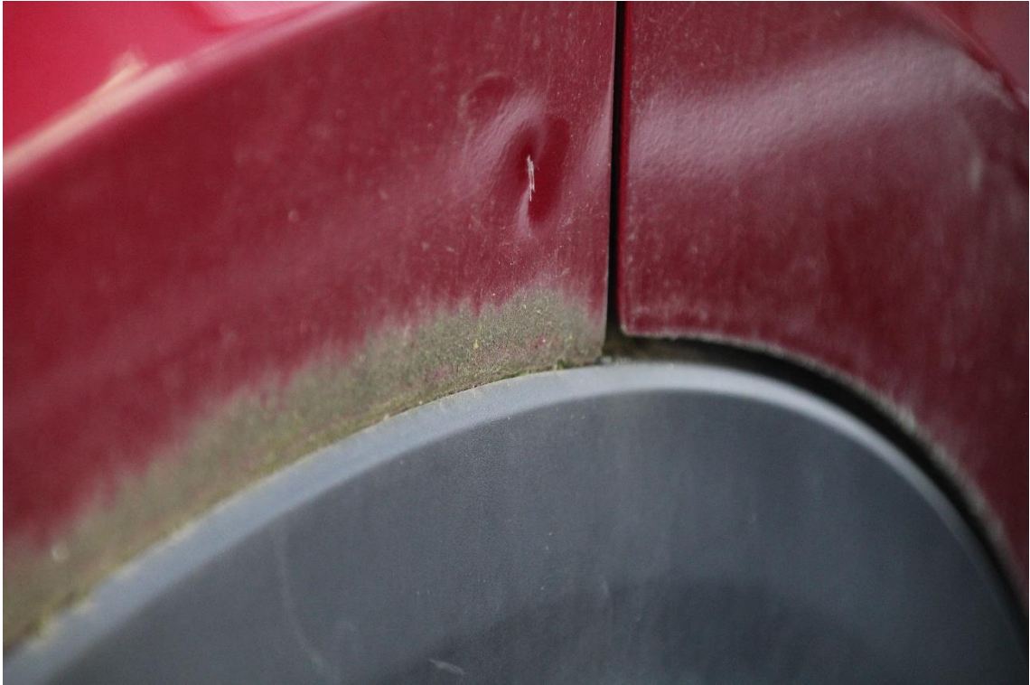
Seitenwand rechts Parkdelle mit Lackschaden, Dachrandzone beidseits Dellen.
