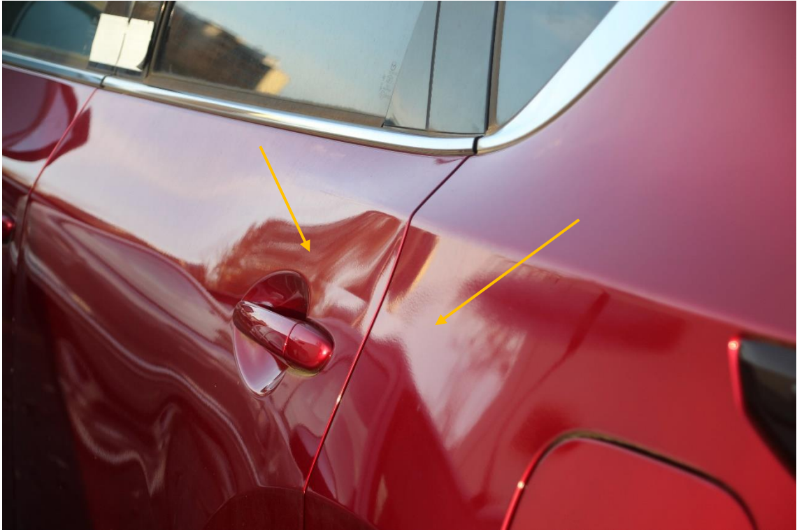
Tür hinten links oben und unten eingedrückt, Seitenwand links leicht eingedrückt.
