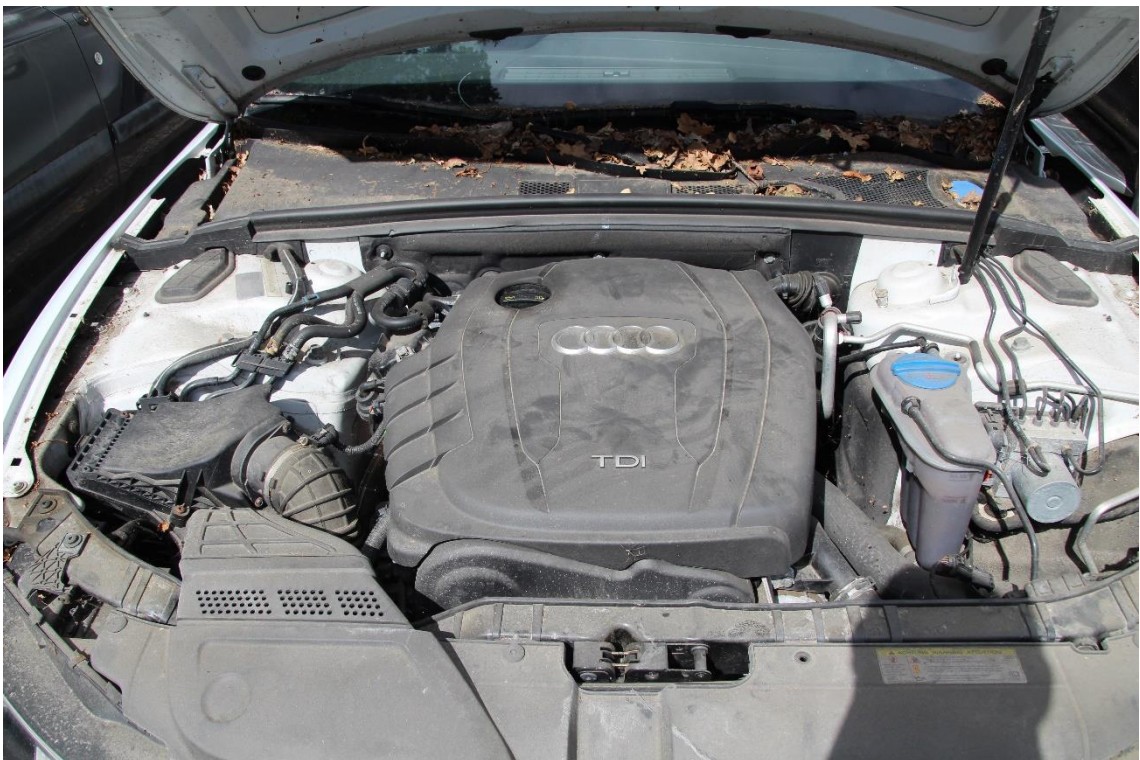
Übersicht Motorraum. Vorratsbehälter deutet auf Kühlmittelverlust.
