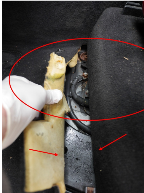
Bild 25 - Korrosionsschäden, Fahrgastraum undicht
