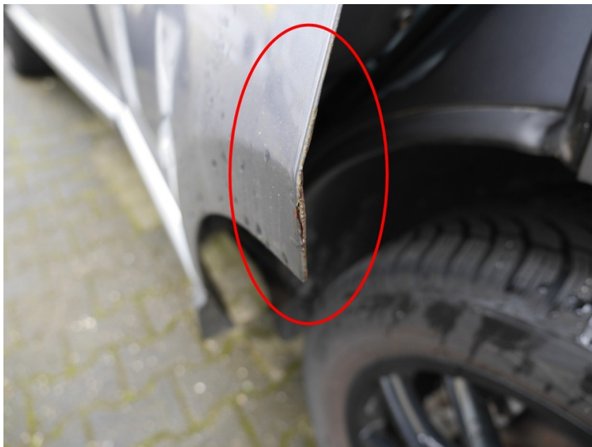
Bild 24 - Korrosionsschaden Hintertür links
