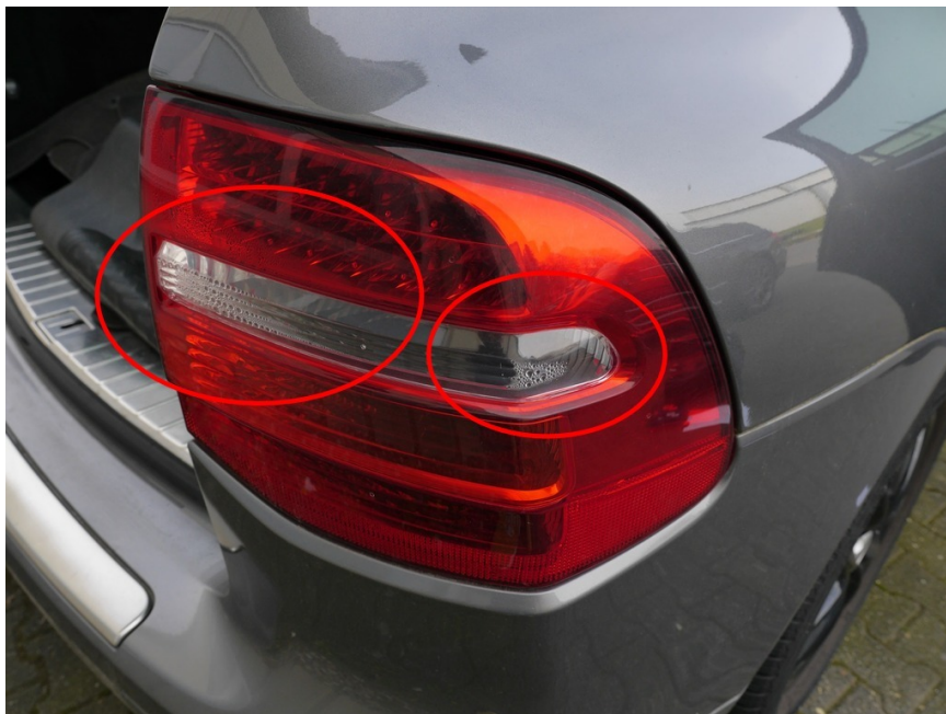
Bild 32 - Rückleuchte rechts undicht
