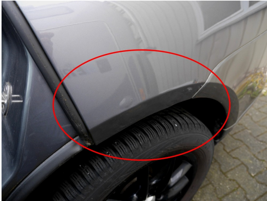
Bild 23 - Korrosionsschaden Radlauf hinten links
