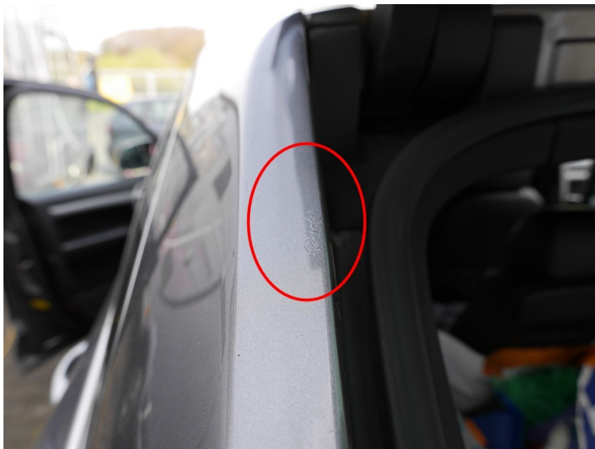
Bild 28 - Korrosionsschaden, Seitenwand hinten links
