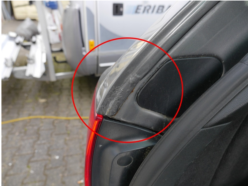
Bild 27 - Korrosionsschaden, Seitenwand hinten links
