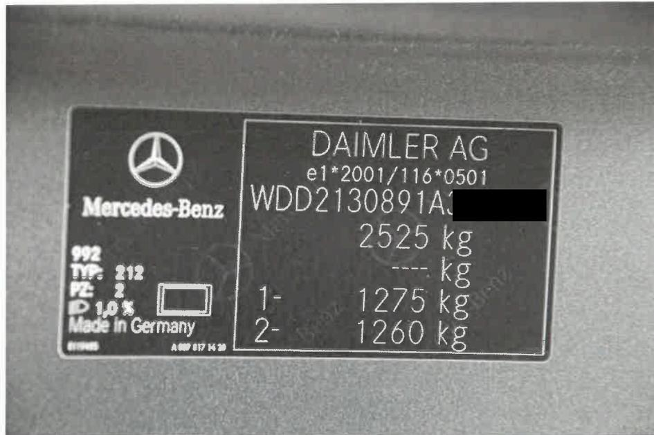
Bild 12 Typschild/Identifikation.
