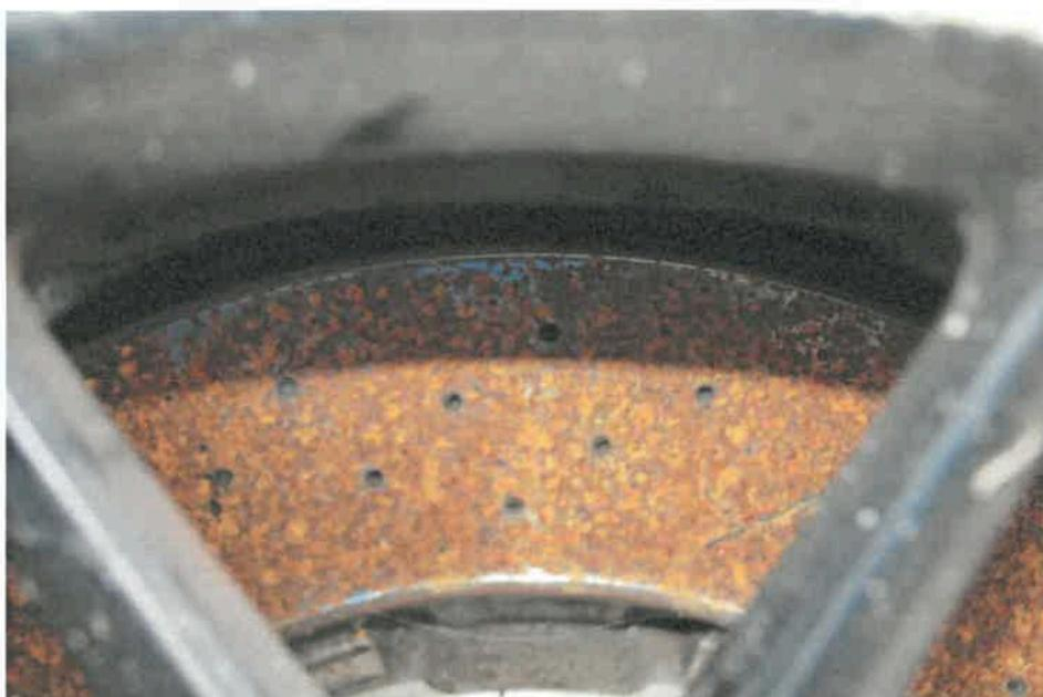
Bild 11 Bremsscheiben rundum korrodiert.
