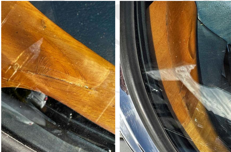
Armaturenbrett Holzvertäfelung beschädigt
