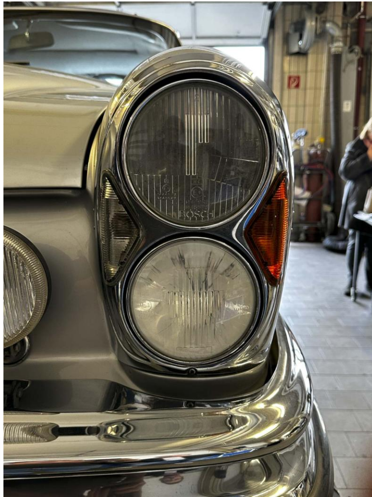
Scheinwerfer / Blinker links Nebellampe Unterer Reflektor / Glas beschlagen
