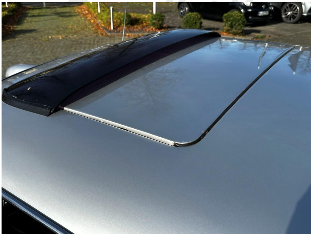
Schiebe-Dach Deckel sitzt nicht akurat.
