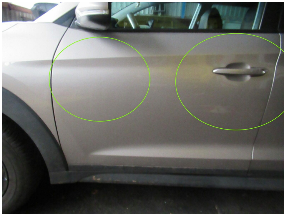
Bild 8 : Fahrertür mehrfach eingedellt
