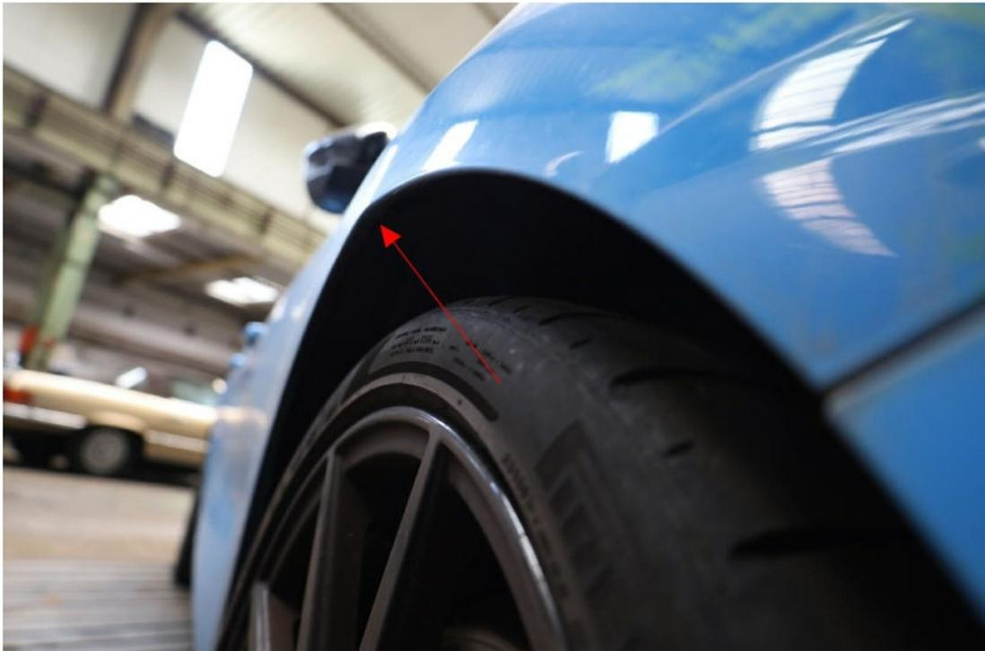
Bild 11 : Knick im Kotflügel
