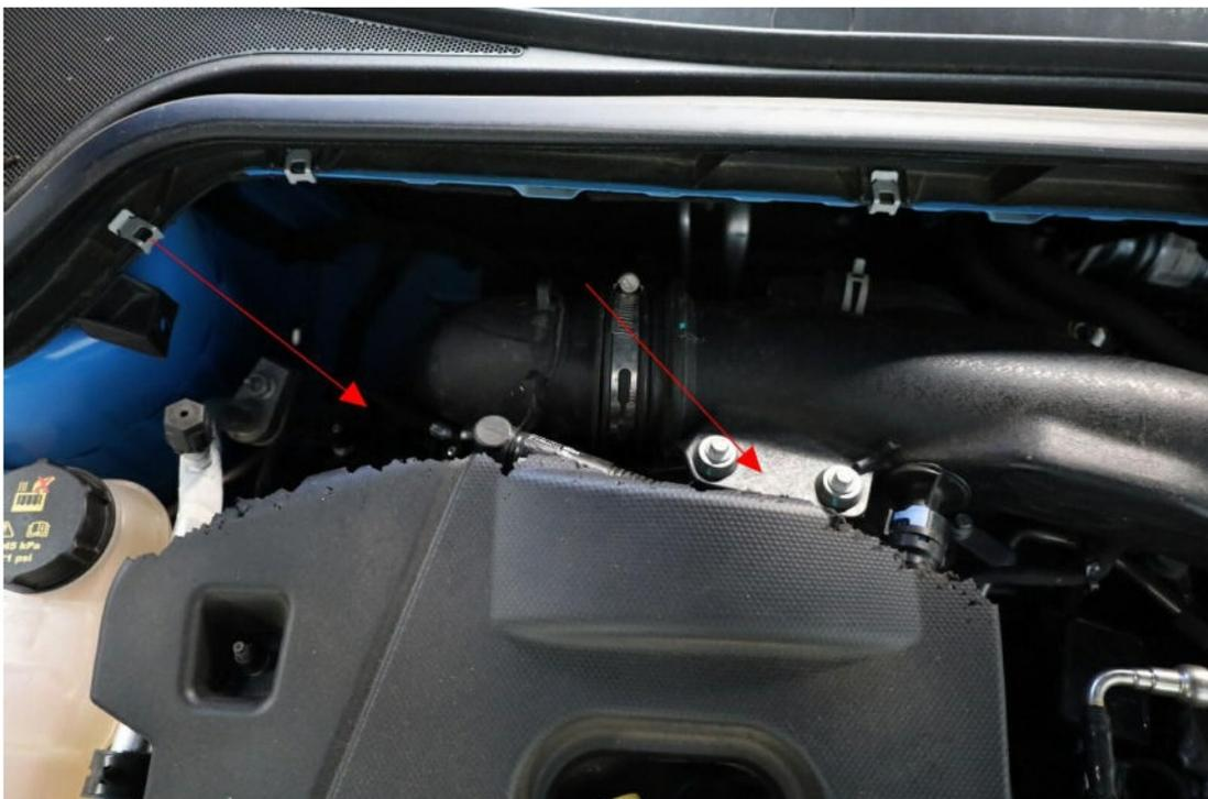
Bild 12 : Motorabdeckung durch Tierbiss beschädigt.
