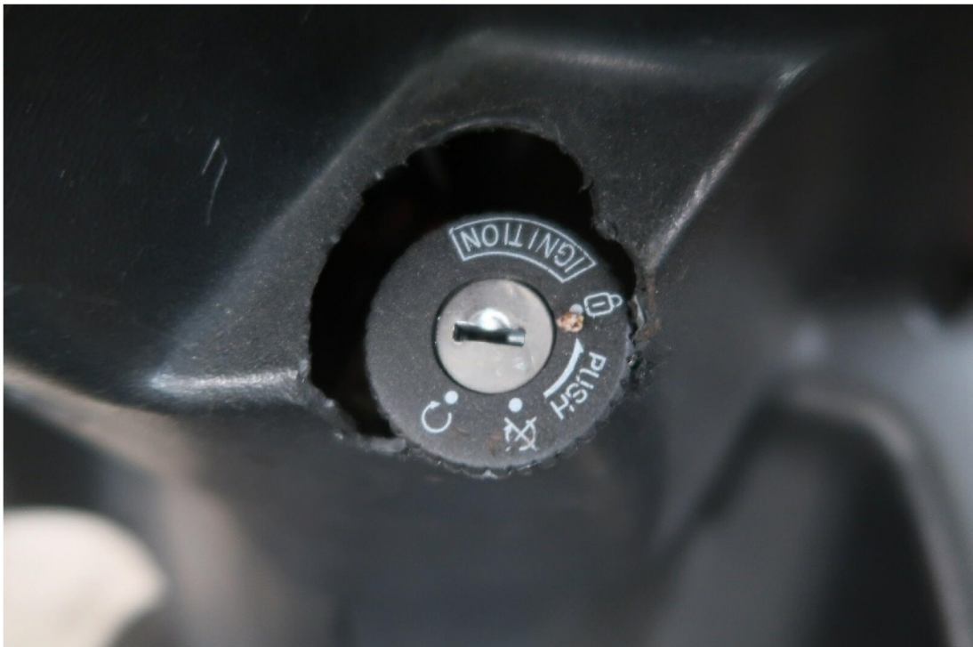
Bild 4 : Zünd / Lenkschloss beschädigt
