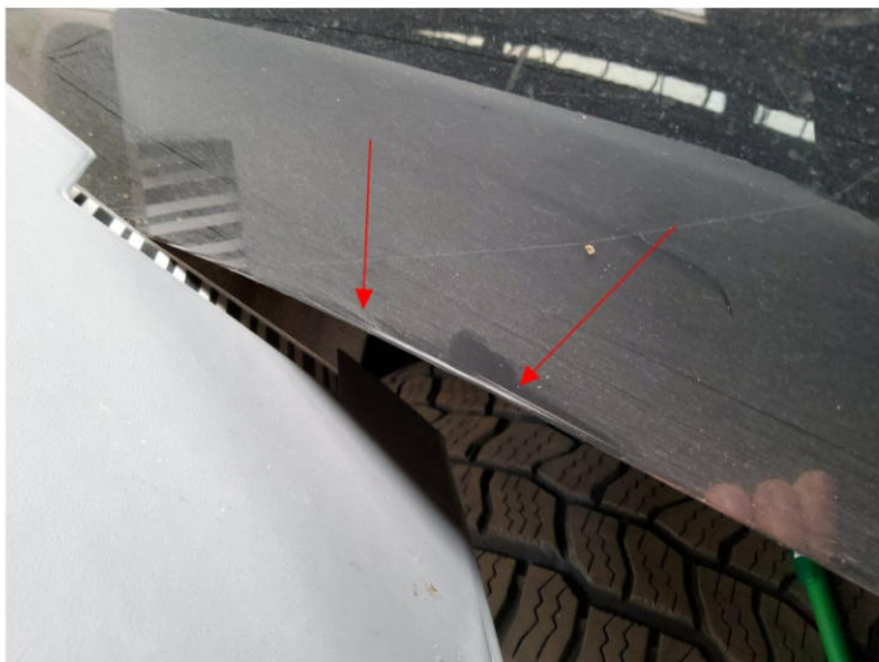
Bild 8 : Seitenwand hinten rechts, Lackierung zerkratzt
