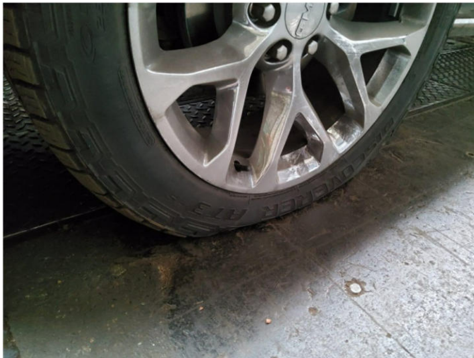
Bild 5 : Räder, Reifen vorne links Druckverlust
