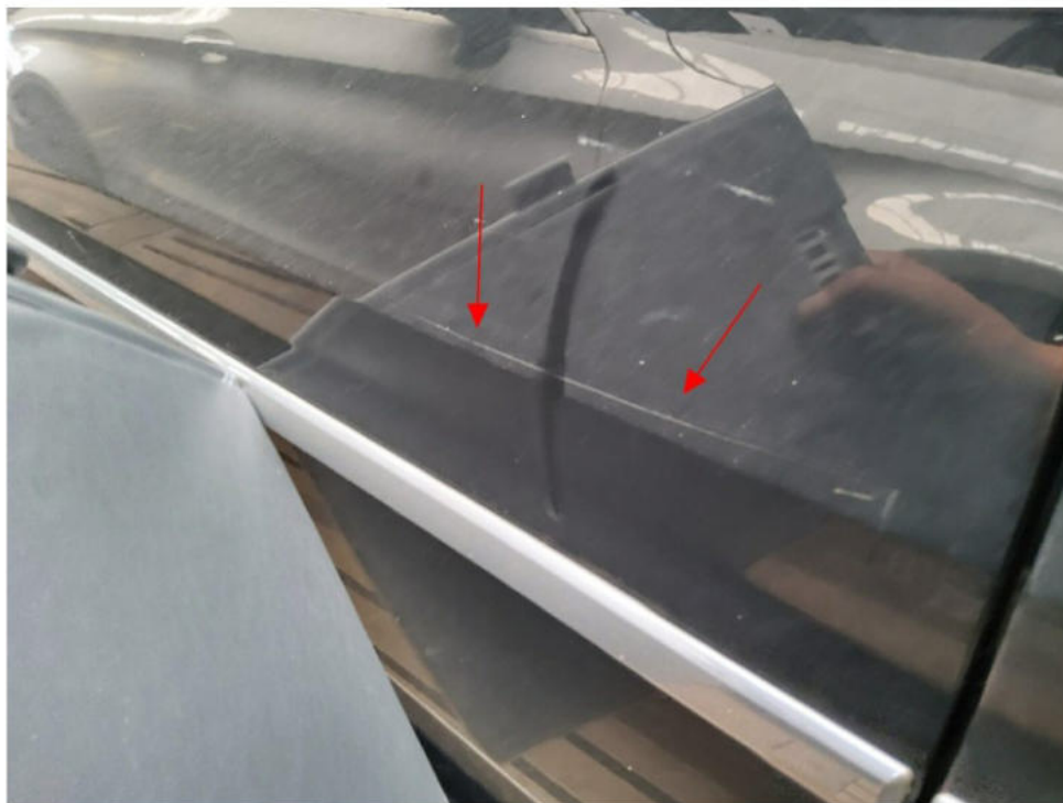
Bild 6 : Tür hinten rechts, Lackierung zerkratzt
