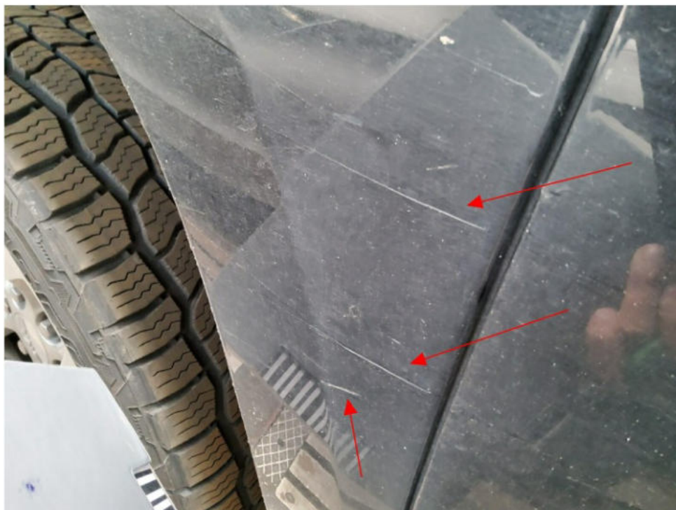
Bild 7 : Seitenwand hinten rechts, Lackierung zerkratzt
