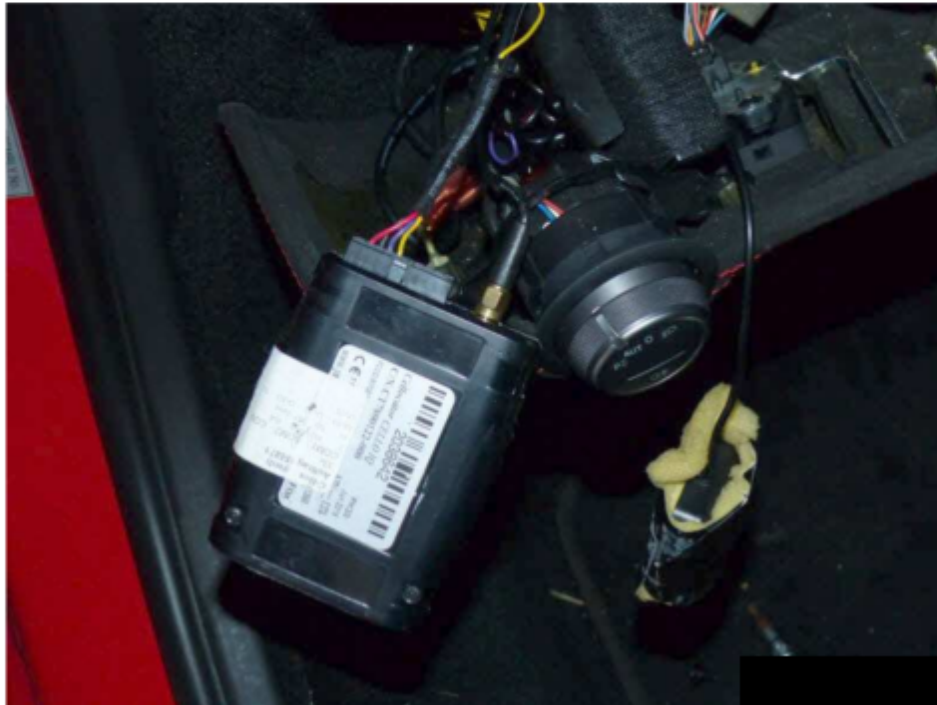
Bild 9 GPS Tracker und - Antenne freigelegt
