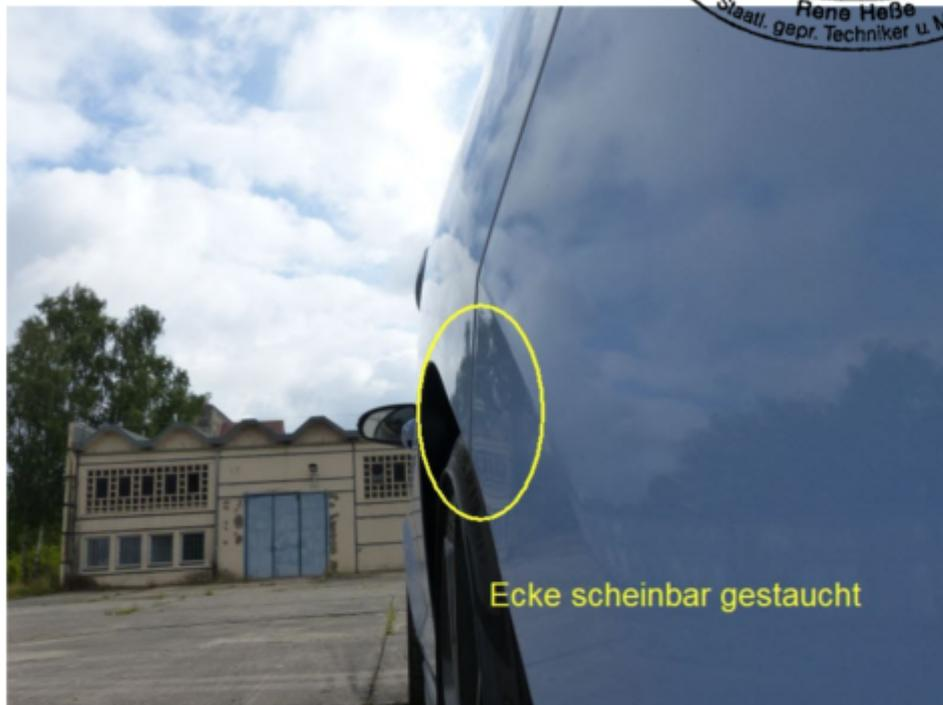
Bild 20 Stoßfänger / Seitenwand hinten links
