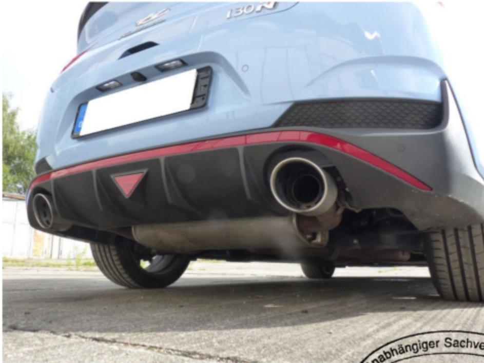
Bild 7 Abgasanlage hinten
