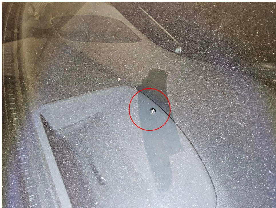
Bild 19 : Windschutzscheibe Steinschlag mit Rissbildung
