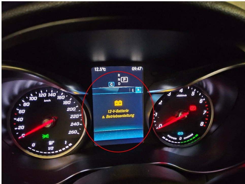
Bild 27 : Fahrzeug Standzeit ca. 2Jahre Batterie entladen (Stand Schäden) zahlreiche Fehlermeldungen aktiv
