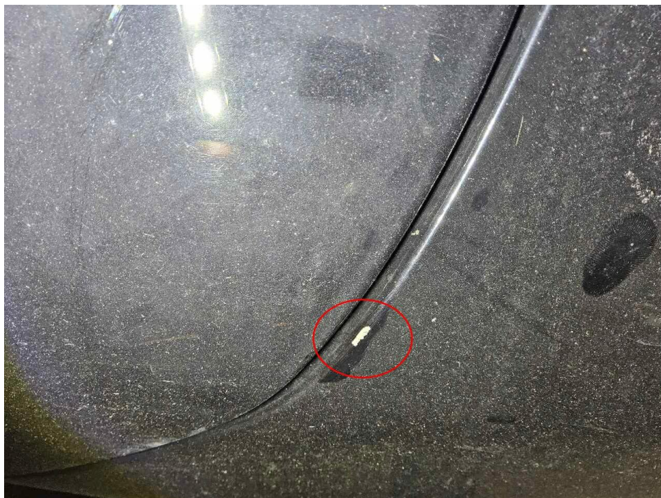
Bild 16 : Seitenwand hinten links verkratzt
