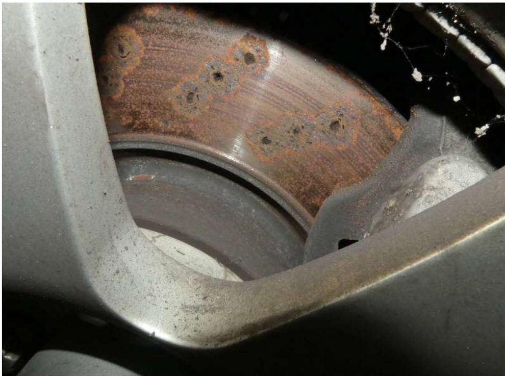
Bild 14 Bremsscheiben Korosion
