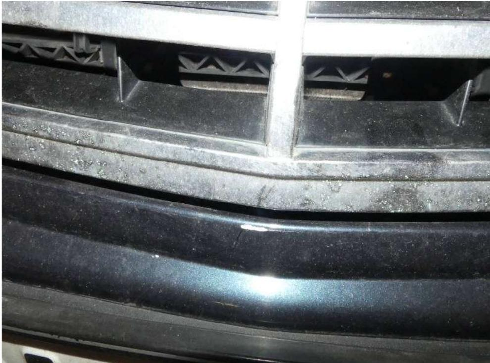
Bild 17 Stoßfänger vorn verkratzt
