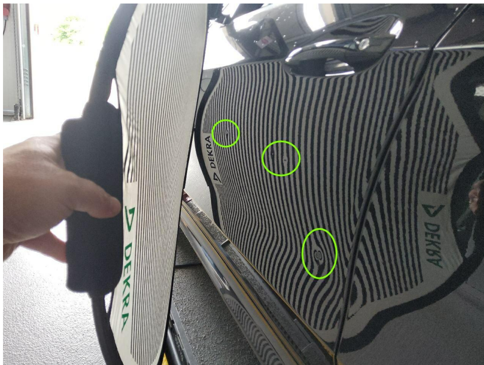
Bild 9 : Tür vorne links mehrfach eingedellt
