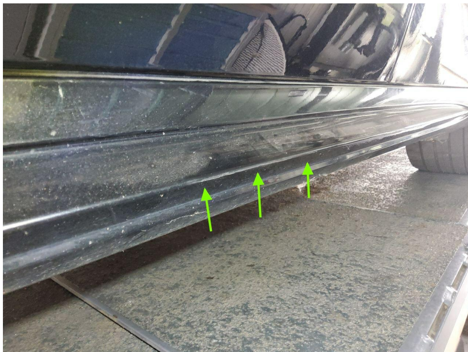
Bild 14 : Schwellerverkleidung links verschrammt
