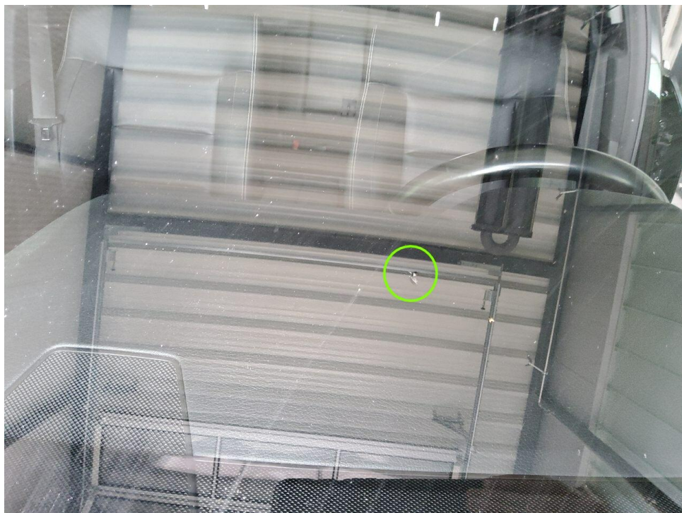
Bild 8 : Windschutzscheibe Steinschlag im Fahrersichtfeld
