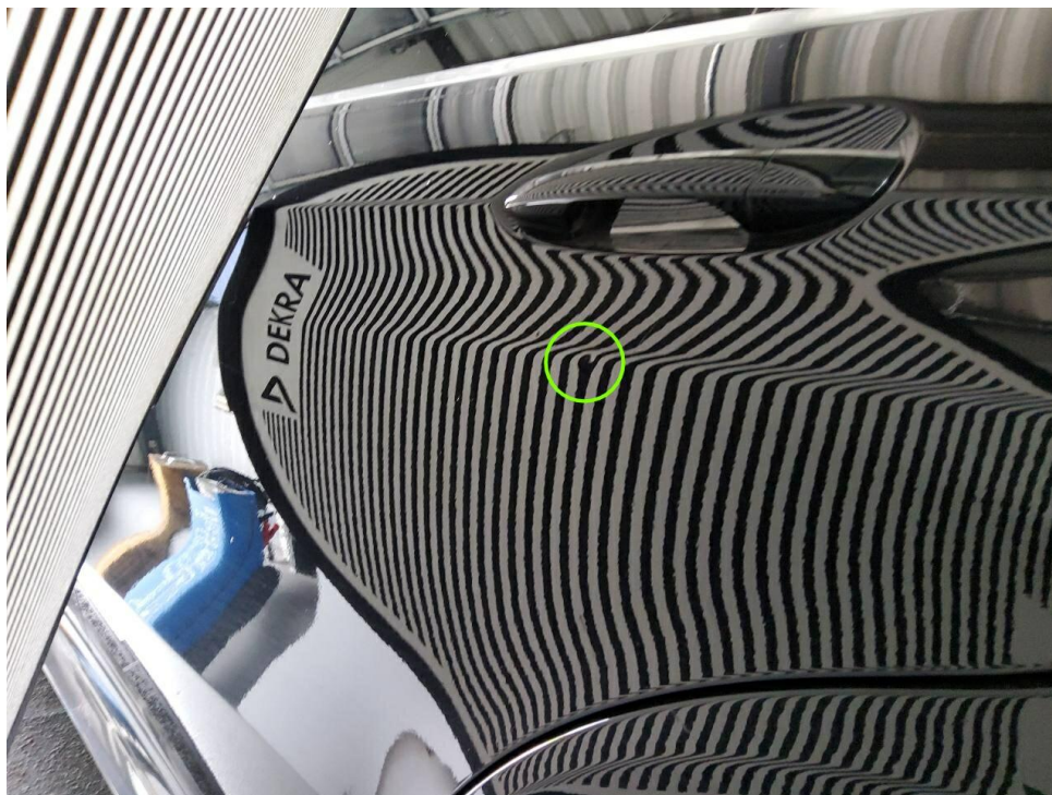
Bild 13 : Tür hinten links eingedellt
