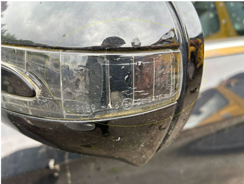
Bild 22 : Blinkleuchte Außenspiegel links, Risse
