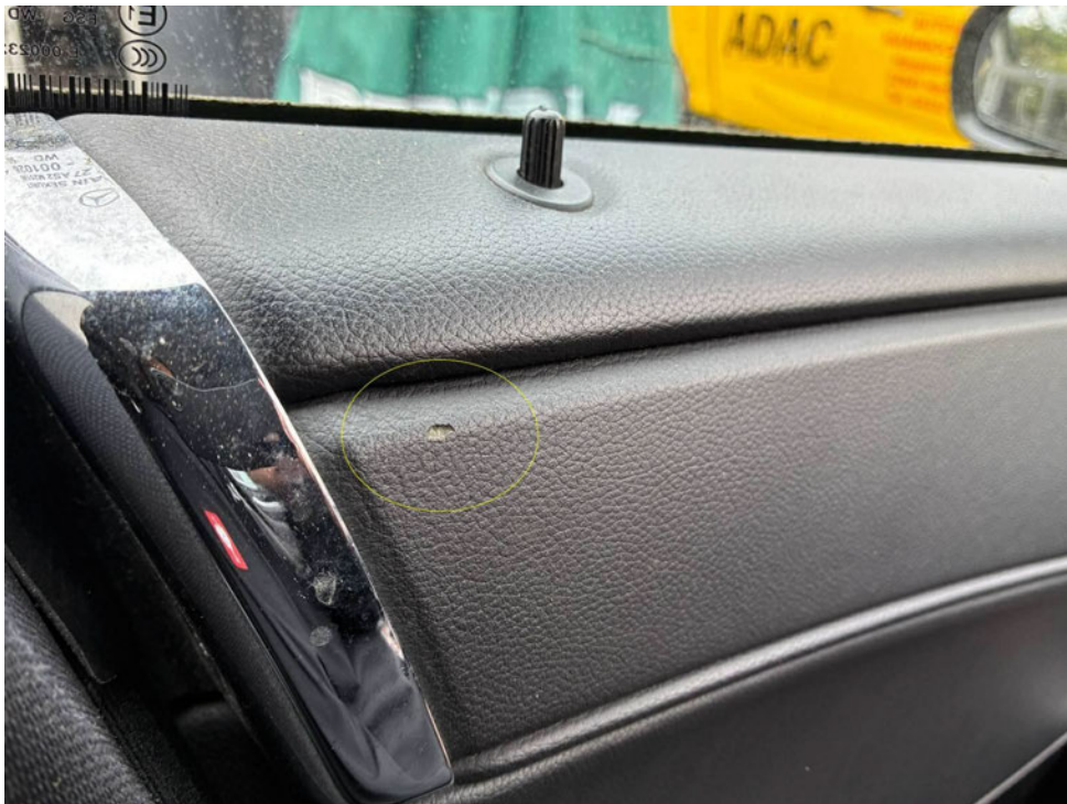
Bild 24 : Verkleidung Tür vorne links, smart repair
