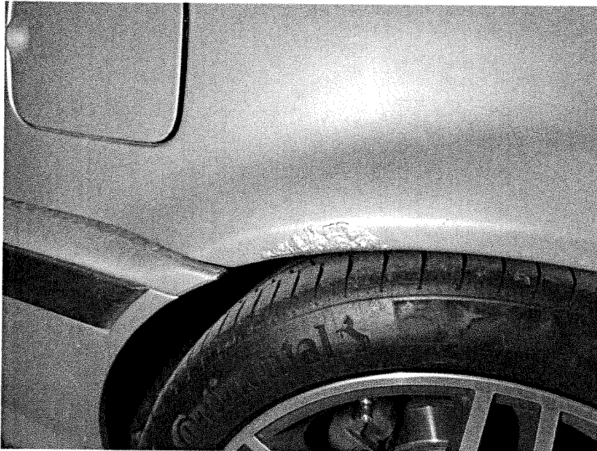
Korrosion Seitenteil hinten rechts
