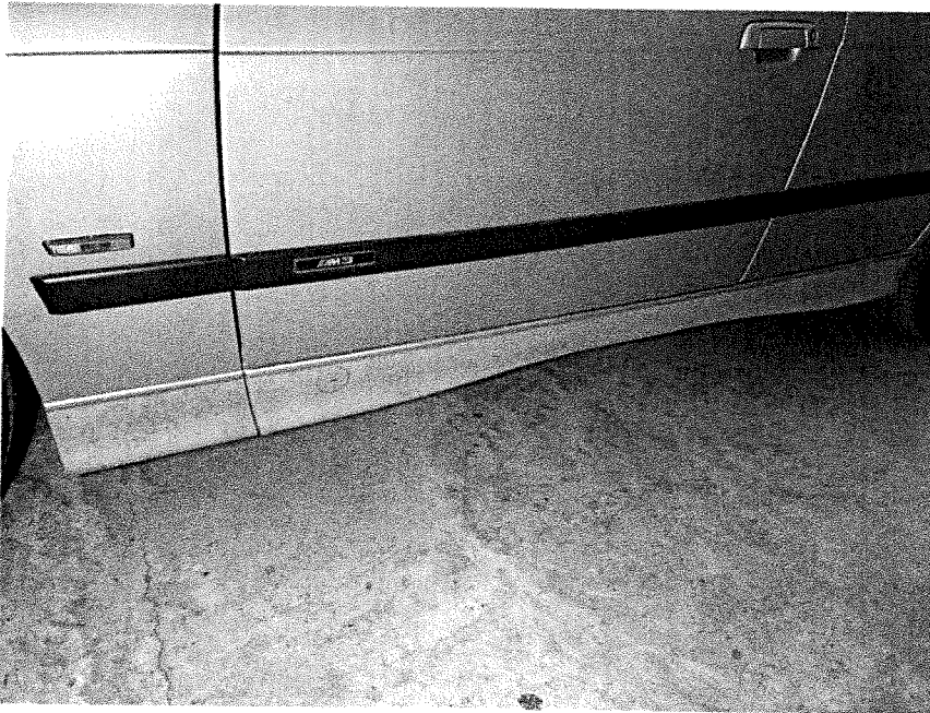
Schwellerbereich links prov. ausgebessert
