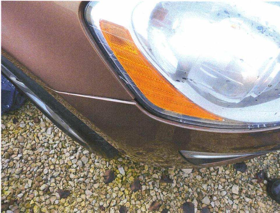
Bild 5 : Stoßfänger vorn Spaltmaß zum Kotflügel aufgeweitet
