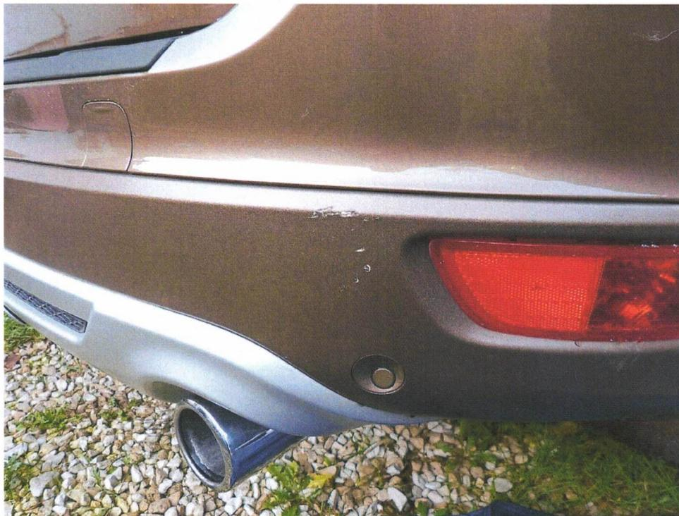
Bild 7 : Stoßfänger hinten rechts verschürft, Lackierung beschädigt
