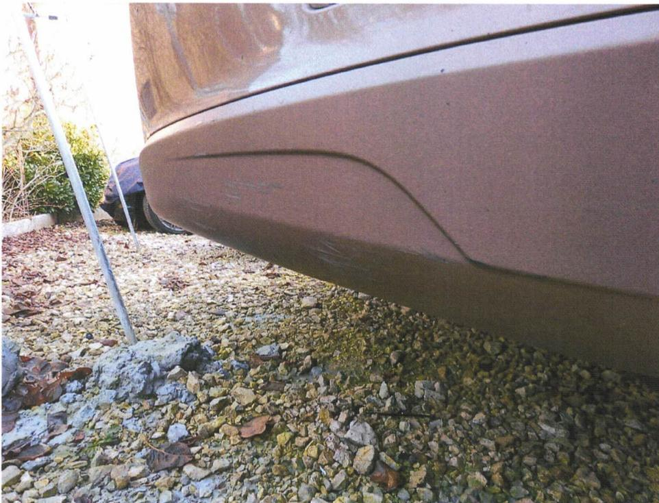
Bild 6 : Stoßfänger vorn rechts unten verschürft und verkratzt
