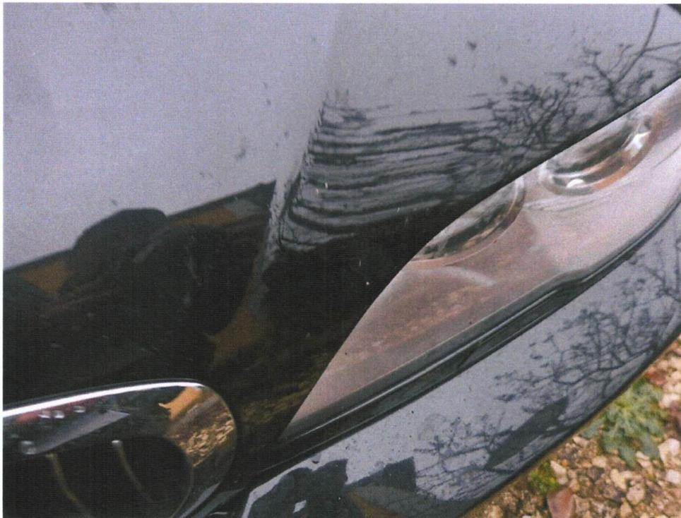
Bild 6 : Frontklappe Steinschläge
