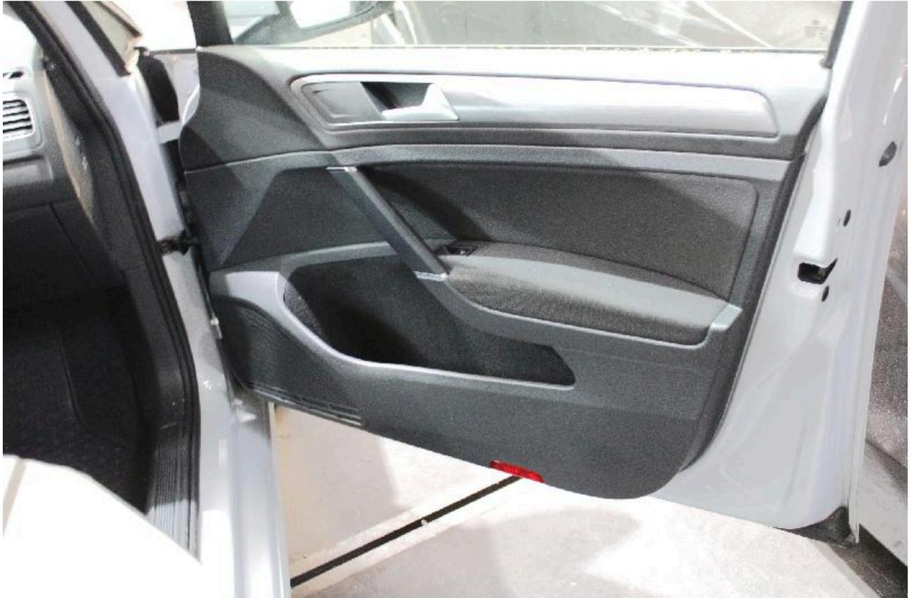
Bild 15: Übersicht Türverkleidung vorn rechts
