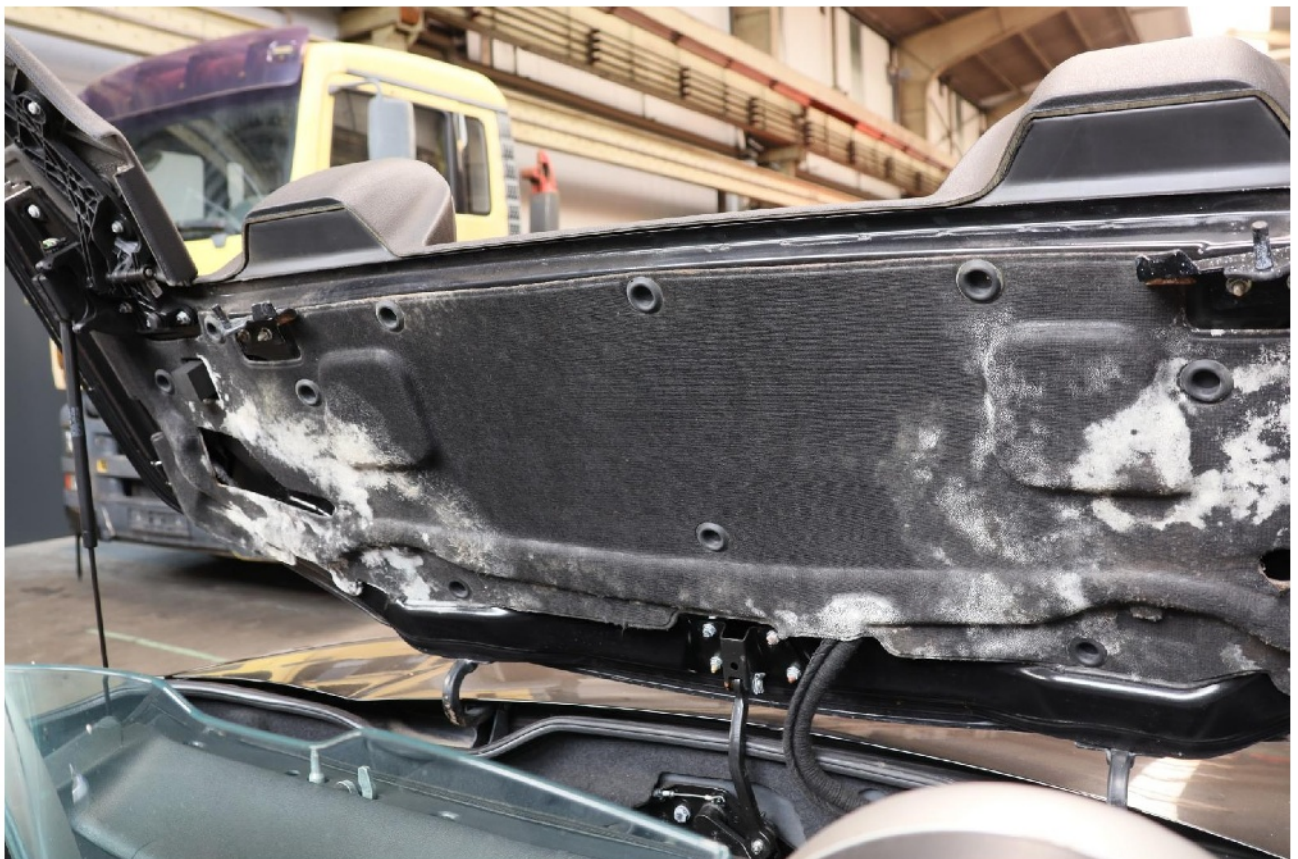
Bild 6: Verkleidung Verdeckkastendeckel mit Schimmelsporen kontaminiert
