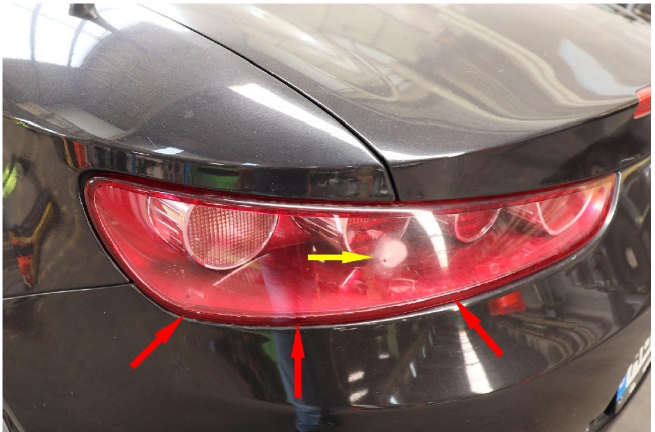
Bild 12: Rückleuchte links porös
