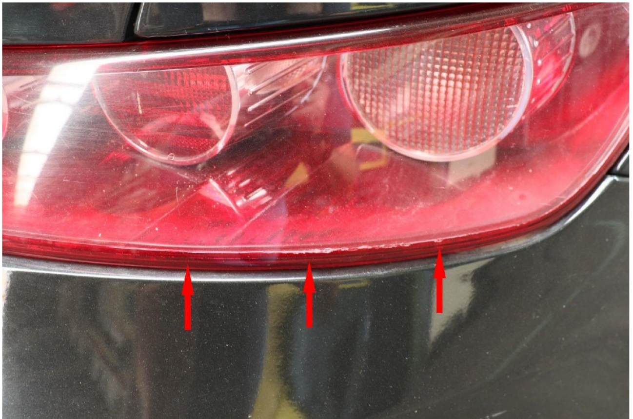
Bild 13: Rückleuchte rechts porös
