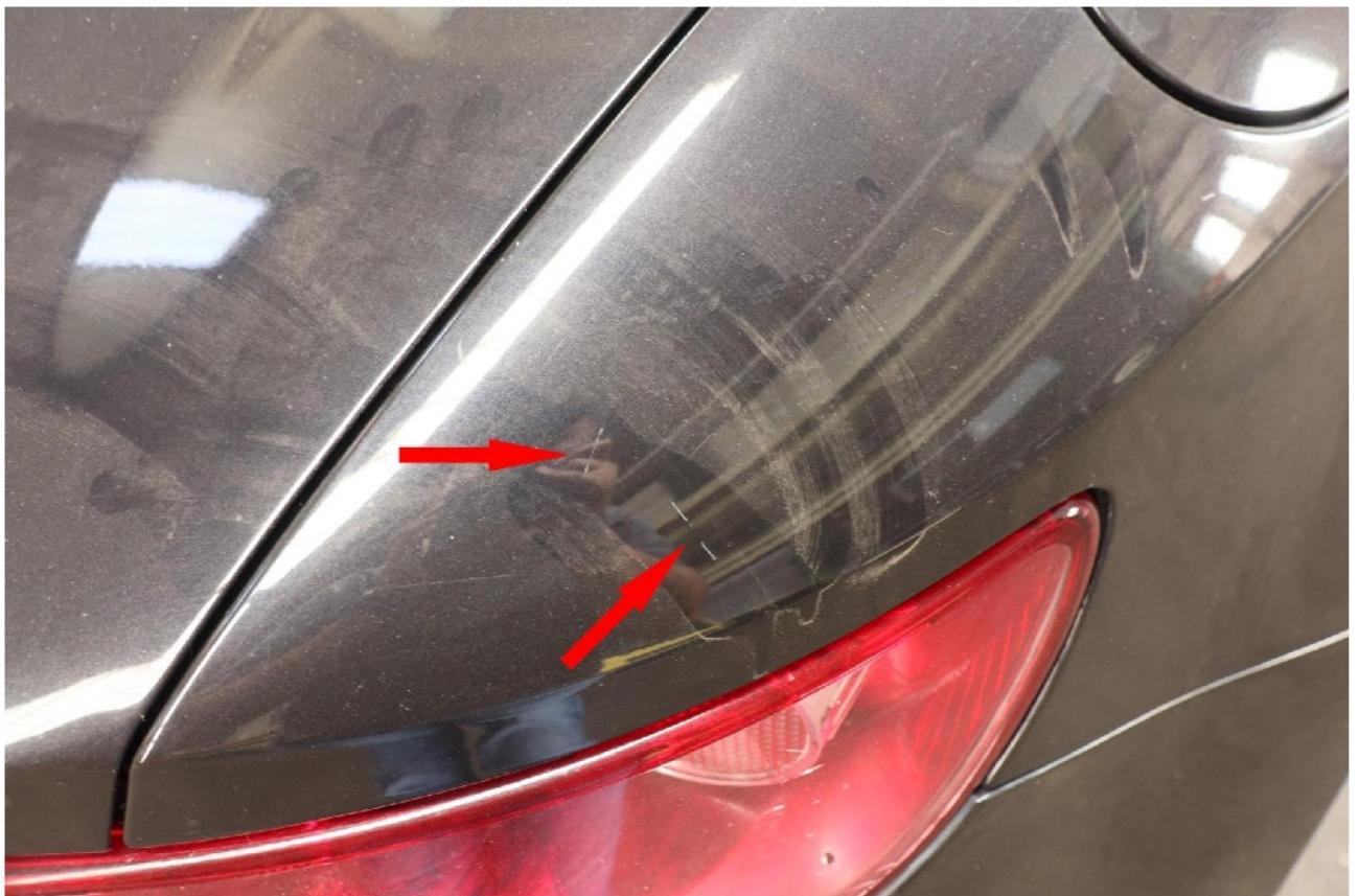
Bild 16: Seitenteil rechts verschrammt
