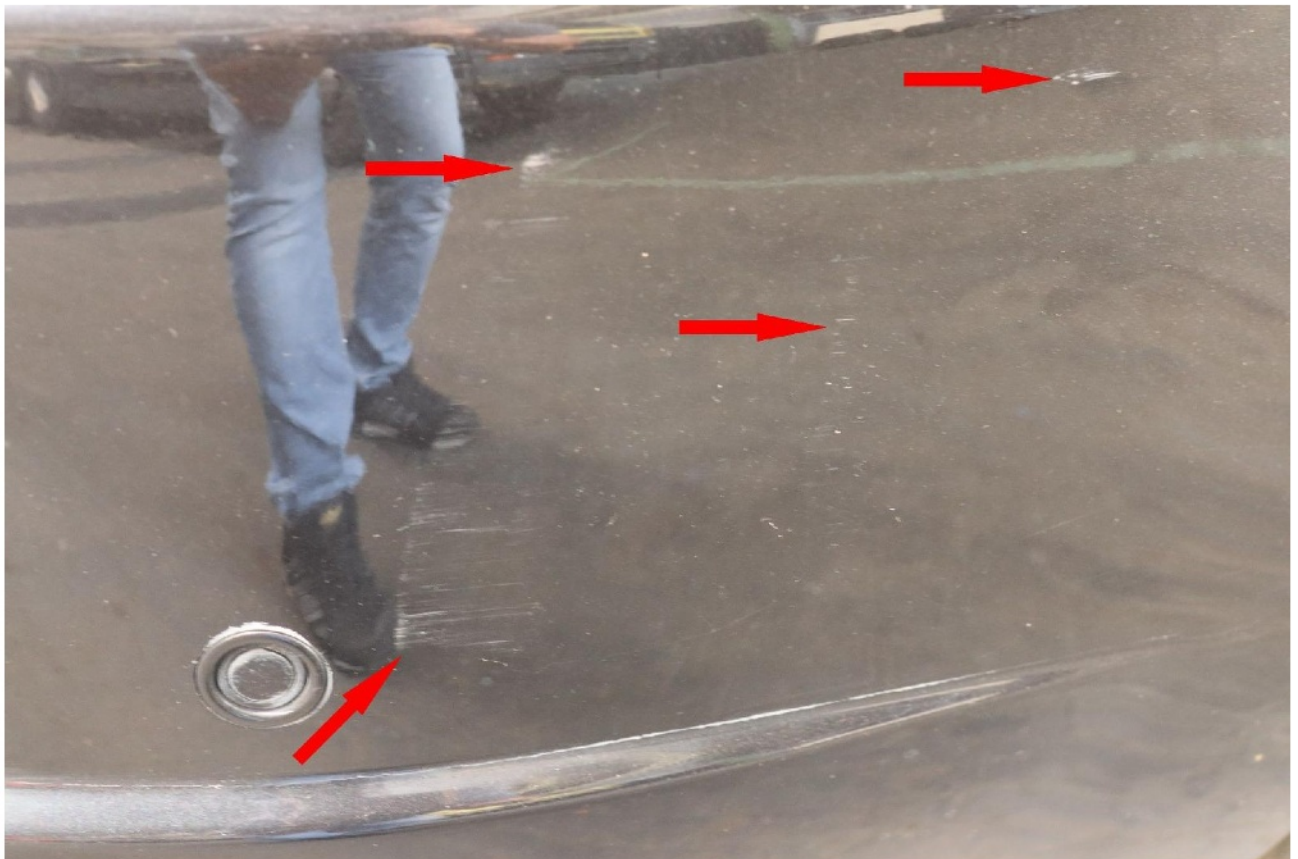
Bild 11: Stoßfängerverkleidung hinten verschrammt
