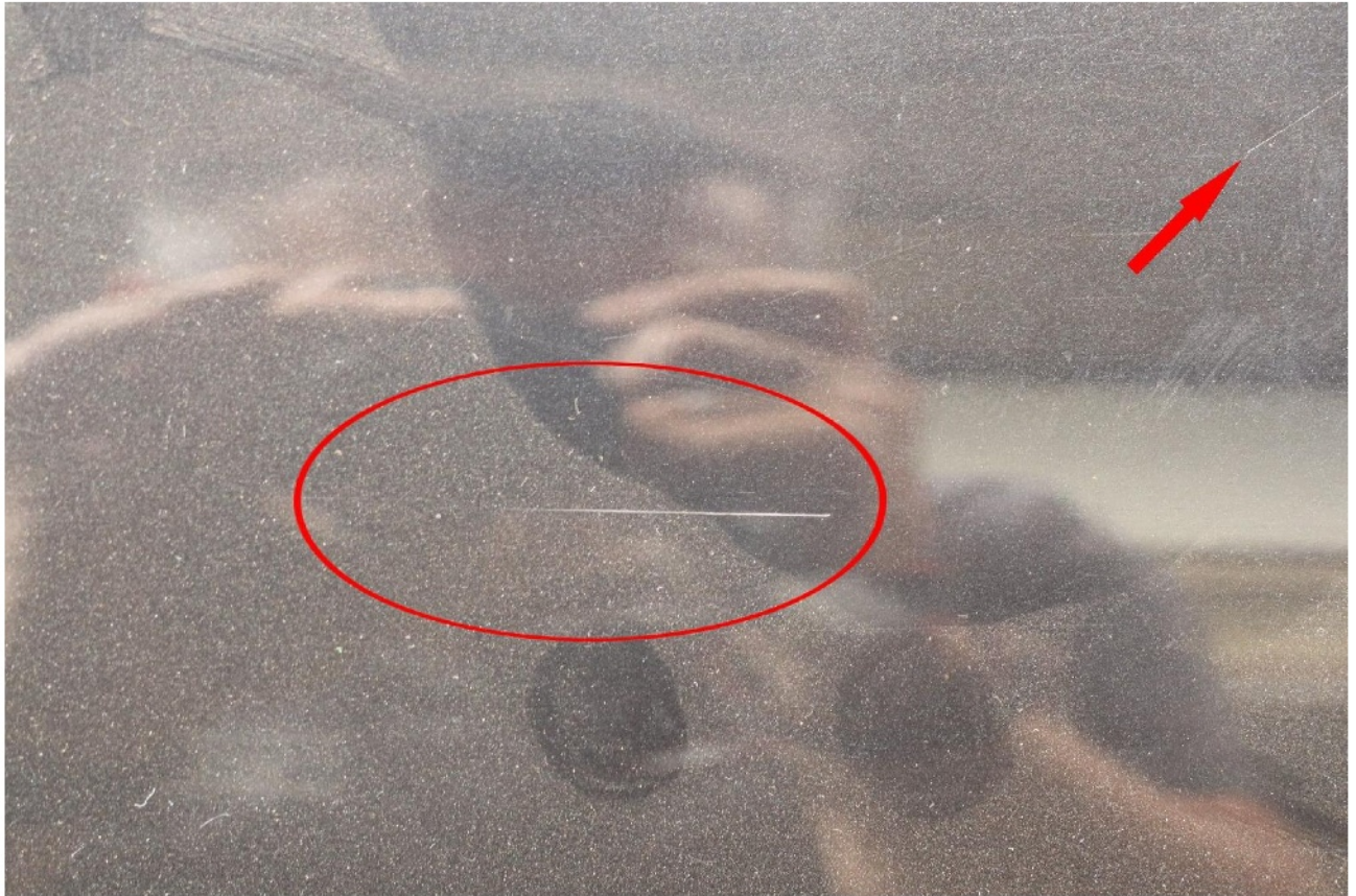
Bild 9: Tür links verschrammt
