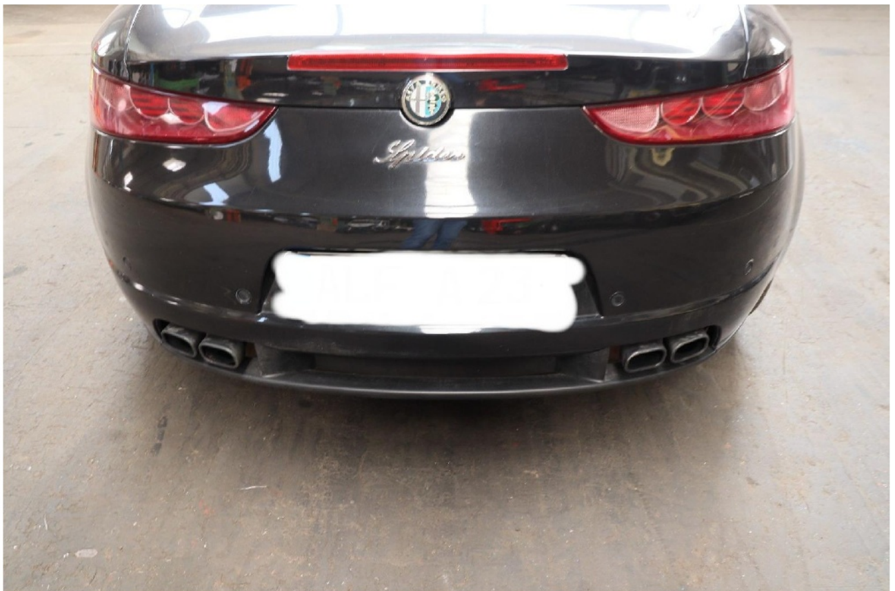
Bild 10: Stoßfängerverkleidung hinten verschrammt
