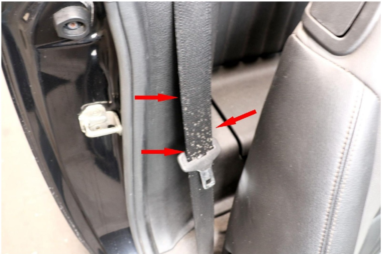
Bild 19: Sicherheitsgurt rechts mit Schimmelsporen kontaminiert
