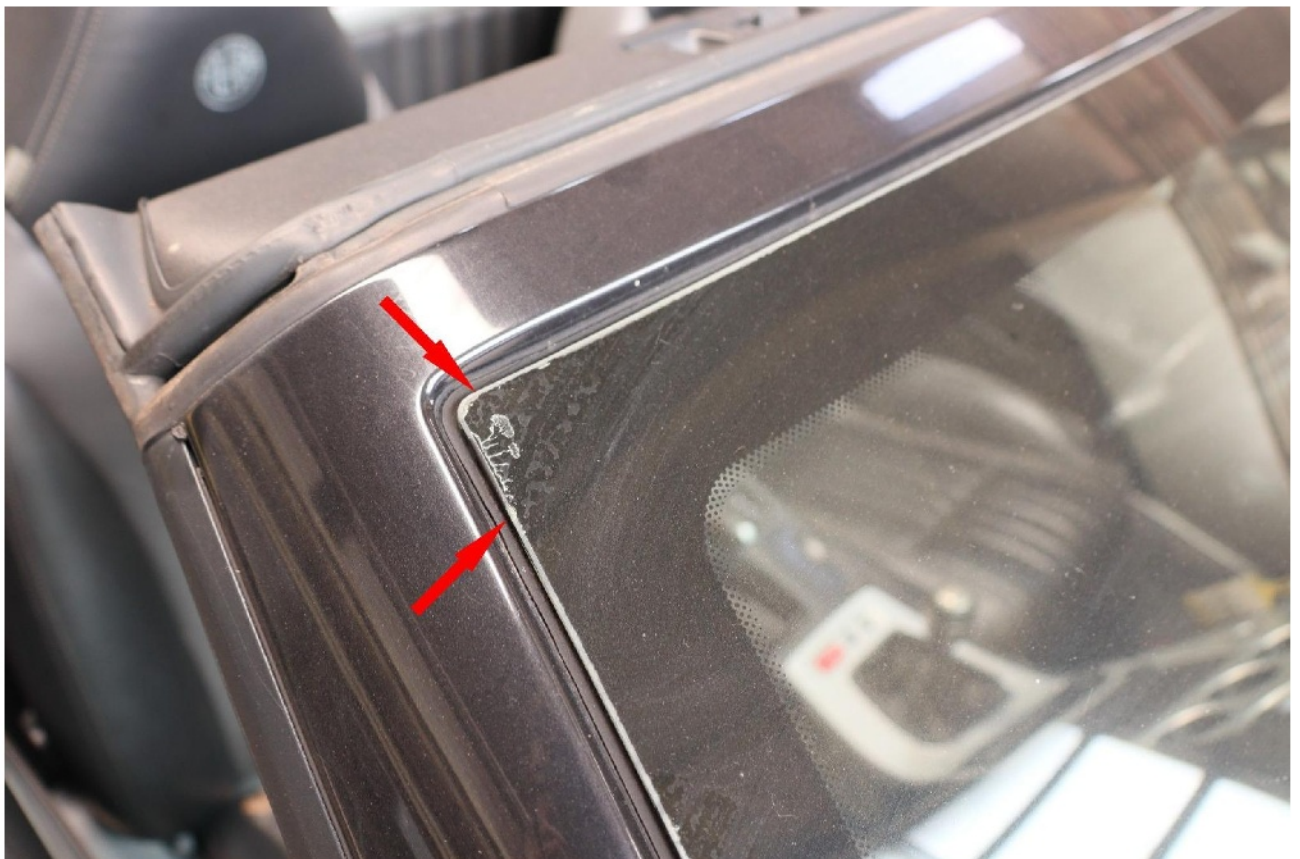
Bild 22: Frontscheibe Verklebung unterwandert
