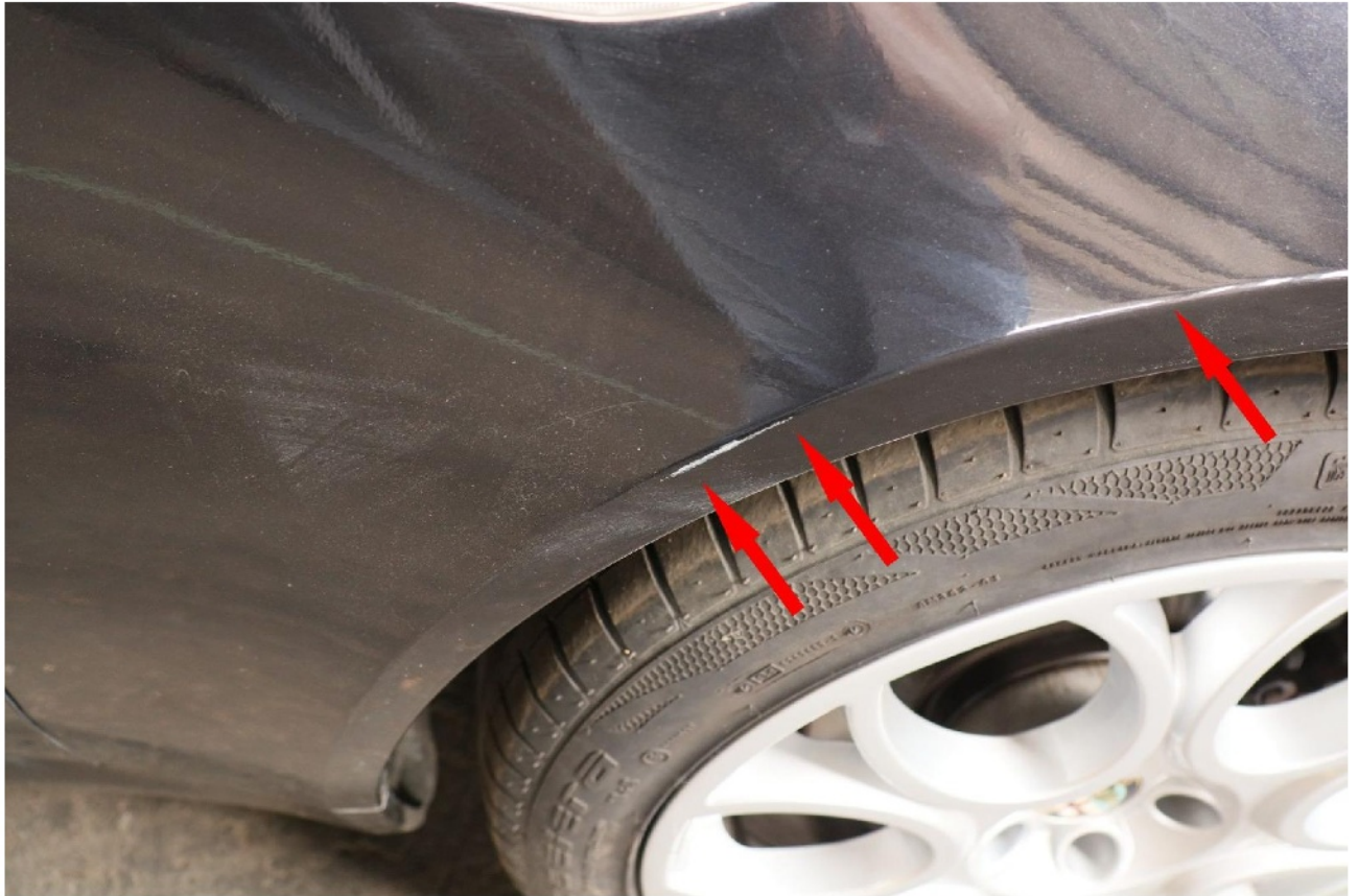
Bild 21: Kotflügel rechts verschrammt
