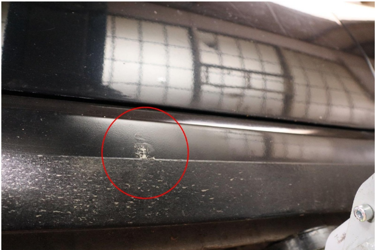
Bild 27: Schweller rechts verschrammt
