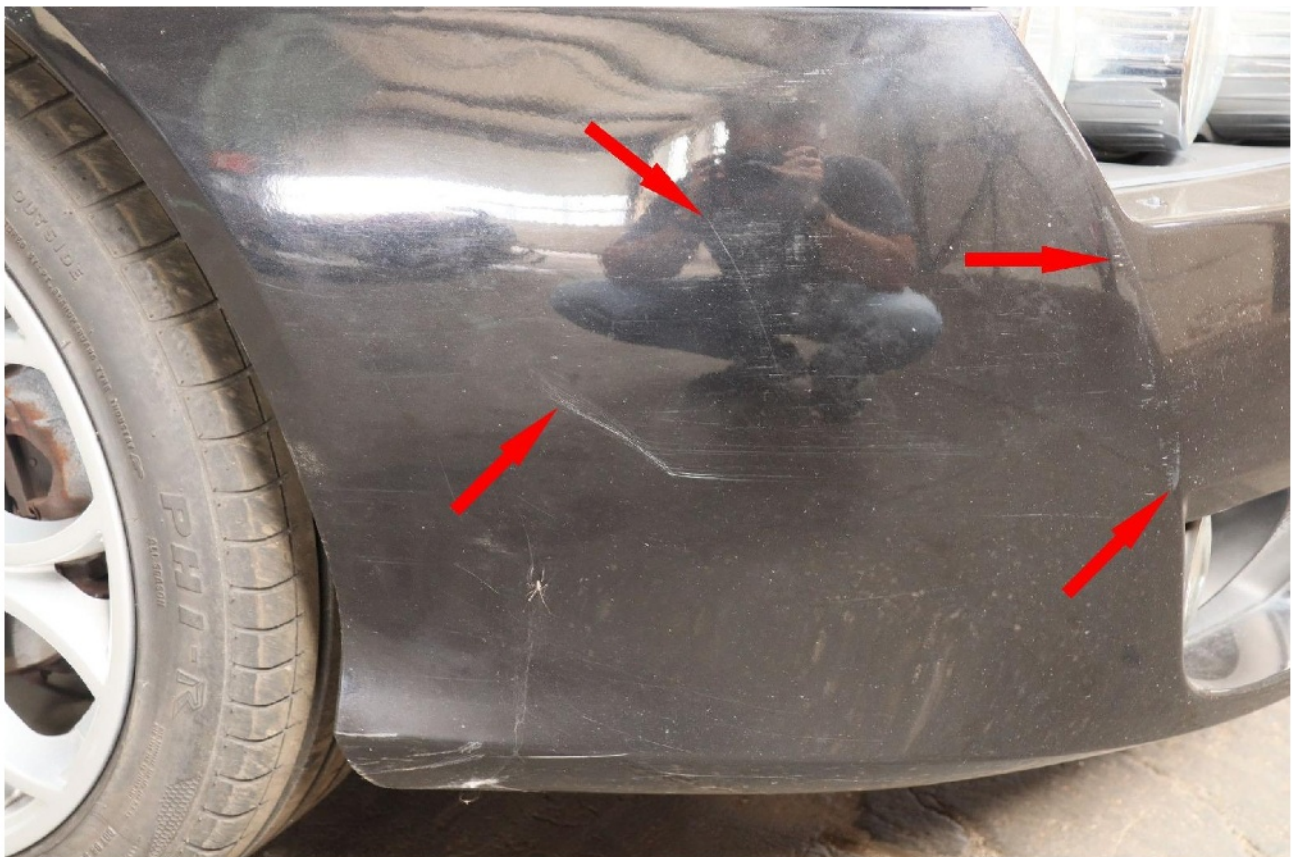
Bild 24: Stoßfängerverkleidung vorn verschrammt
