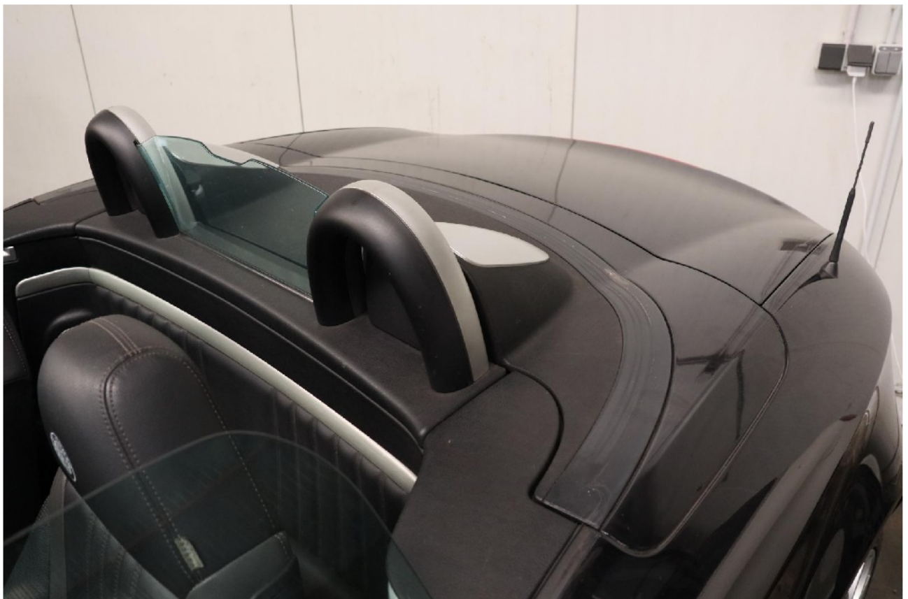
Bild 28: Verdeckkasten verriegelt nicht beim Schließvorgang des Verdecks
