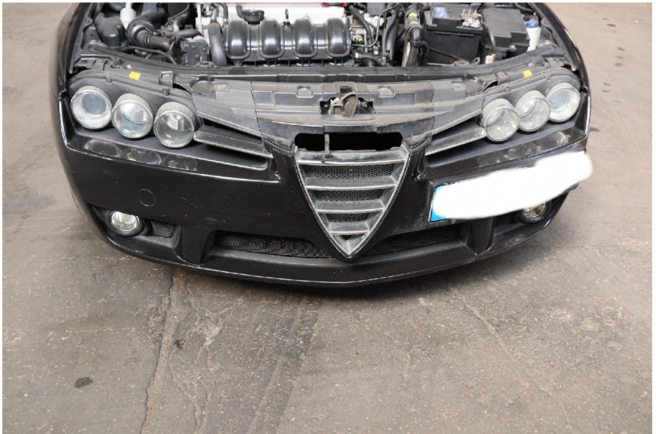
Bild 23: Stoßfängerverkleidung vorn verschrammt
