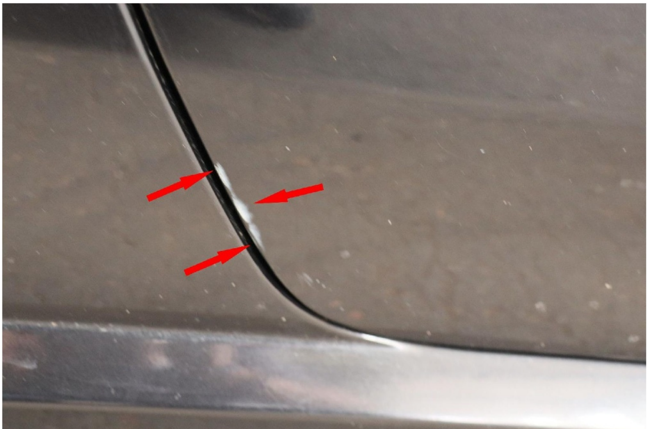
Bild 18: Tür rechts verschrammt
