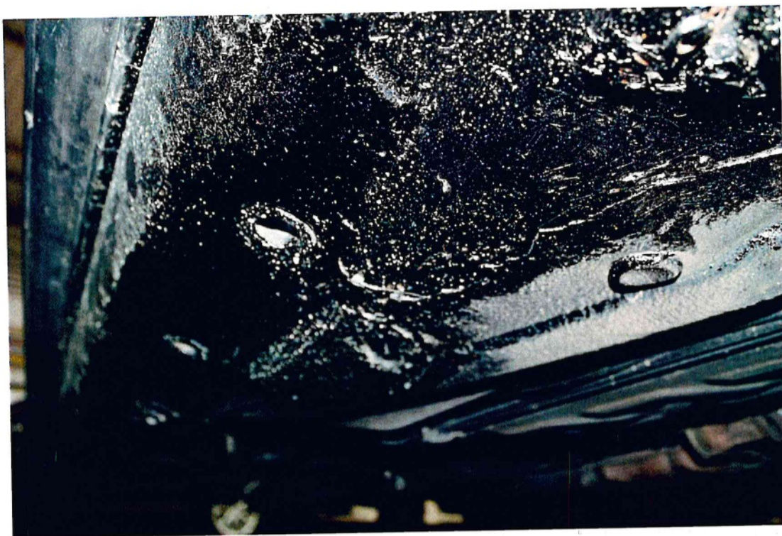
Bild 37 : Schwellerbereiche mit Unterbodenschutz bearbeitet. Risiko Korrosion
