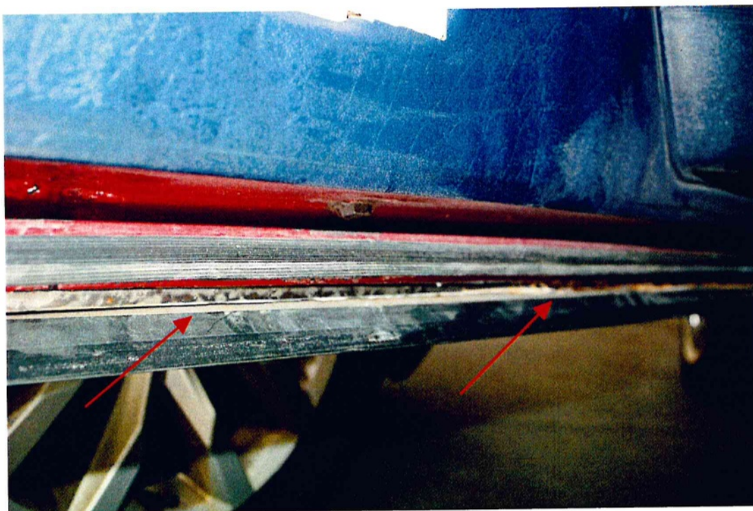
Bild 18 : Korrosion an den Türunterkanten
