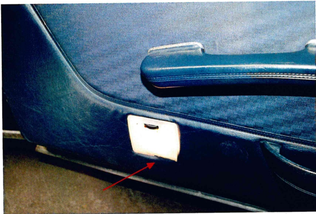
Bild 21 : Leuchte in der Fahrtür gerissen
