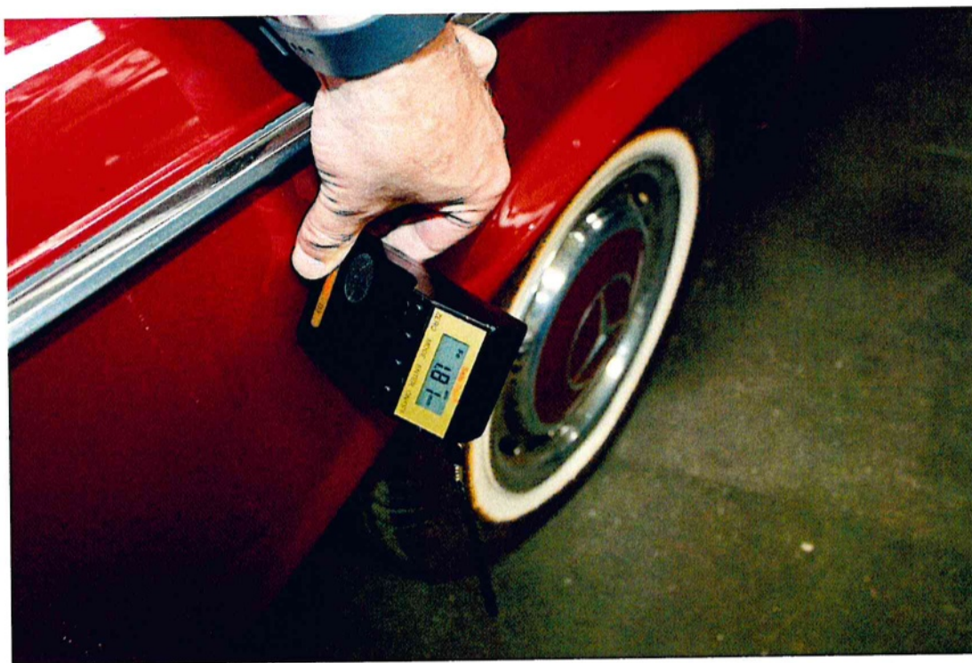
Bild 16 : Deutlicher Spachtelantrag an der rechten Seitenwand
