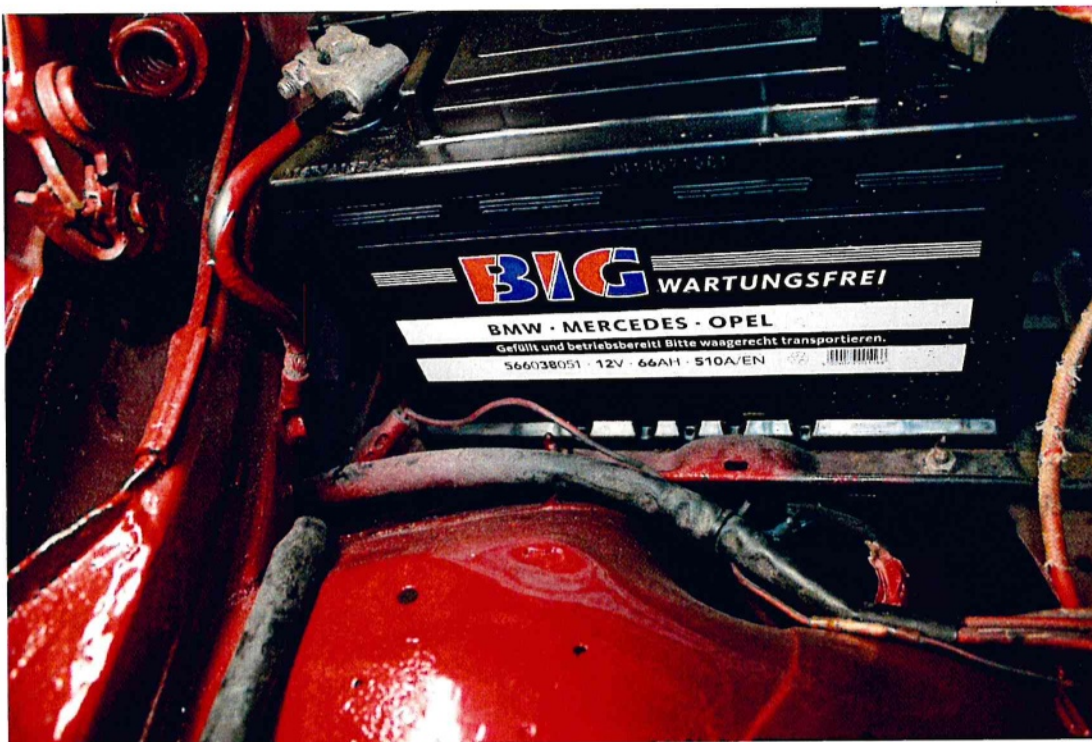
Bild 25 : Farbantragungen an den Anbauteilen
