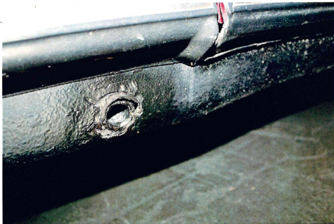
Bild 34 : Korrosion an der Wagenheberaufnahme vorn links
