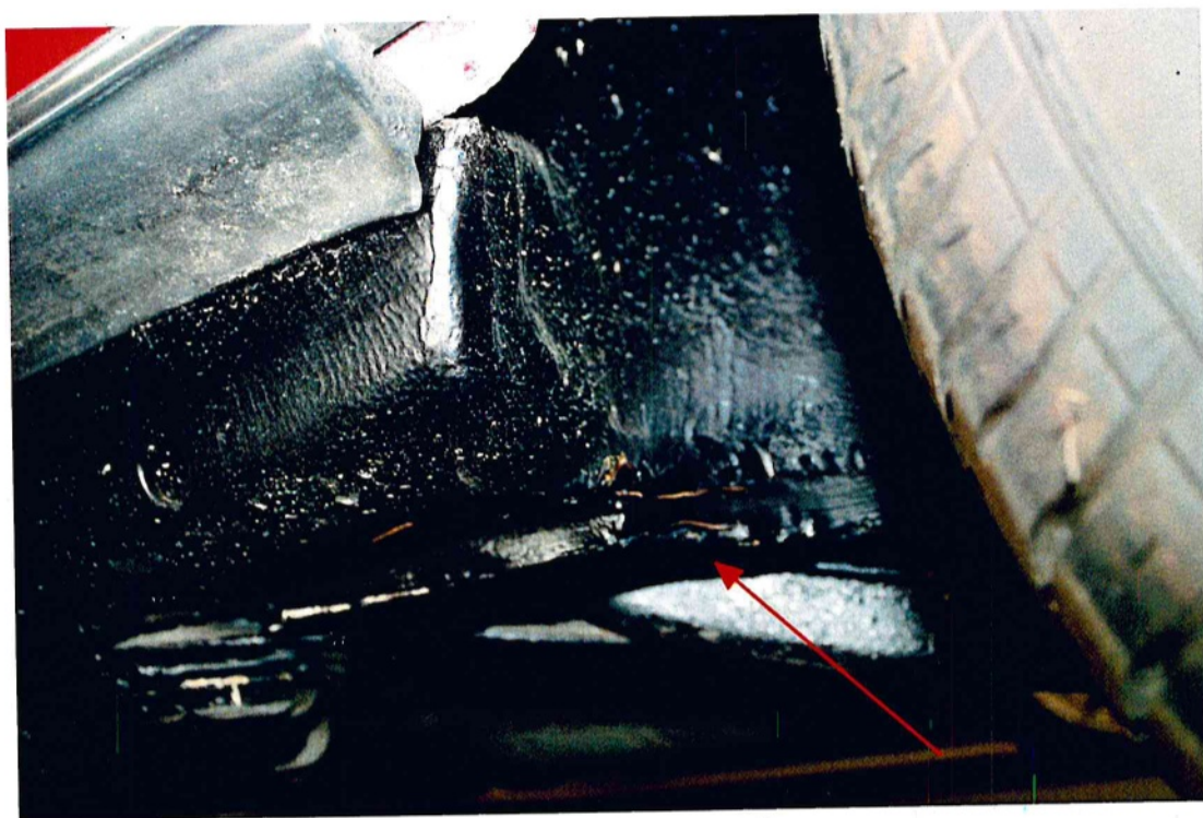
Bild 38 : Reparaturbleche im Radhaus rechts
