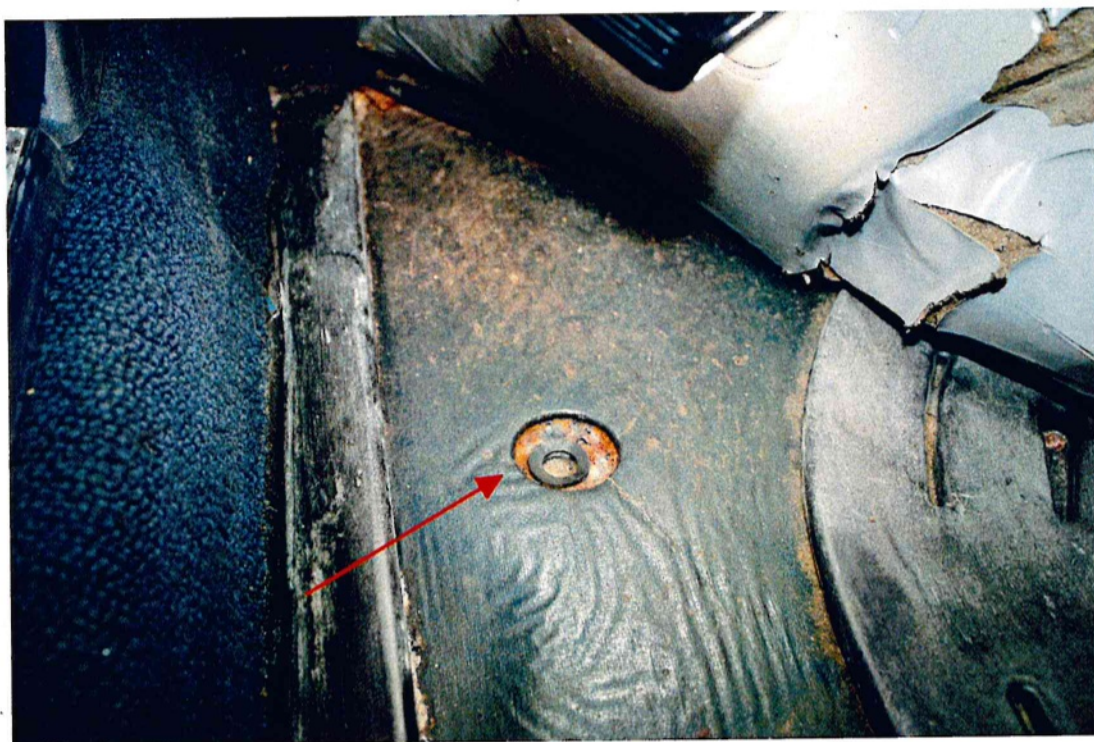
Bild 20 : Korrosion am Unterboden
