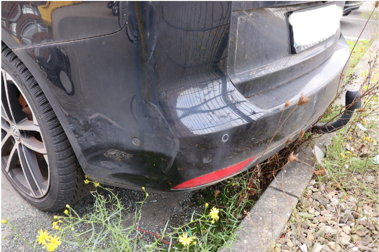
Bild 13: Stoßfängerverkleidung hinten verformt und verschrammt
