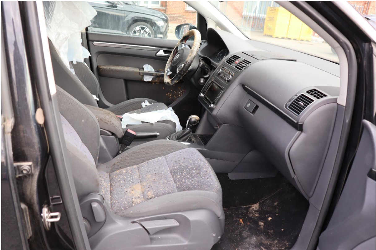
Bild 25: Innenraum mit Schimmelsporen kontaminiert
