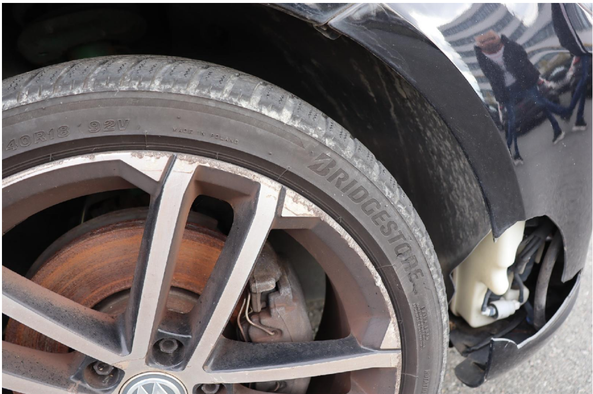
Bild 20: Felge vorn rechts Materialabtrag
