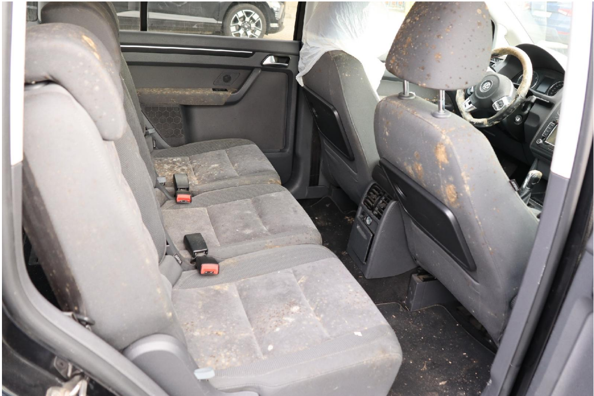
Bild 23: Innenraum mit Schimmelsporen kontaminiert
