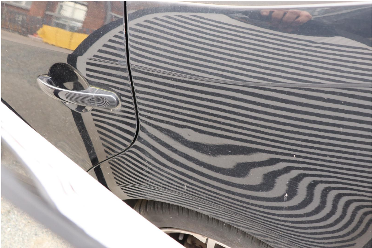
Bild 11: Seitenteil links verformt und verschrämmt
