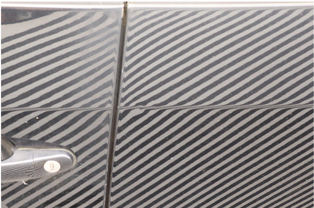
Bild 10: Tür hinten links punktuell eingedrückt
