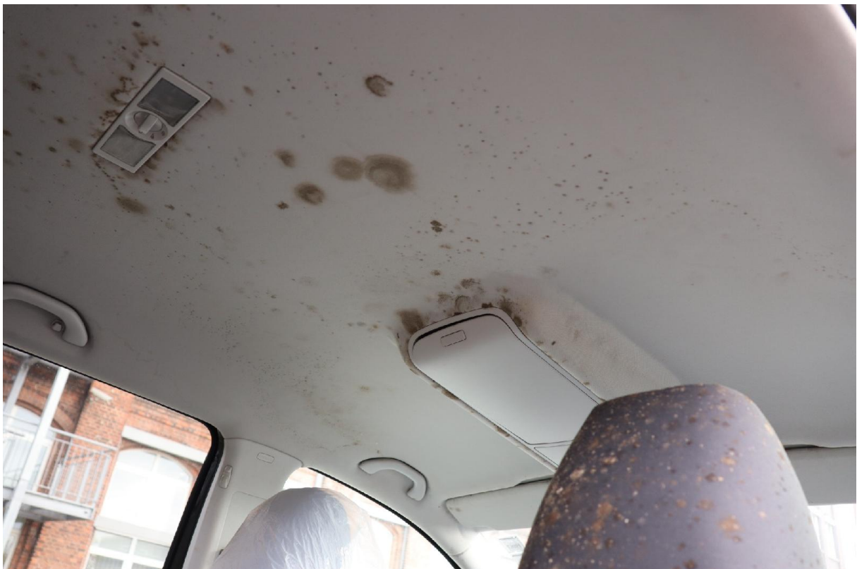
Bild 24: Innenraum mit Schimmelsporen kontaminiert
