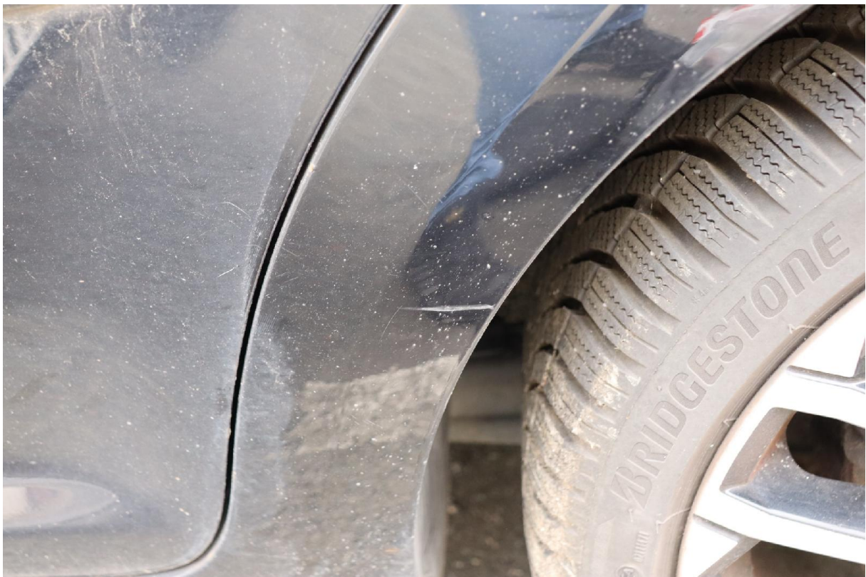
Bild 12: Seitenteil links verformt und verschrämmt
