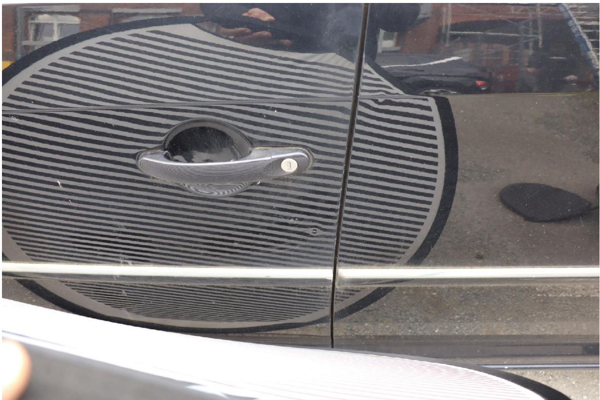
Bild 8: Tür vorn links punktuell eingedrückt
