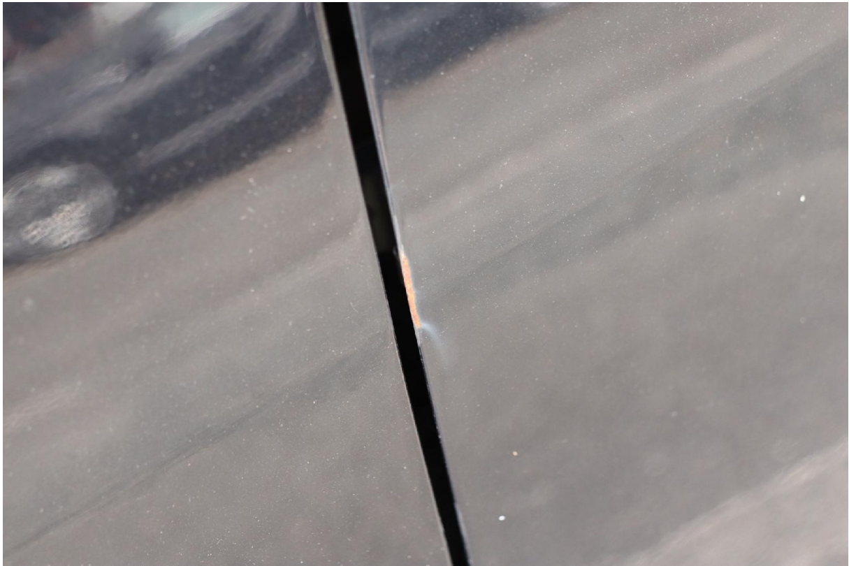
Bild 9: Tür vorn links beginnende Korrosion an der Kante
