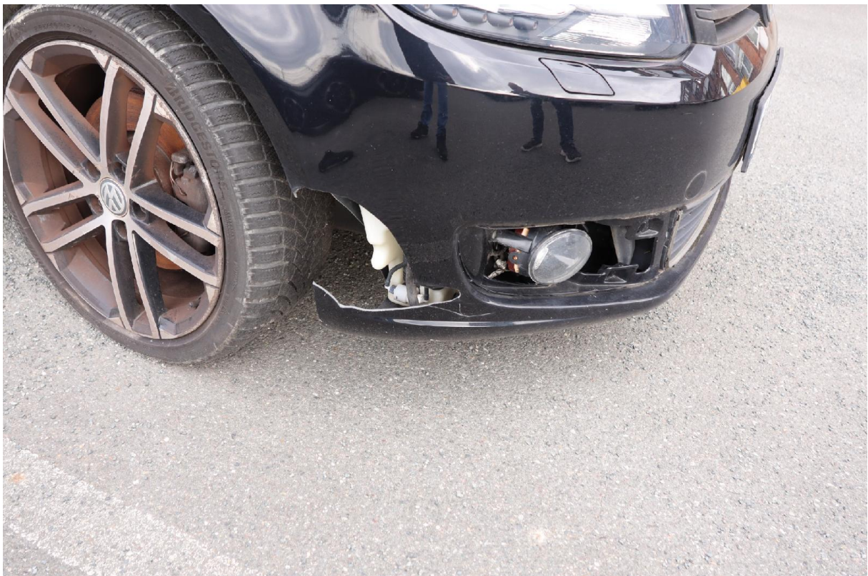
Bild 6: Stoßfängerverkleidung vorn gebrochen
