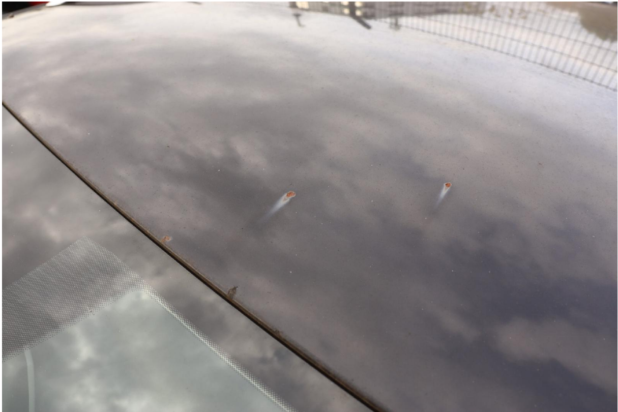
Bild 15: Dach punktuell eingedrückt und beginnende Korrosion
