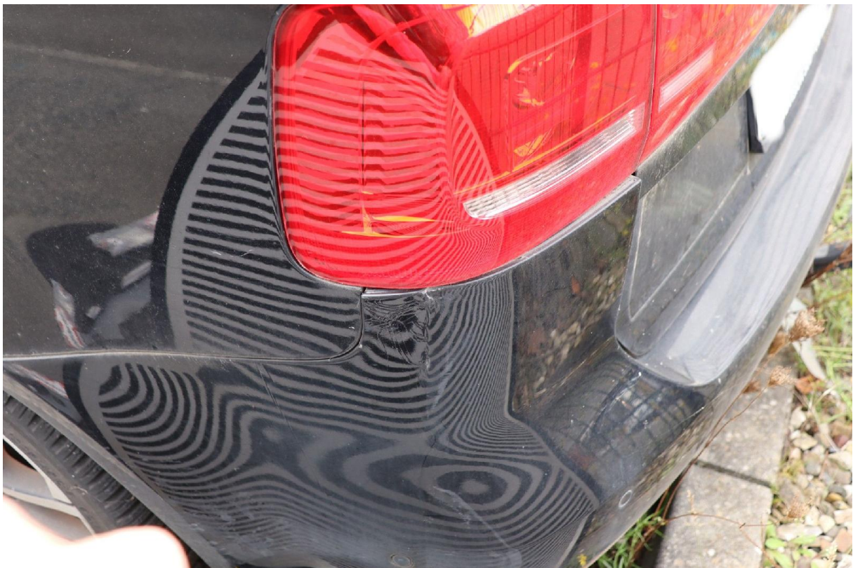
Bild 14: Stoßfängerverkleidung hinten verformt und verschrammt
