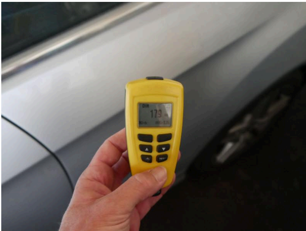
Bild: 18 Lackschichtdicke Seitenwand hinten links erhöht
