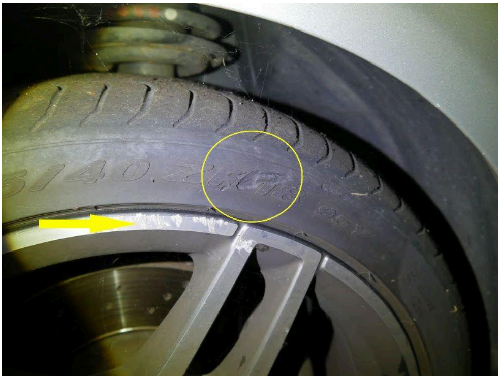
Bild: 14 Reifenflanke vorn links beschädigt, Alufelge vorn links verkratzt
