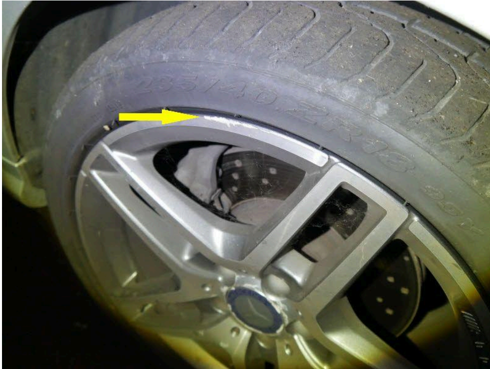
Bild: 17 Alufelge vorn rechts verkratzt
