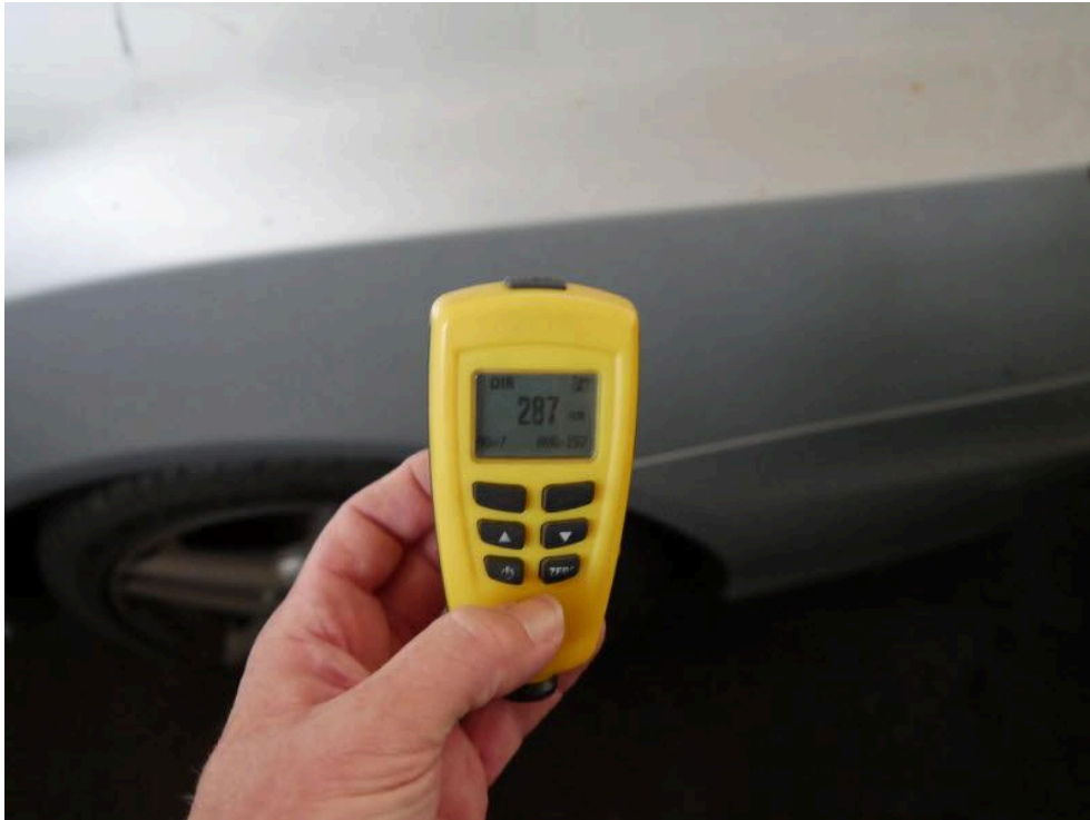
Bild: 19 Lackschichtdicke Seitenwand hinten links erhöht
