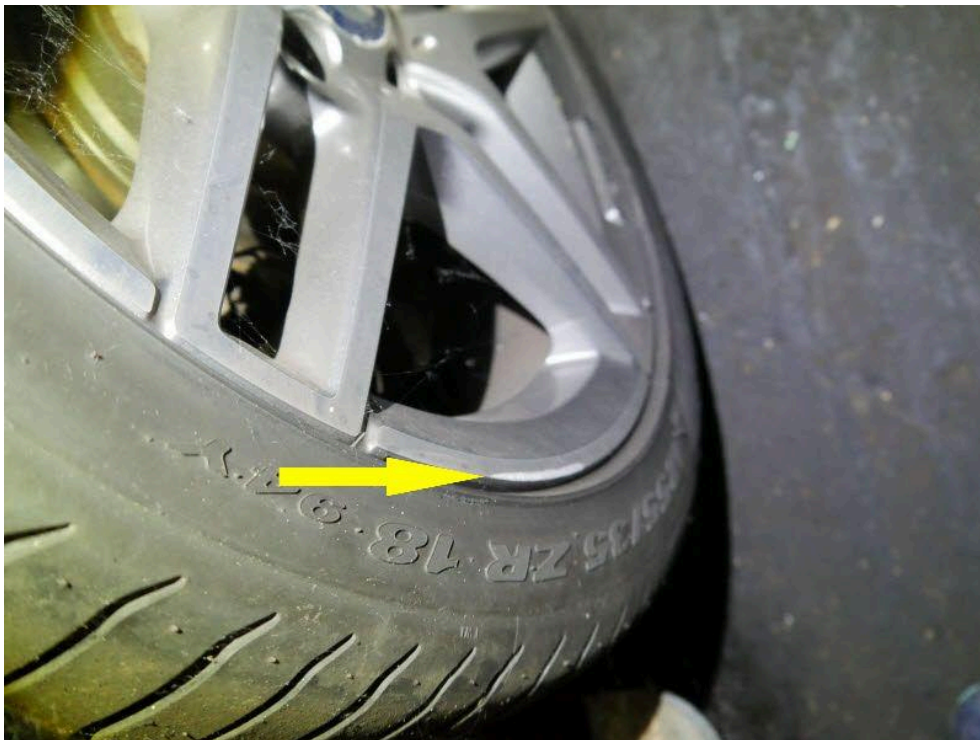
Bild: 15 Alufelge hinten rechts verkratzt
