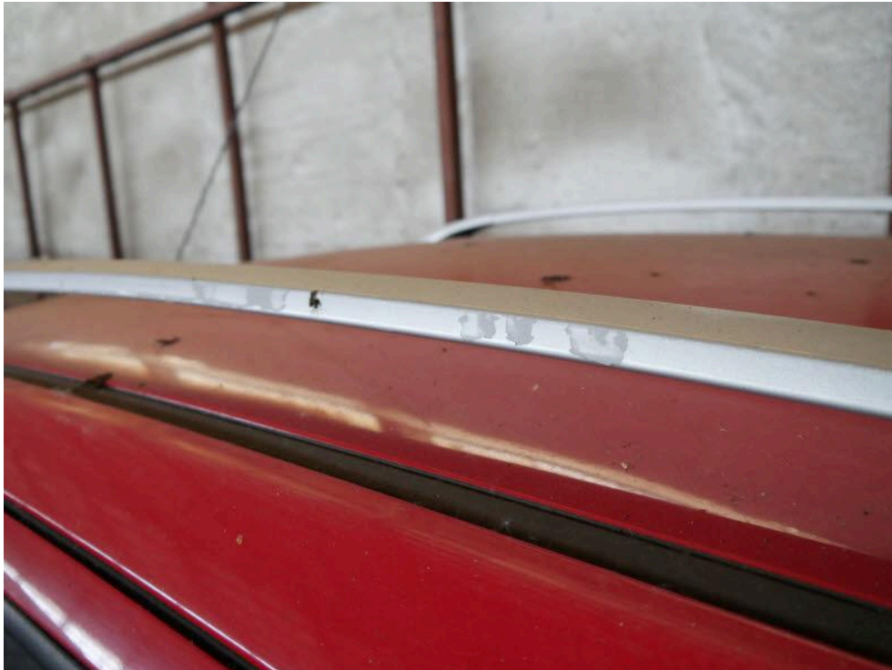
Bild: 11 Lack Dachreling löst sich
