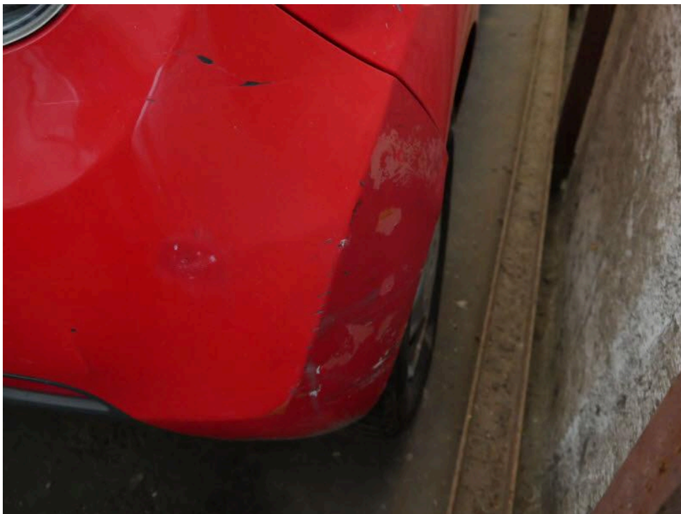
Bild: 14 Stoßfänger hinten rechts plastisch verformt und verkratzt
