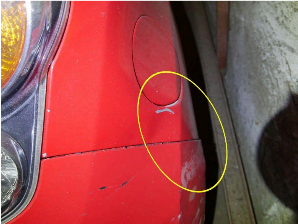
Bild: 13 Seitenwand hinten rechts eingedellt und verkratzt, Stoßfänger hinten rechts plastisch verformt und verkratzt
