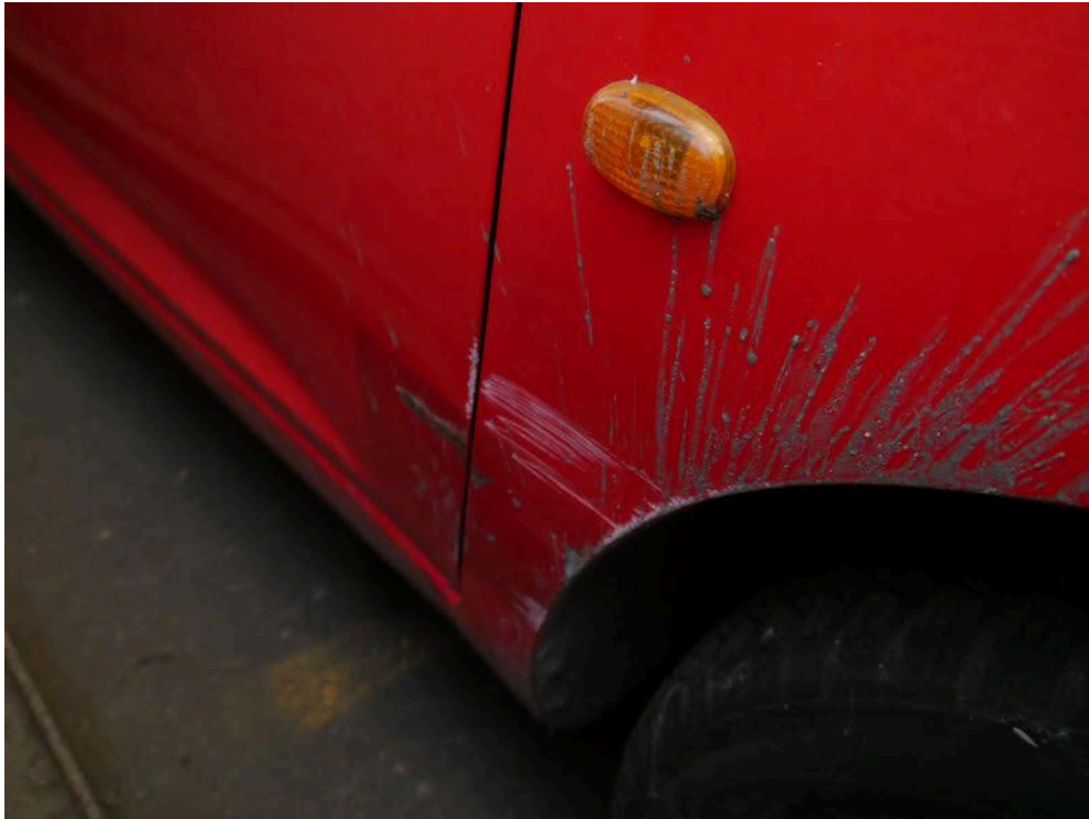
Bild: 21 Kotflügel vorn rechts deformiert und verkratzt, Tür vorn rechts verkratzt
