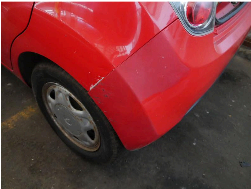
Bild: 16 Stoßfänger hinten links verkratzt, Seitenwand hinten links verkratzt
