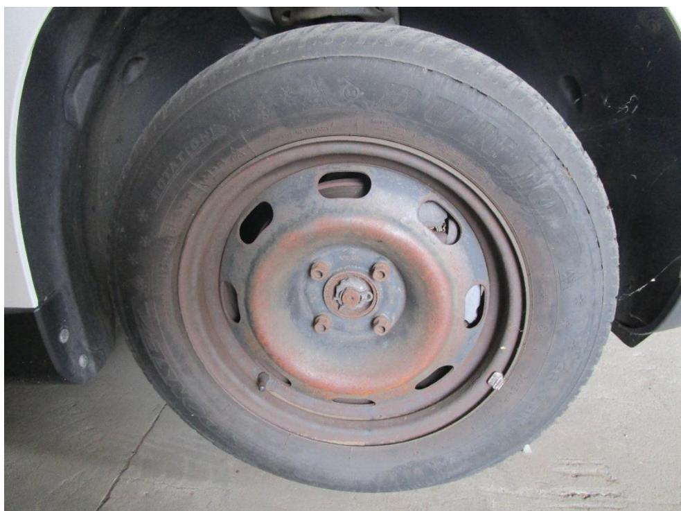
Bild 04 – Reifen porös, Felgen verrostet
