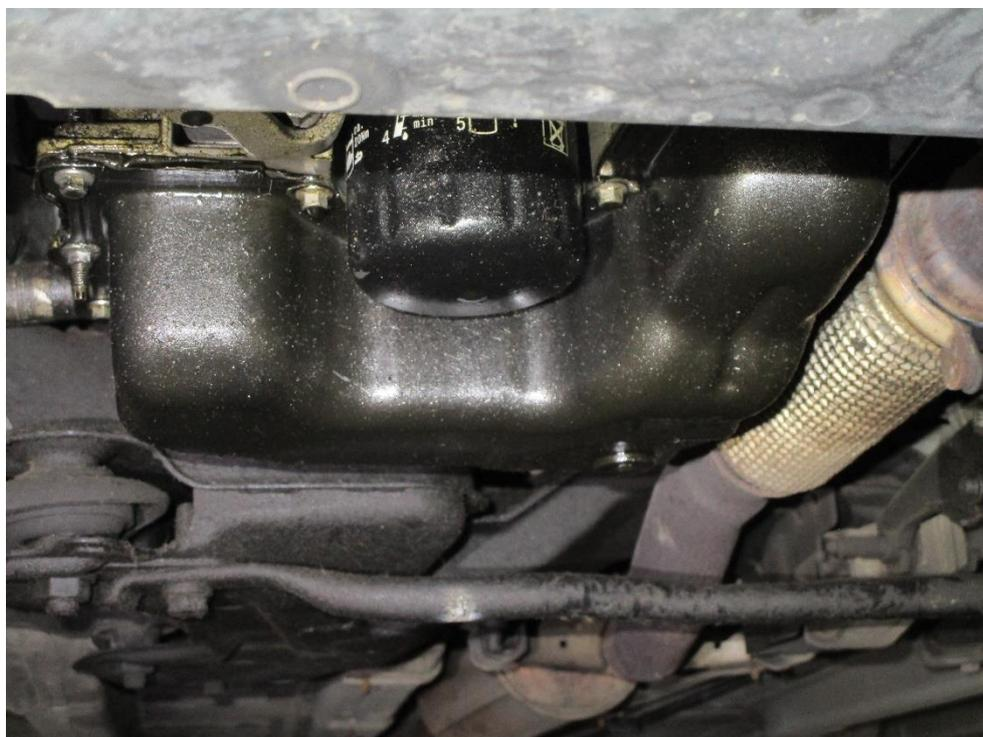
Bild 03 – Motor Ölverlust
