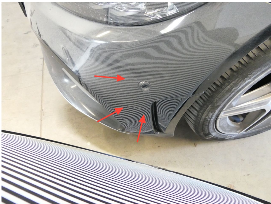
Bild 14: Stoßstange vorne, verschrammt
