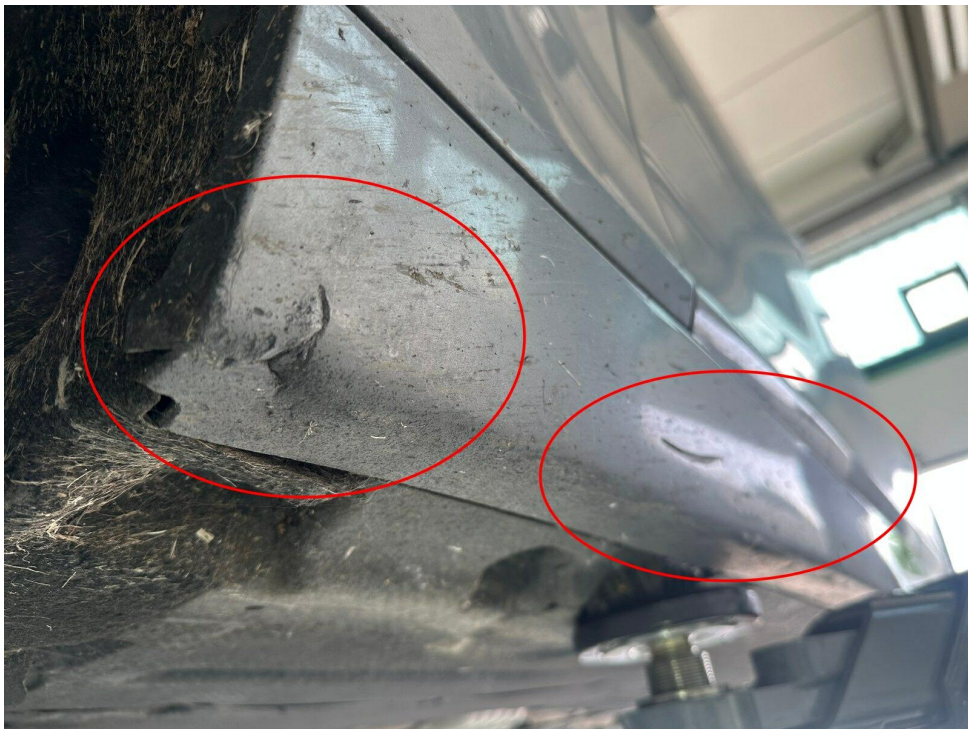
Bild 23 : Schwellerverkleidung links mehrfach verformt
