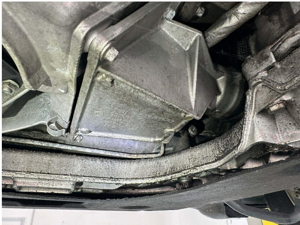
Bild 27 : Ölverlust im Motorraum
