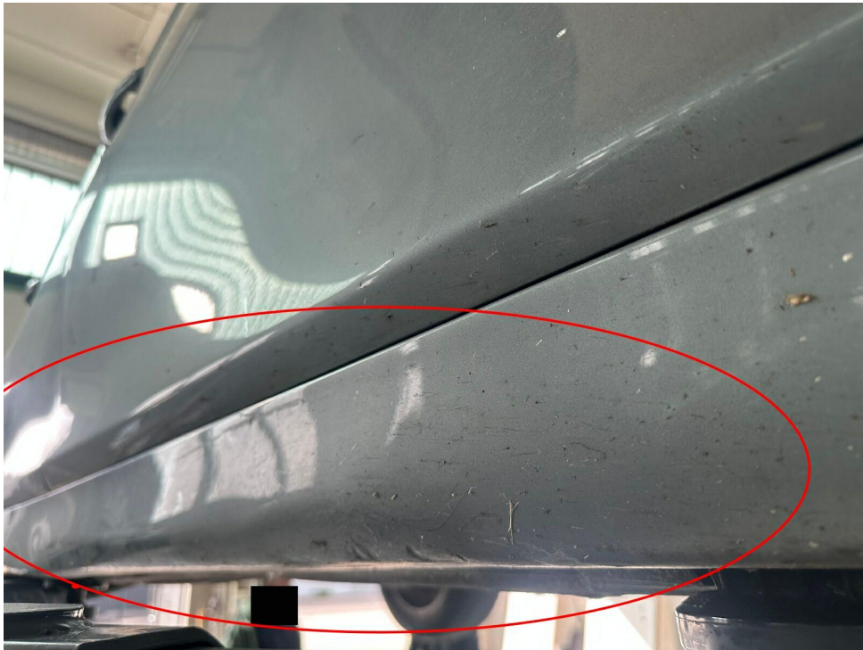
Bild 16 : Schwellerverkleidung rechts deformiert und angeschrammt
