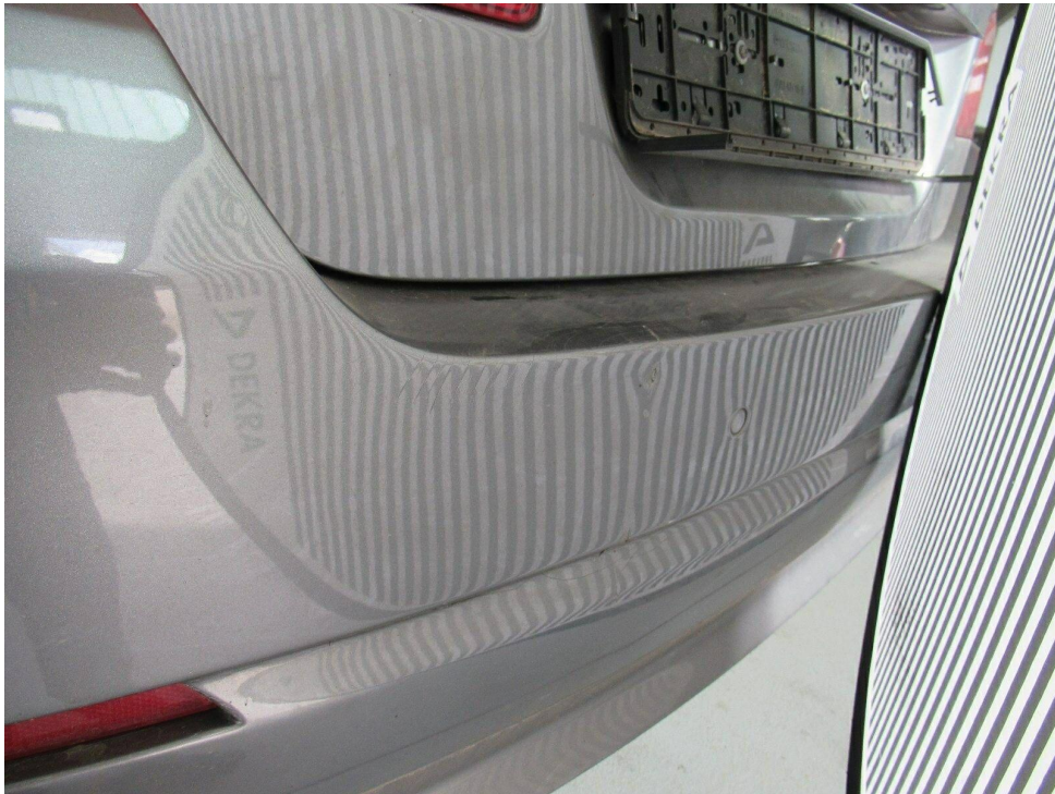
Bild 18 : Stoßfängerverkleidung hinten mehrfach deformiert
