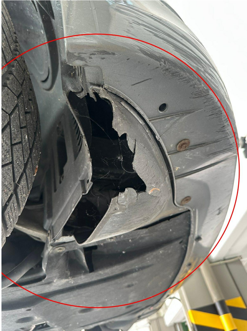
Bild 9 : Luftführung vorne rechts unten gebrochen
