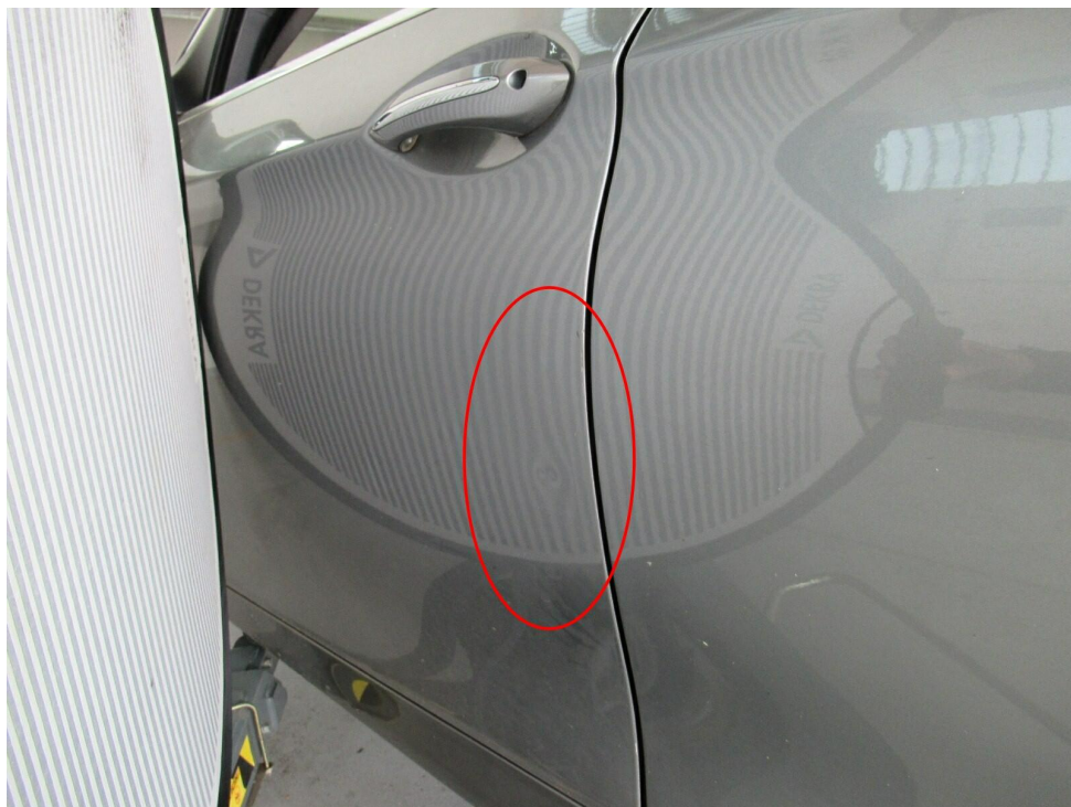
Bild 21 : Tür vorne links eingedrückt
