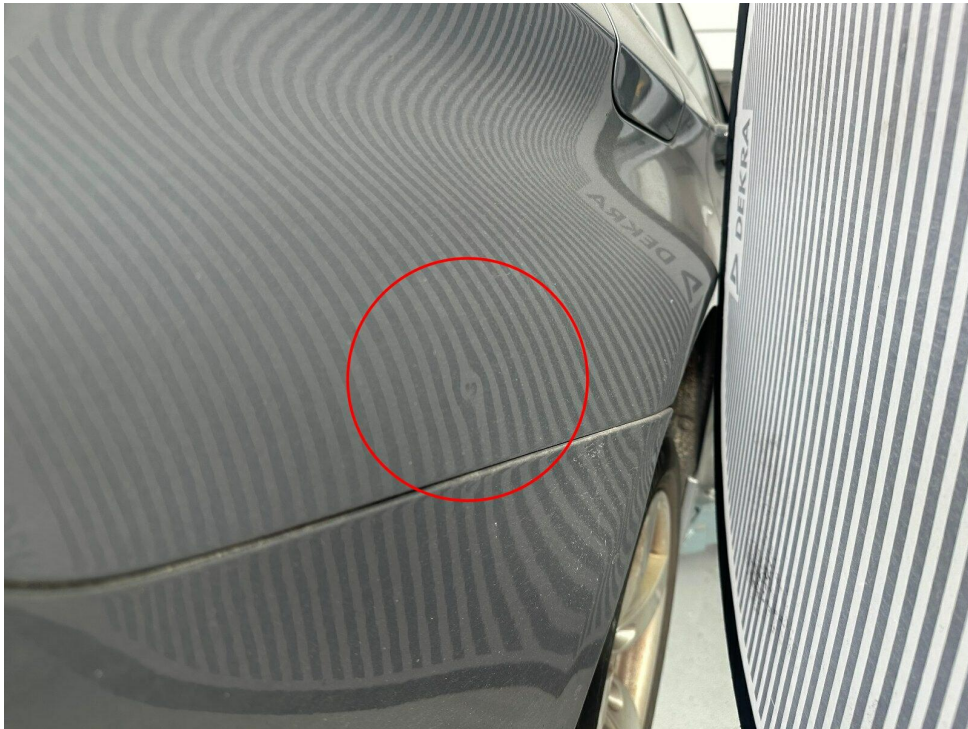
Bild 14 : Seitenwand hinten rechts eingedellt
