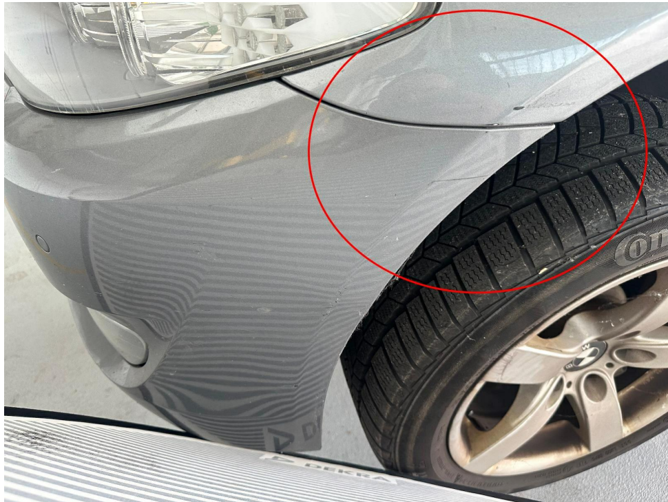
Bild 24 : Stoßfängerverkleidung und Seitenwand vorne links angeschrammt
