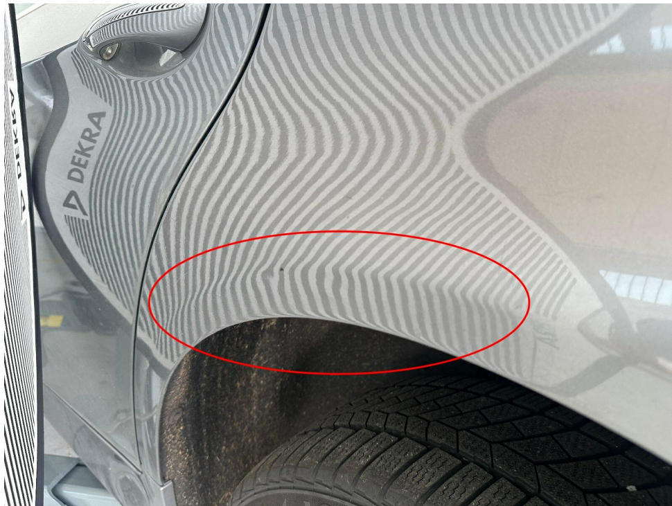
Bild 20 : Seitenwand hinten links mehrfach eingedellt
