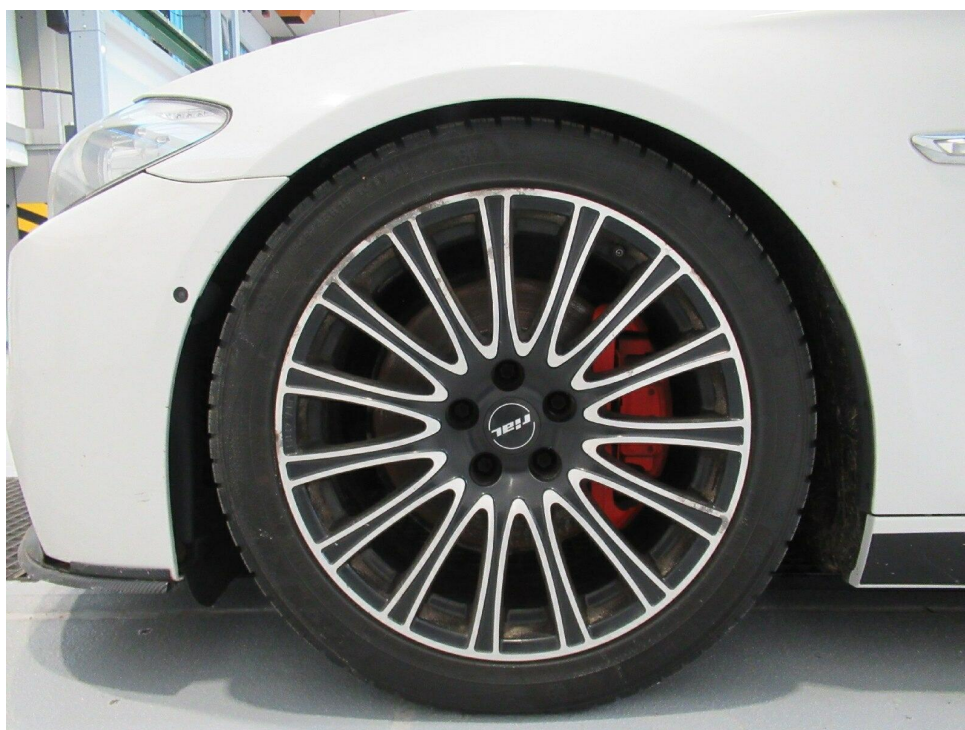
Bild 16 : LM-Rad vorne links korrodiert
