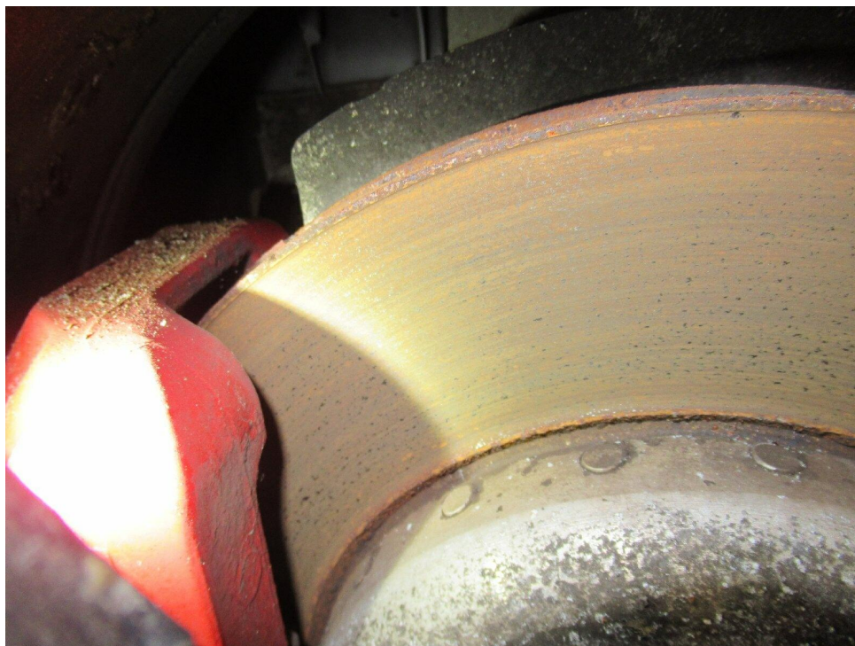
Bild 17 : Bremsscheiben vorne korrodiert - Foto exemplarisch
