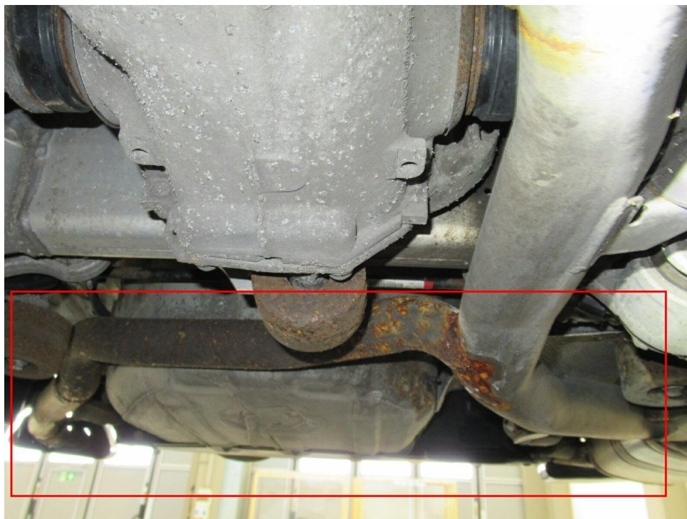
Bild 25 : Abgasanlage unzulässig verändert
