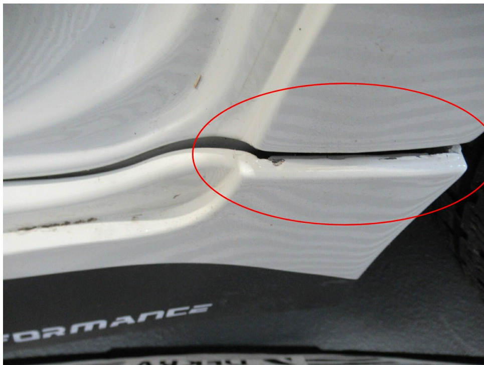
Bild 21 : Schwellerverkleidung links beschädigt und steht ab
