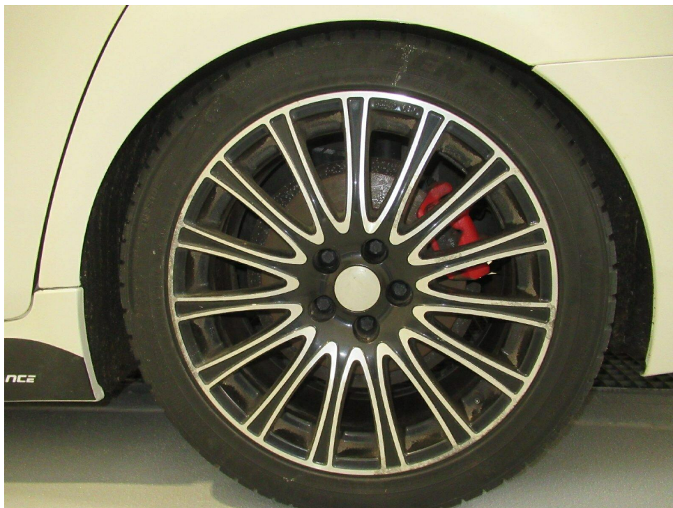
Bild 15 : LM-Rad hinten links korrodiert
