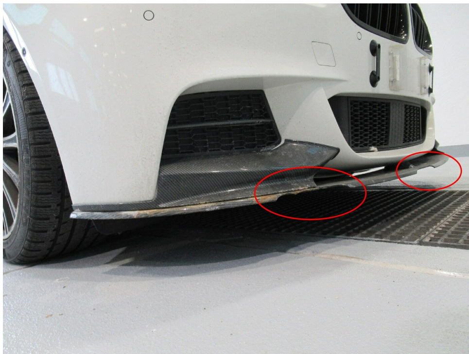
Bild 11 : Frontspoiler mehrfach gebrochen
