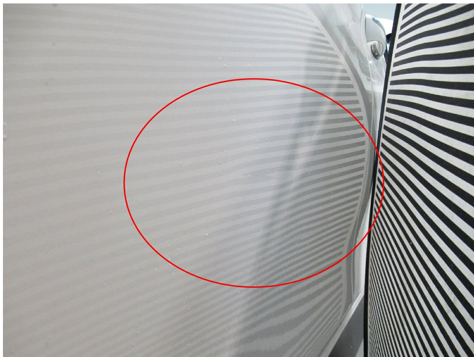
Bild 20 : Tür hinten rechts eingedrückt und angeschrammt
