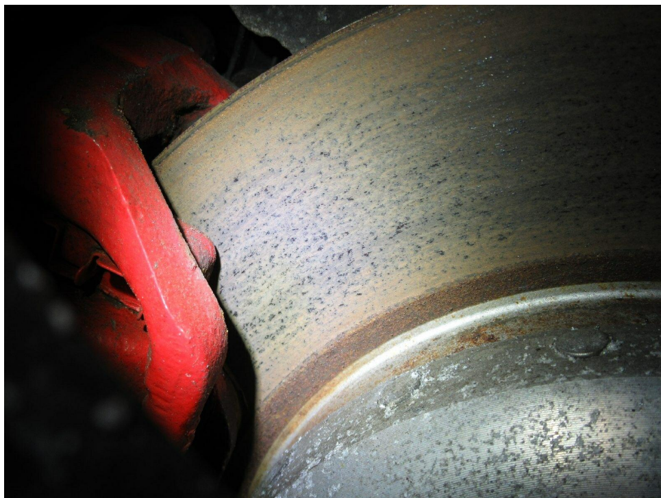
Bild 18 : Bremsscheiben hinten korrodiert - Foto exemplarisch
