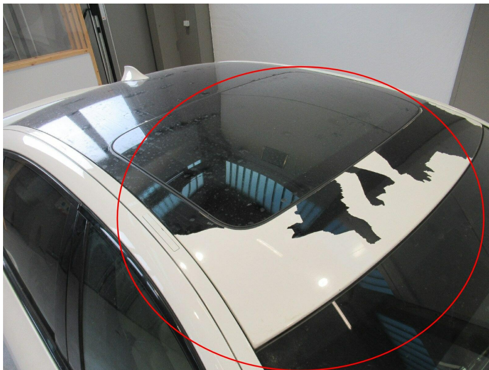
Bild 9 : Folierung auf dem Dach löst sich ab
