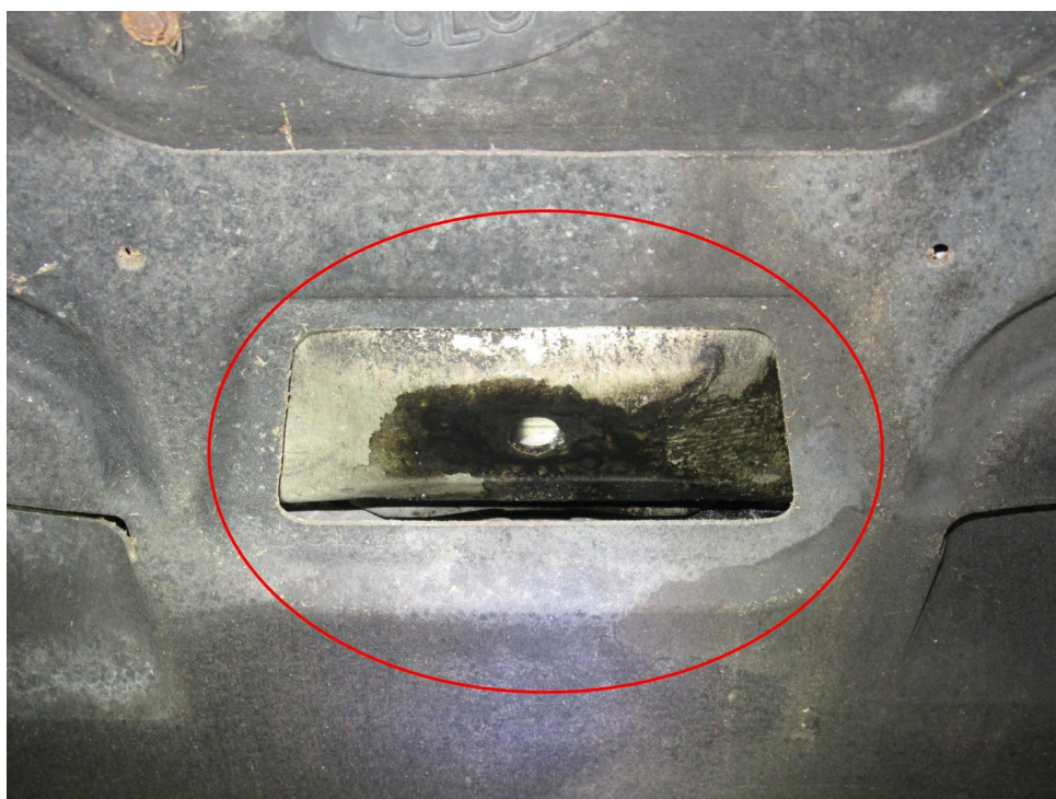
Bild 24 : Motorölverlust mit Abtropfen - Ansicht von unten
