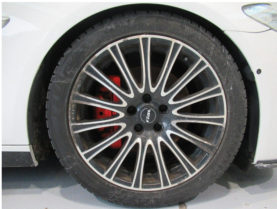
Bild 13 : LM-Rad vorne rechts korrodiert
