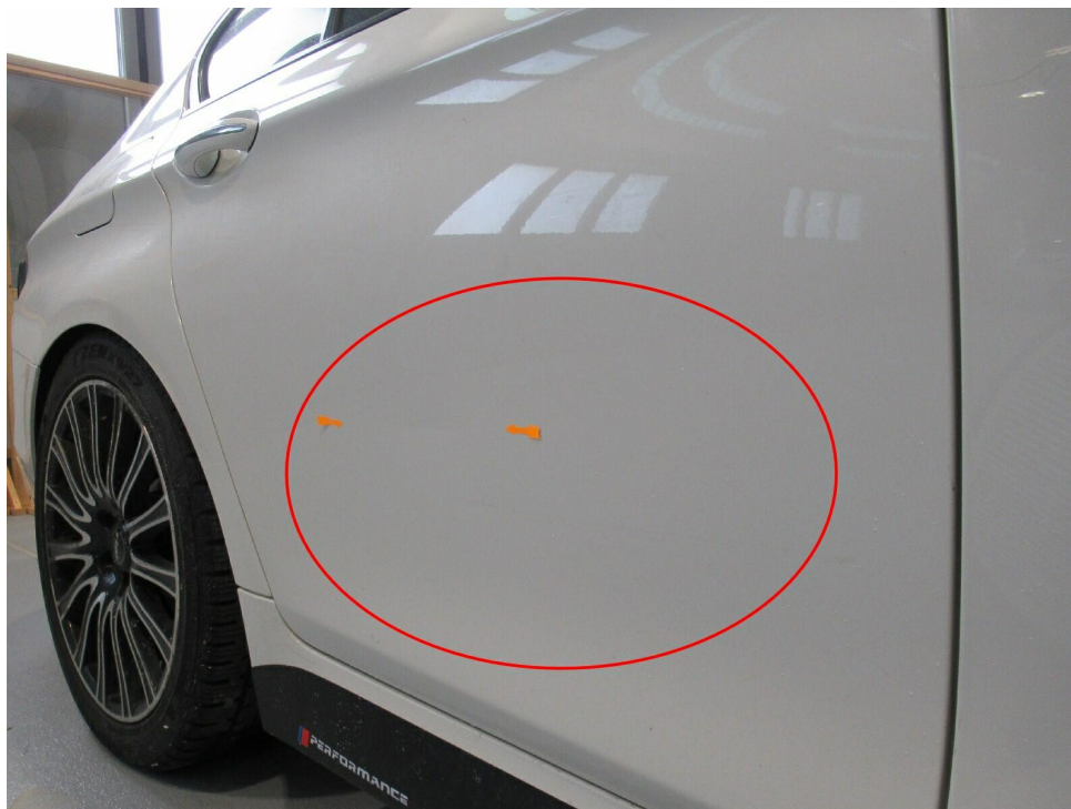
Bild 19 : Tür hinten rechts eingedrückt und angeschrammt
