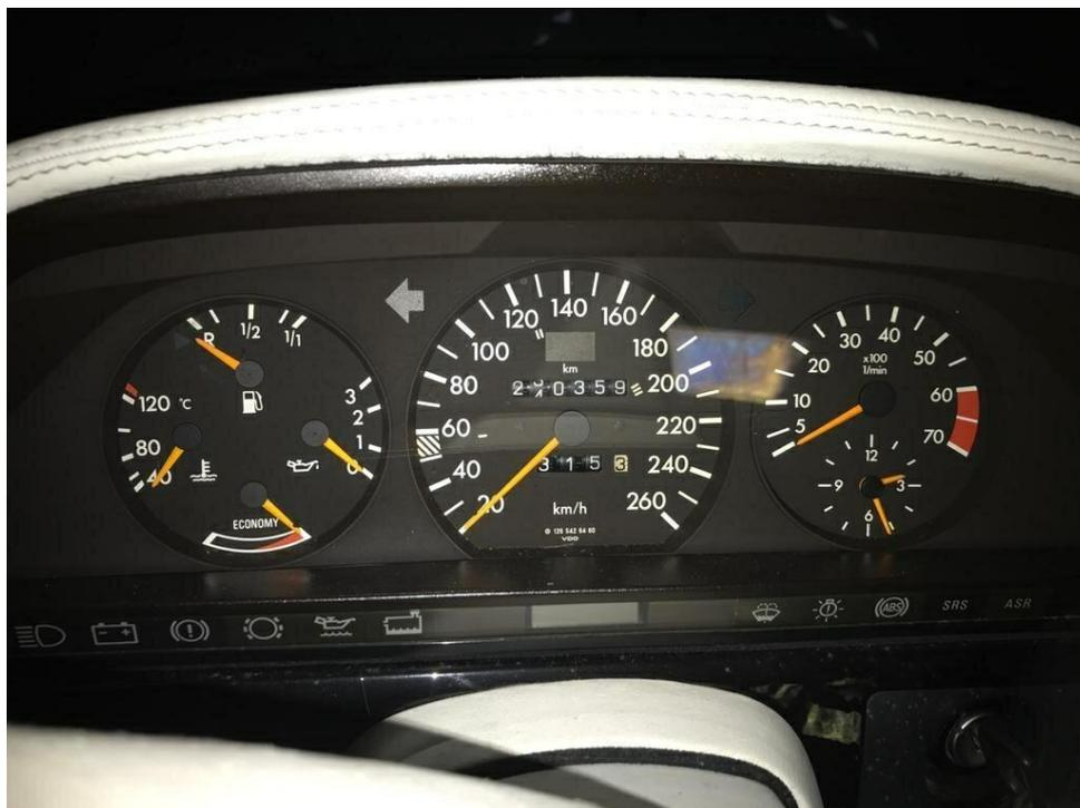
Bild 4 : Kombiinstrument
