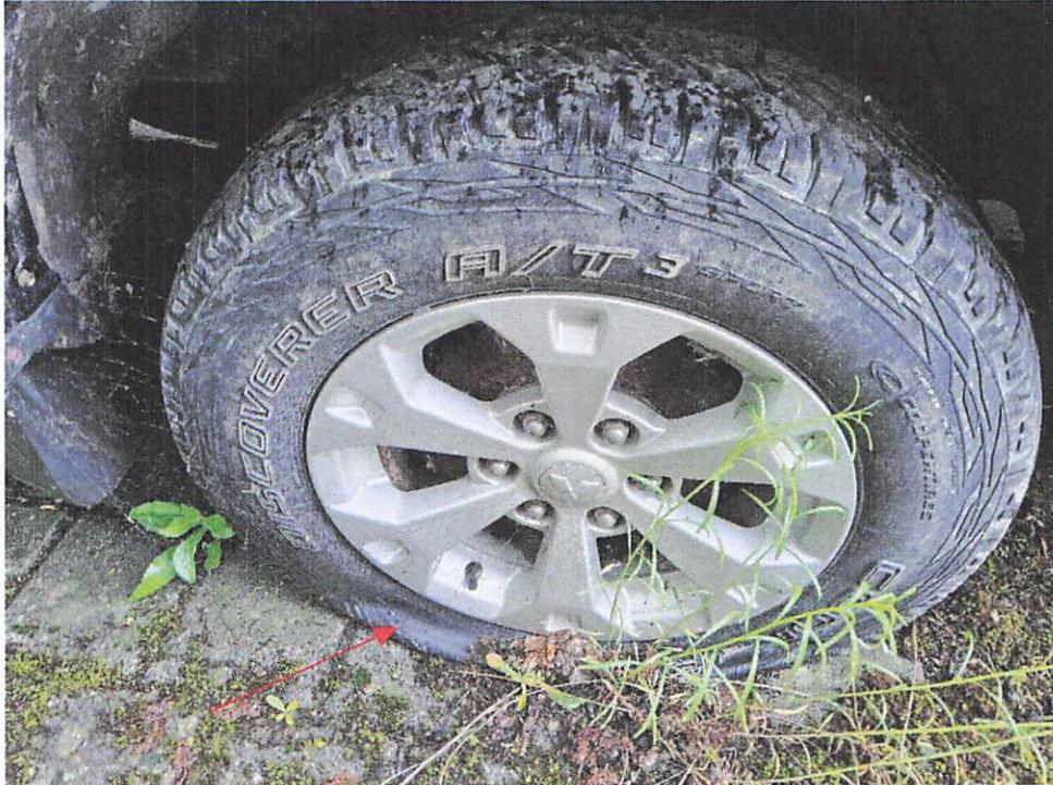
Bild 19 : 4 Neue Reifen erforderlich / Standplatten rechts vorne und hinten
