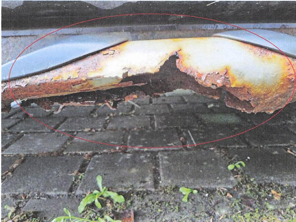
Bild 15 : Seitliche Trittstufen durchgerostet
