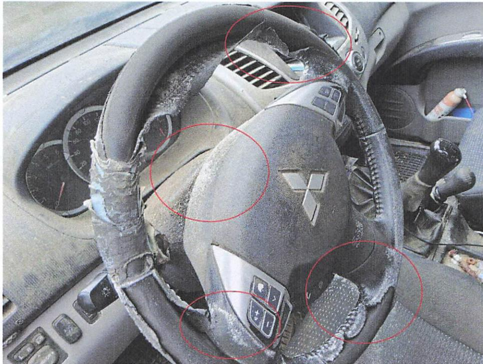
Bild 11 : Lenkrad verschrammt / Schimmelbildung
