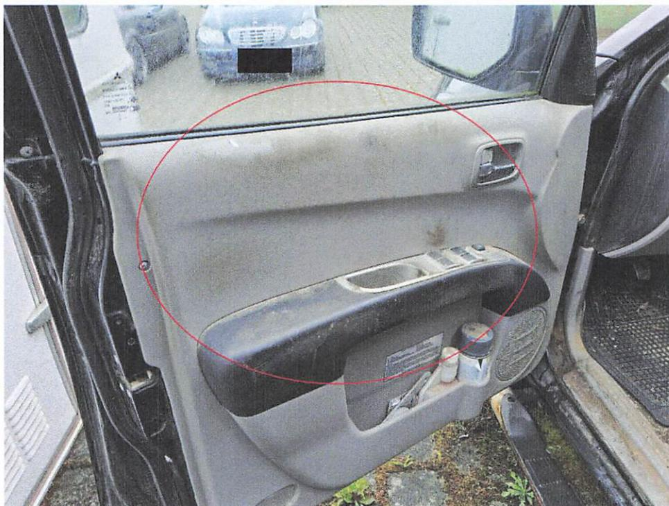
Bild 12 : Türverkleidungen vorne und hinten verschmutzt / Schimmelbildung
