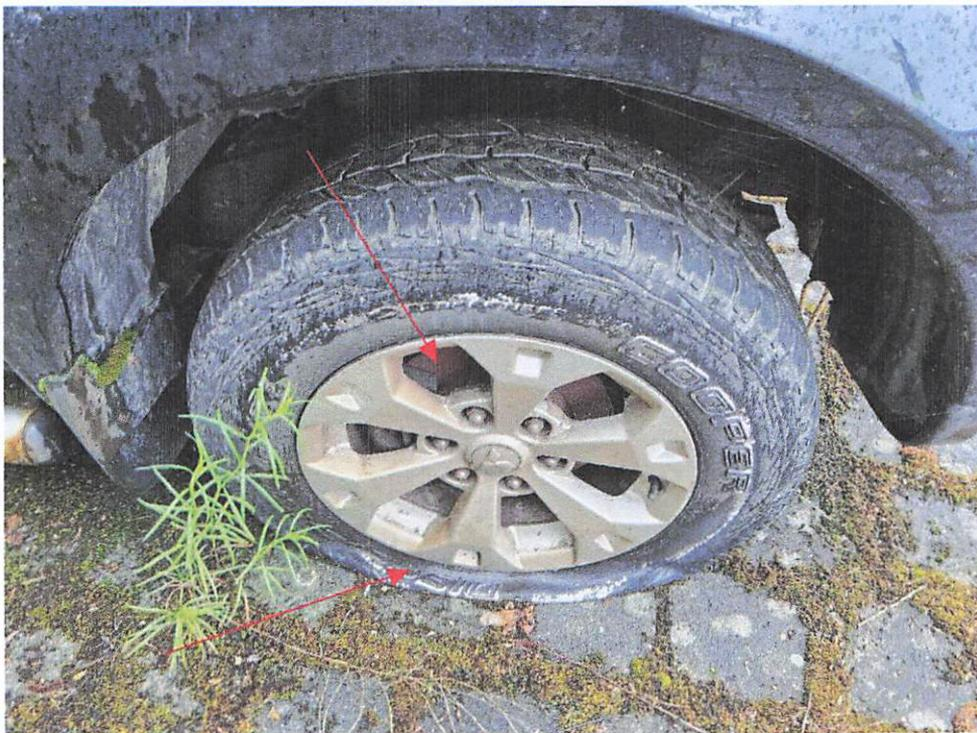
Bild 18 : 4 Neue Reifen erforderlich / Standplatten rechts vorne und hinten
