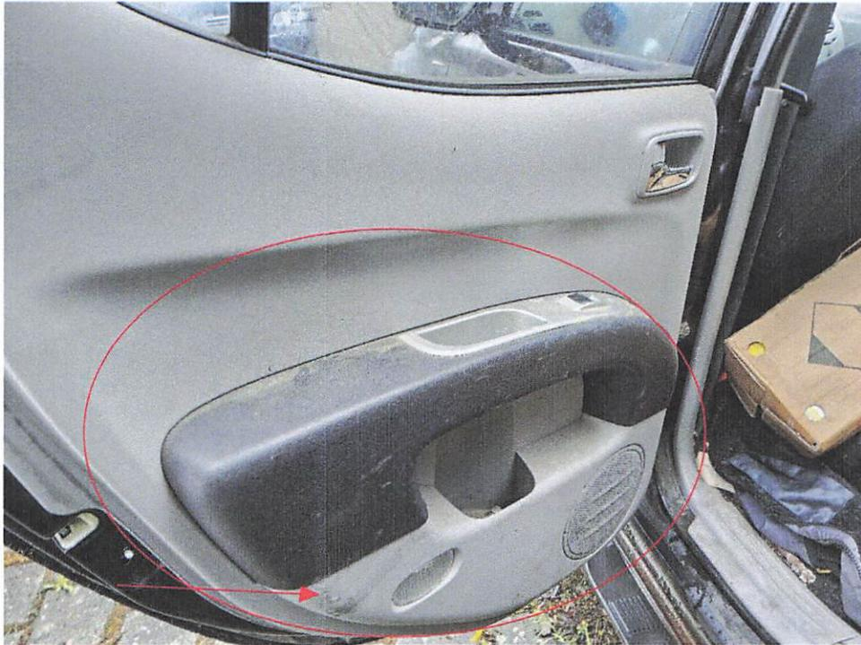
Bild 13 : Türverkleidungen vorne und hinten verschmutzt / Schimmelbildung
