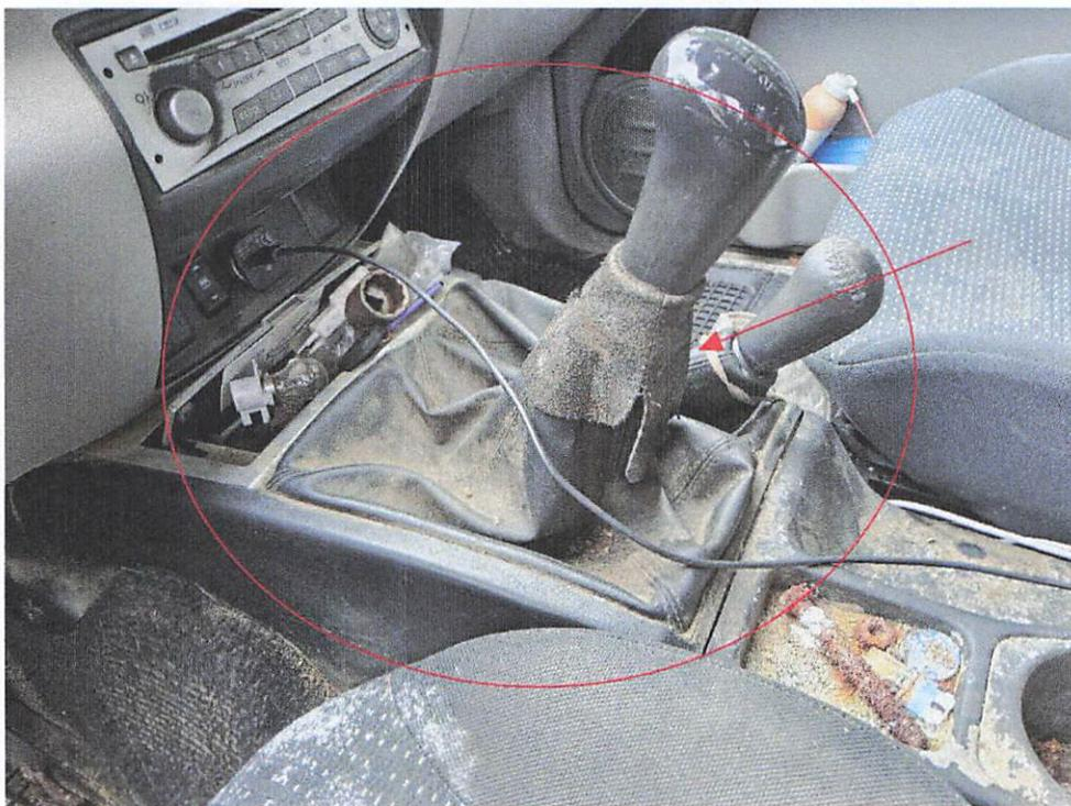
Bild 10 : Schaltknopf verschlissen / Schimmelbildung
