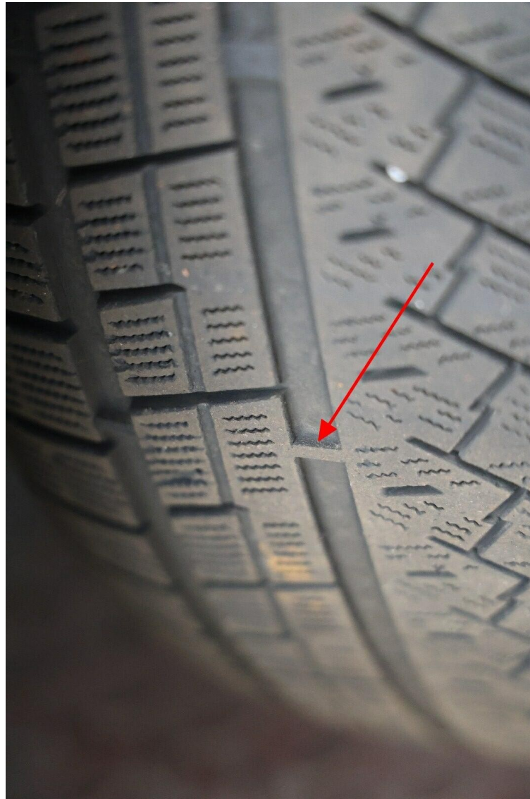
Bild 7 : Reifen vorne Profiltiefe für Winterbetrieb nicht ausreichend
