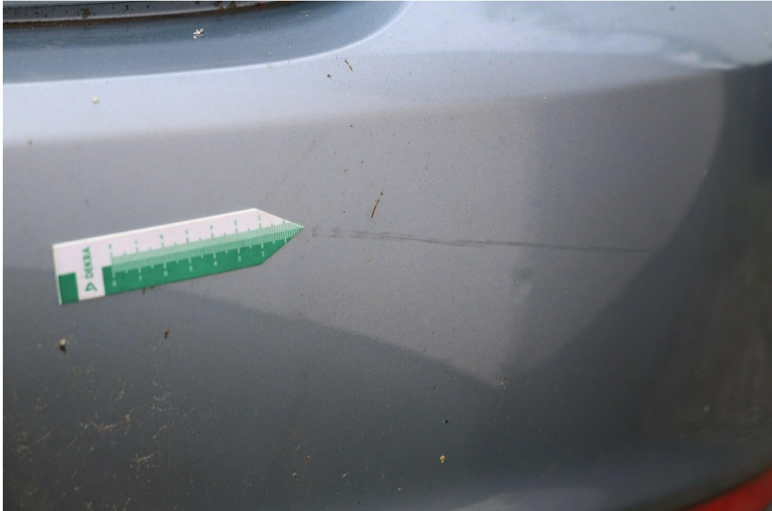
Bild 21 : Stoßfängerverkleidung rechtsseitig partiell verschrammt
