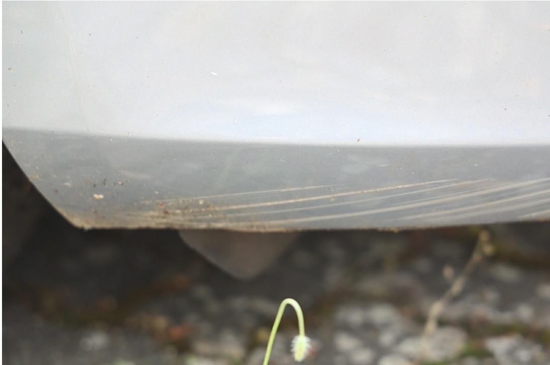
Bild 15 : Stoßfängerverkleidung vorne rechts unten verschrammt
