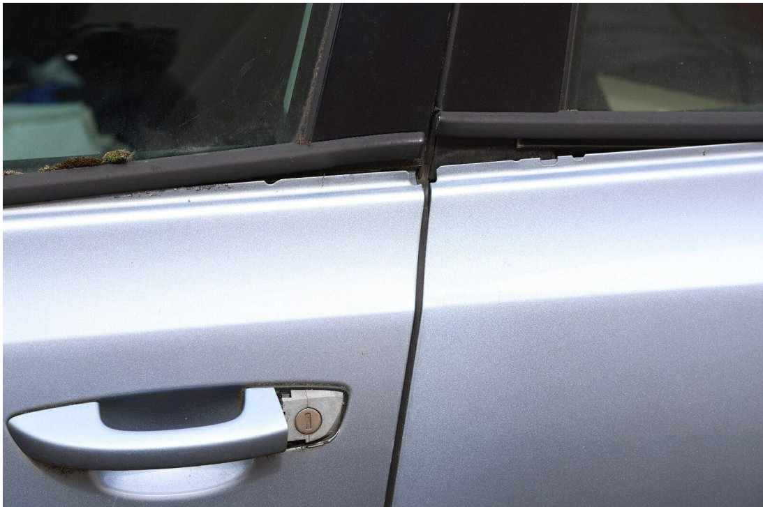
Bild 10 : Schachtleiste linksseitig lose
