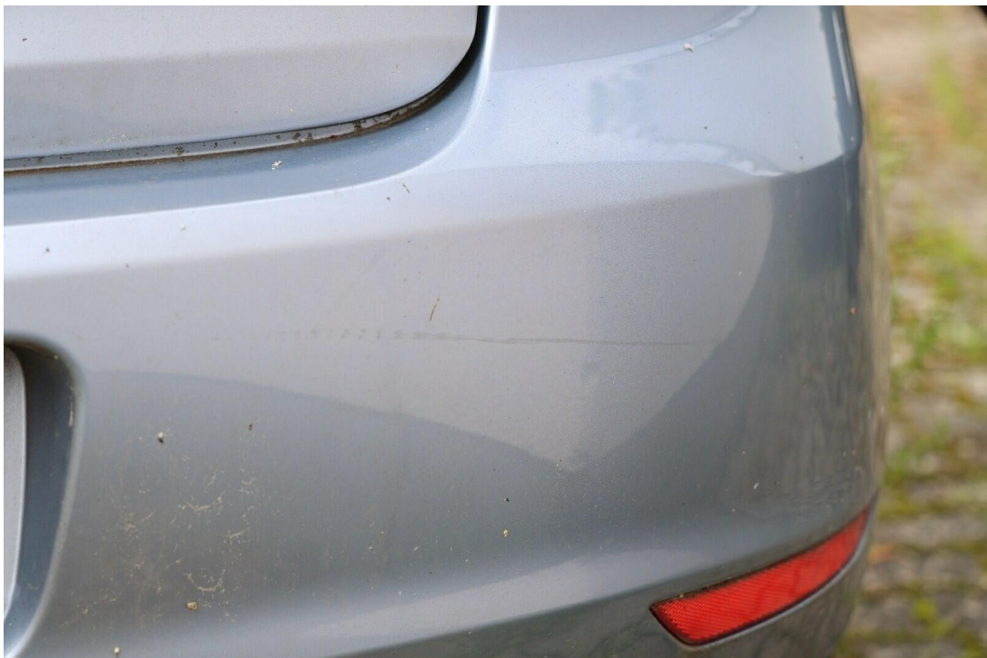
Bild 20 : Stoßfängerverkleidung rechtsseitig partiell verschrammt
