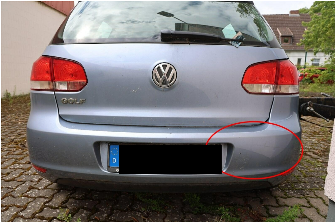
Bild 19 : Stoßfängerverkleidung rechtsseitig partiell verschrammt
