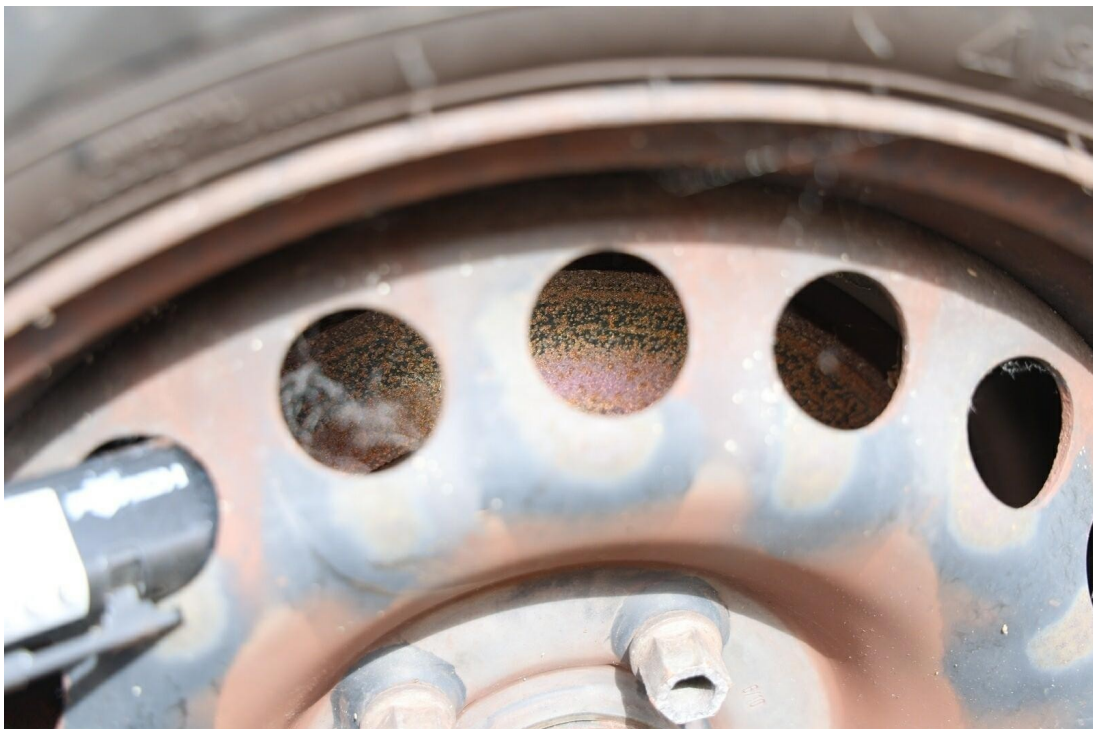
Bild 14 : Bremsscheibe hinten korrodiert
