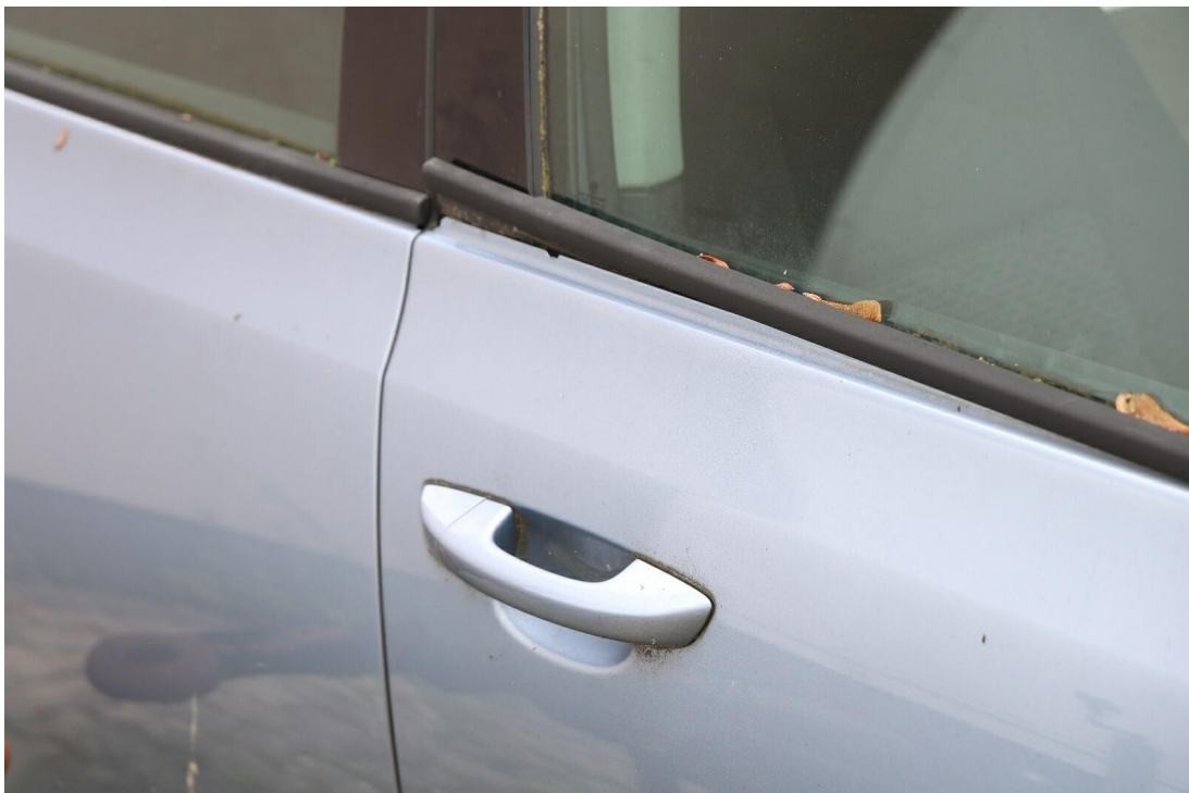
Bild 16 : Schachtleiste rechtsseitig lose
