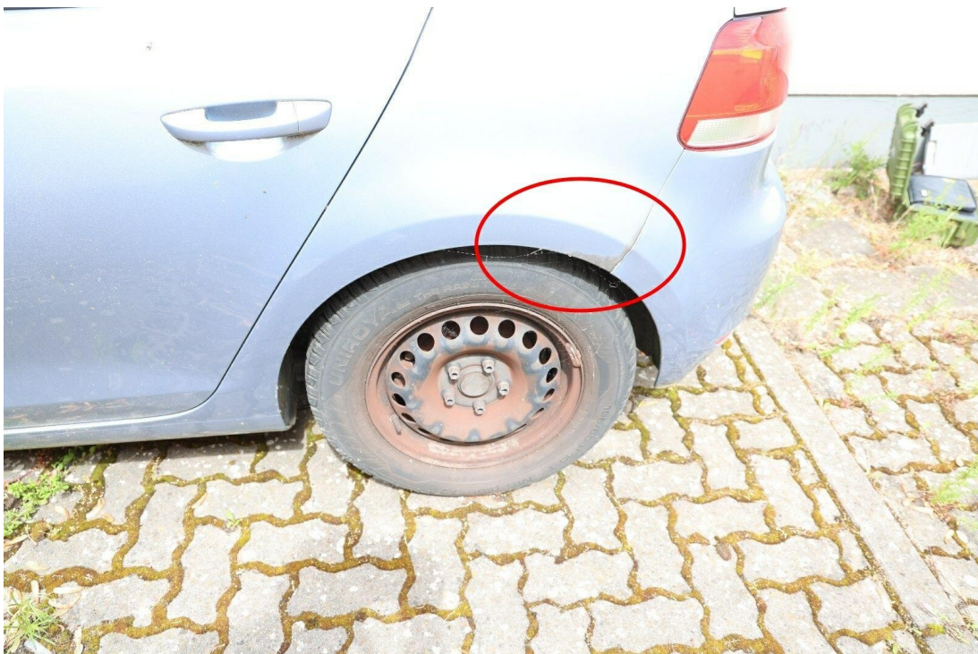
Bild 12 : Seitenwand hinten links leicht eingedrückt passungsgenau Übergang Stoßfängerverkleidung
