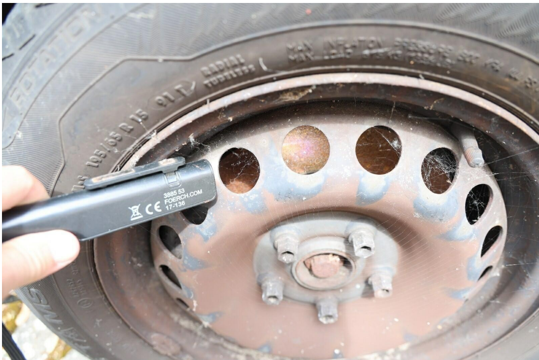
Bild 8 : Bremsscheibe vorne korrodiert
