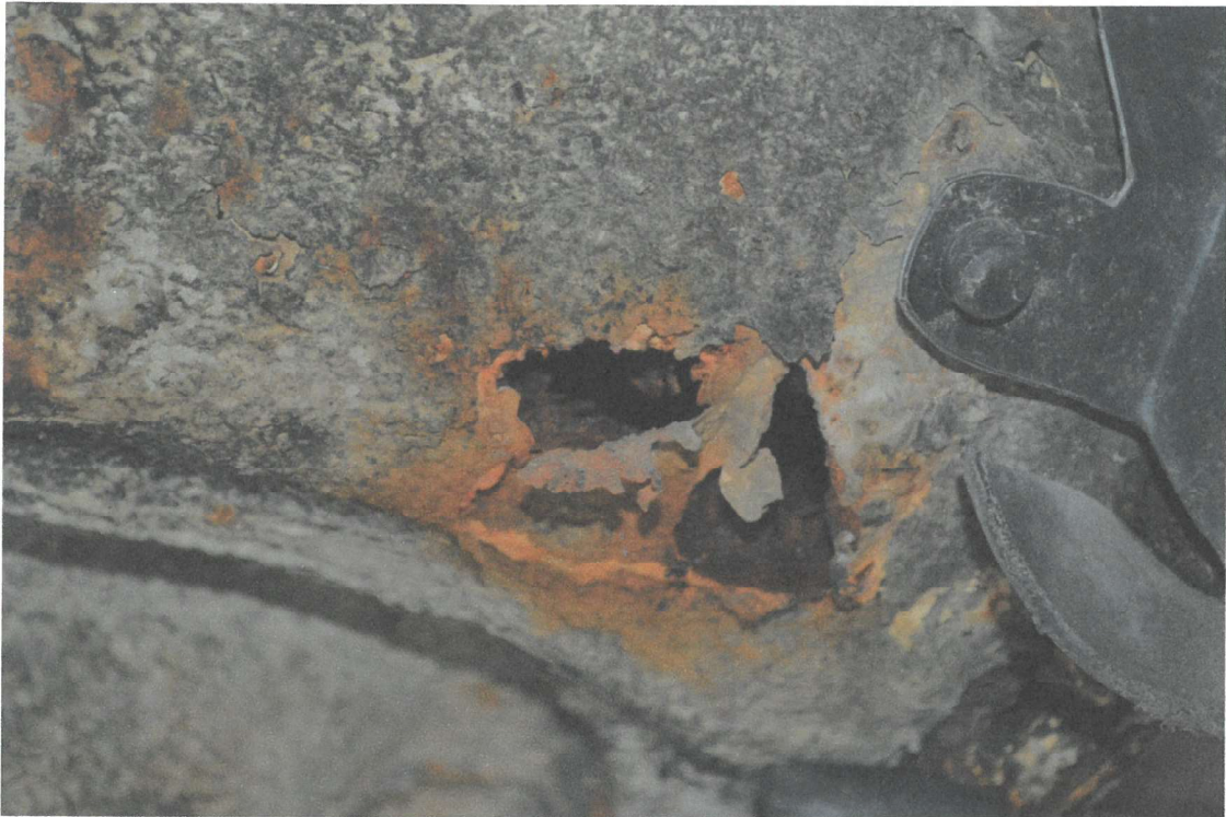
Bild 14: Durchrostung Radkasten vorne links
