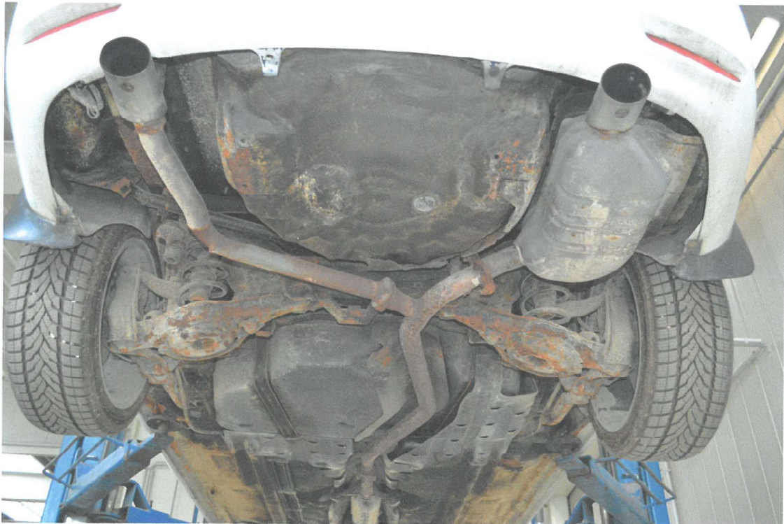
Bild 10: Quer-, Lenkslenker links hinten
