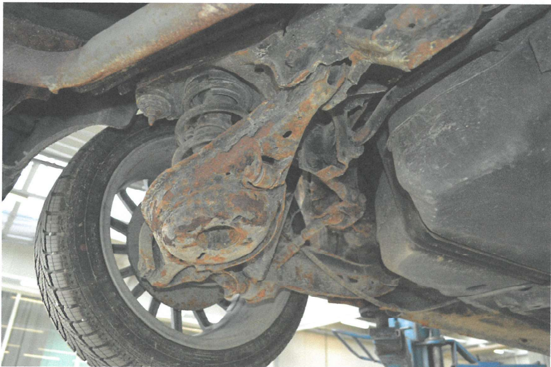
Bild 10: Quer-, Lenkslenker links hinten
