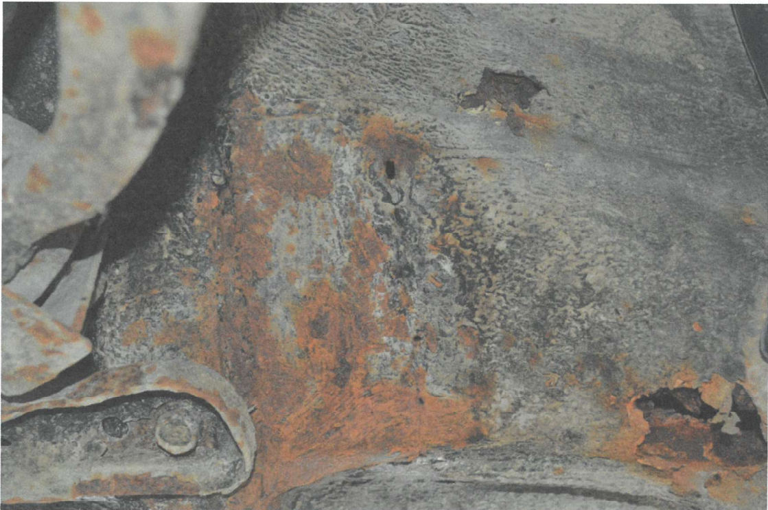
Bild 14: Durchrostung Radkasten vorne links
