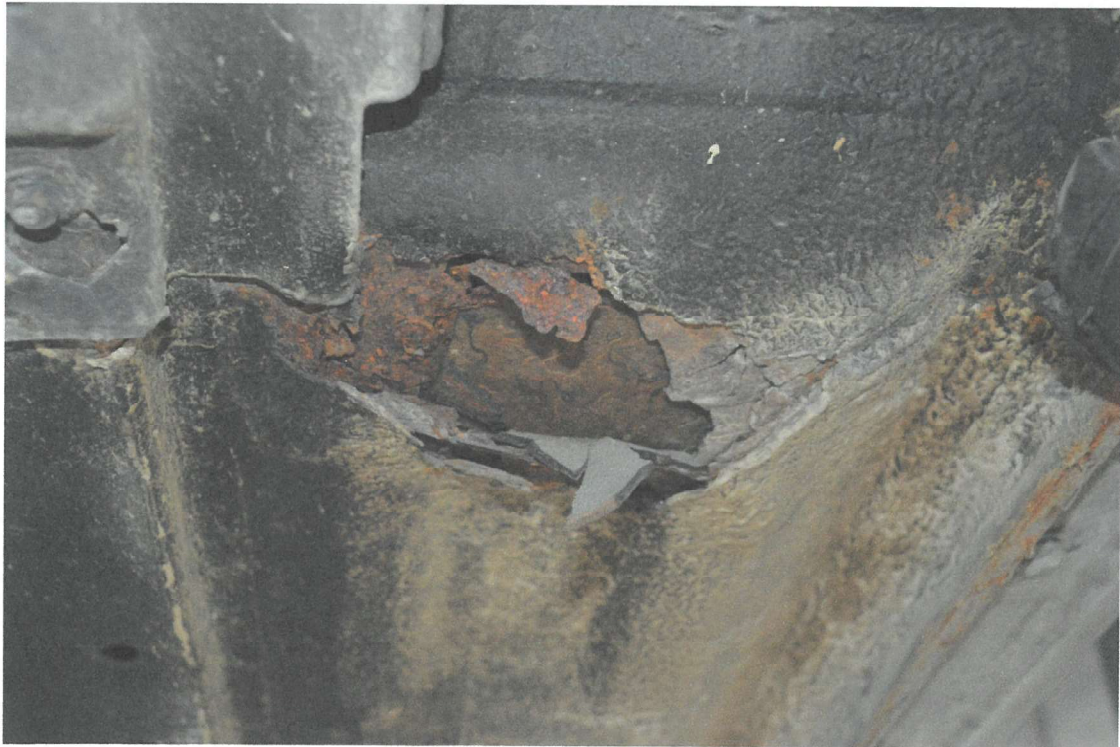
Bild 12: Handflächen große Durchrostung, Boden - mittig
