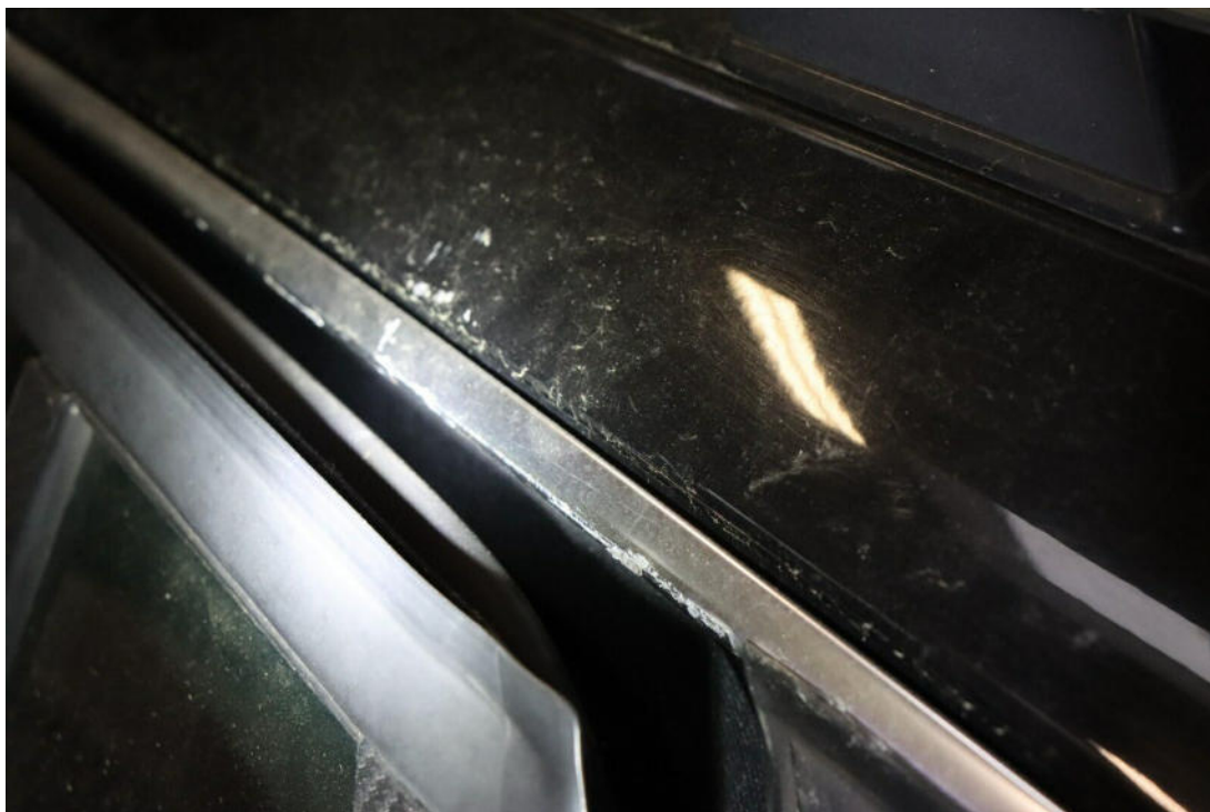
Bild 34 : Zierleiste Dach Chromleiste links verschrammt
