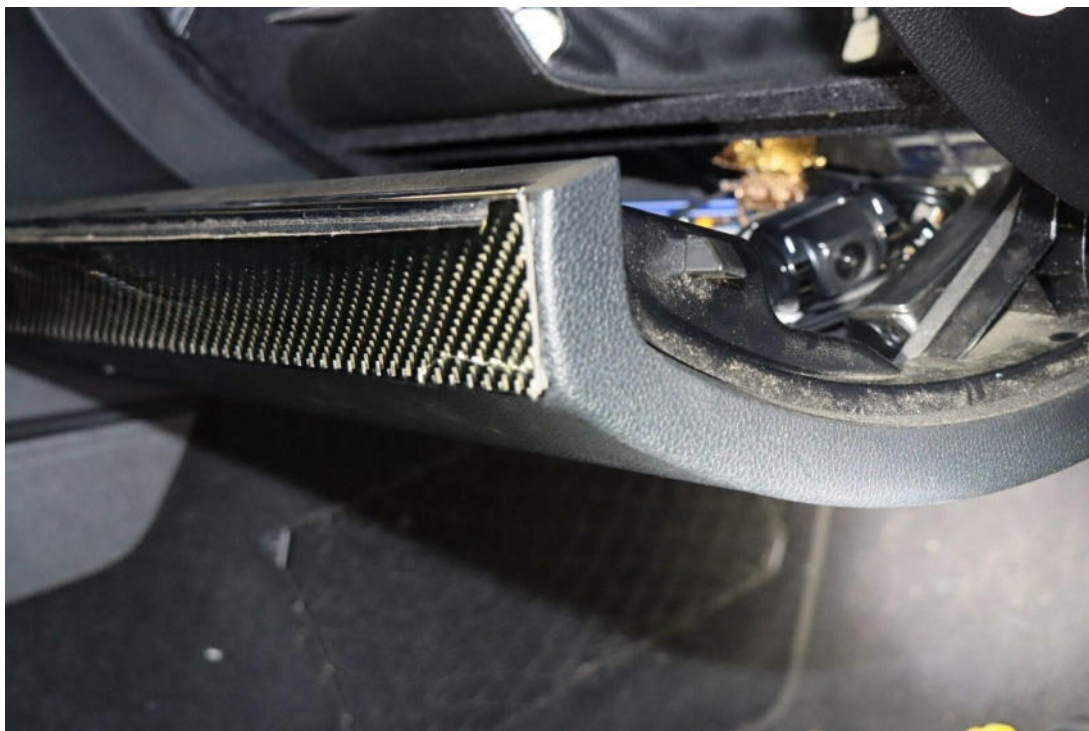
Bild 16 : Handschufach Dekorleiste gebrochen
