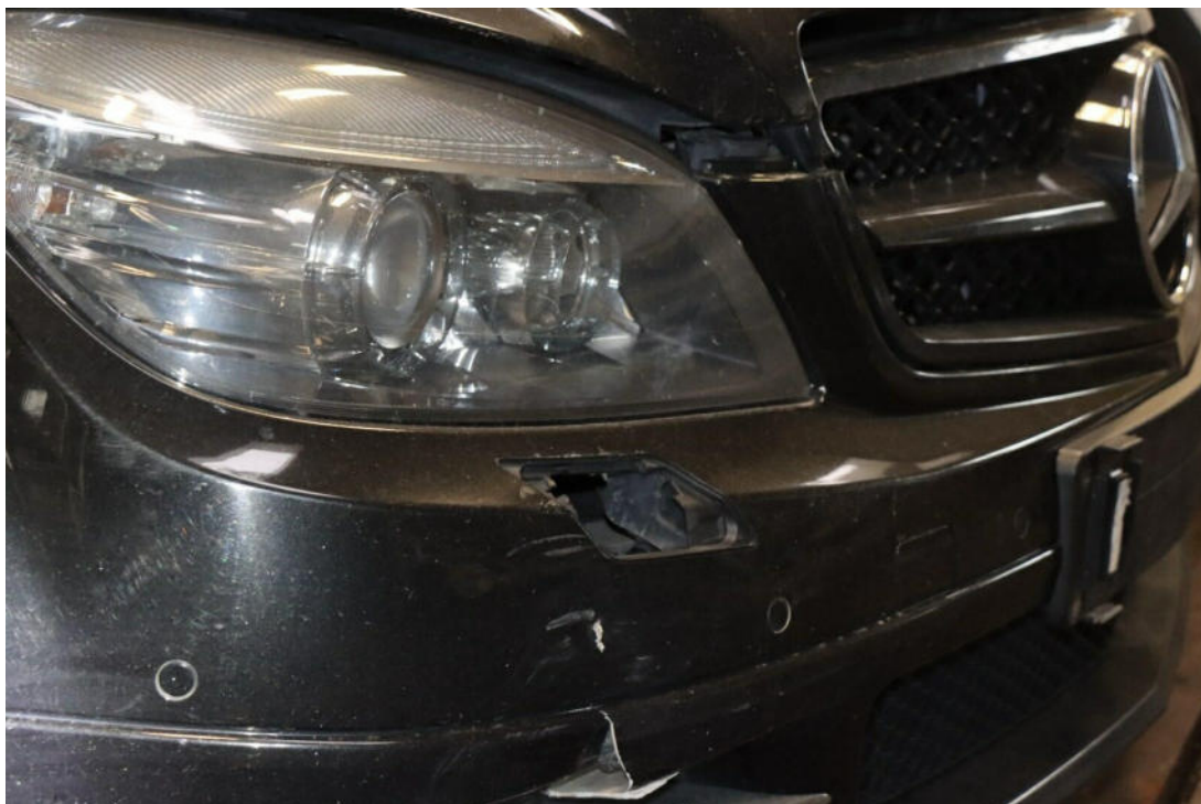
Bild 15 : Abdeckung Scheinwerferreinigungsanlage rechts fehlt
