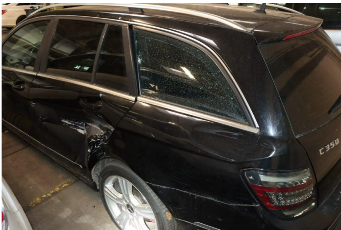
Bild 30 : Seitenwand hinten links großflächig deformiert
