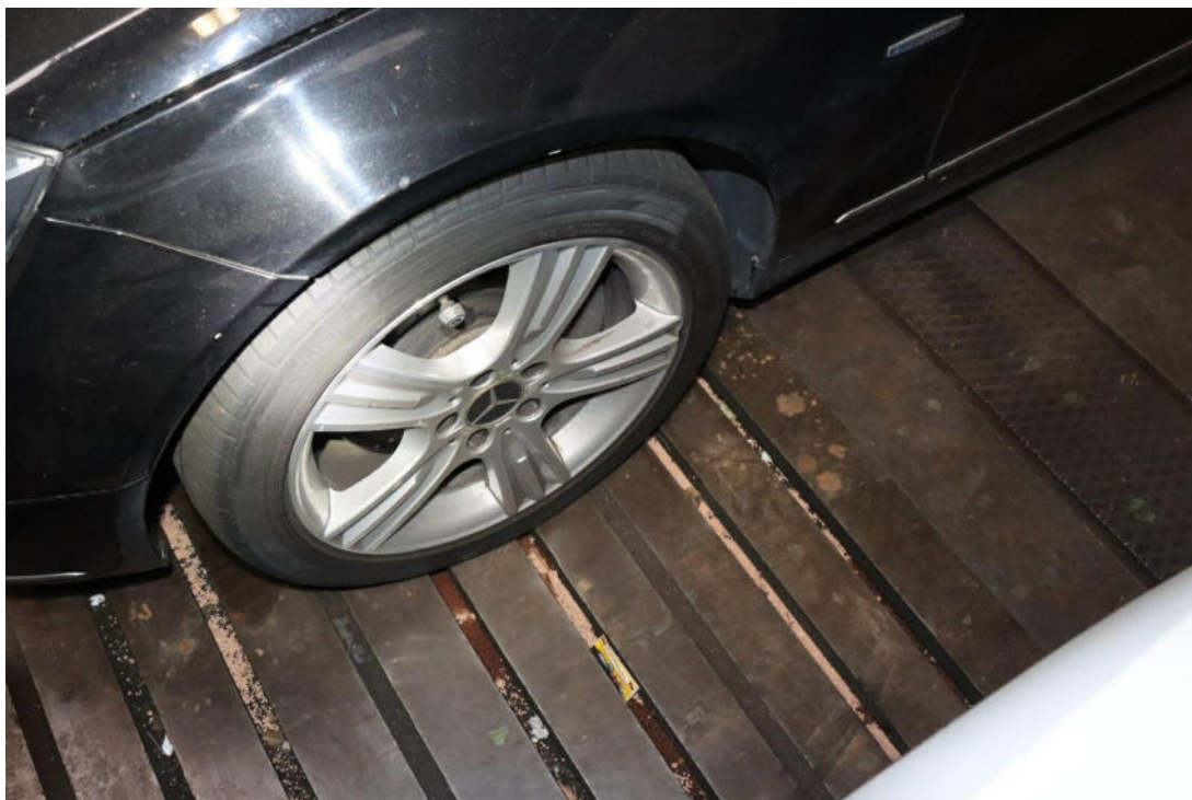
Bild 38 : Leichtmetallfelge vorne links Felgenhorn verschrammt
