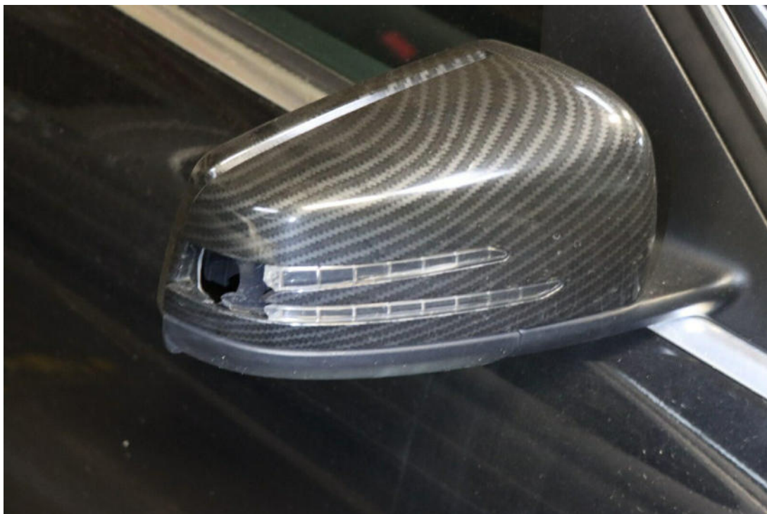
Bild 23 : Außenspiegel rechts Gehäuse gebrochen inkl. Fahrtrichtungsanzeiger seitlich rechts
