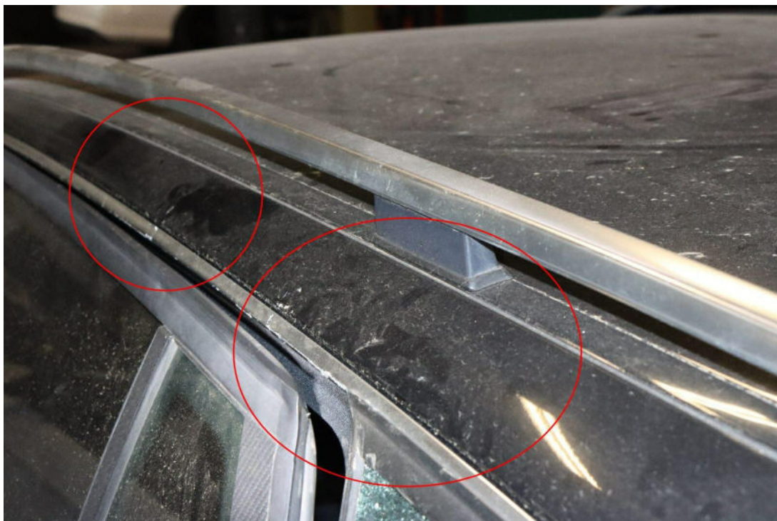
Bild 32 : Dachholm links mehrfach eingedellt
