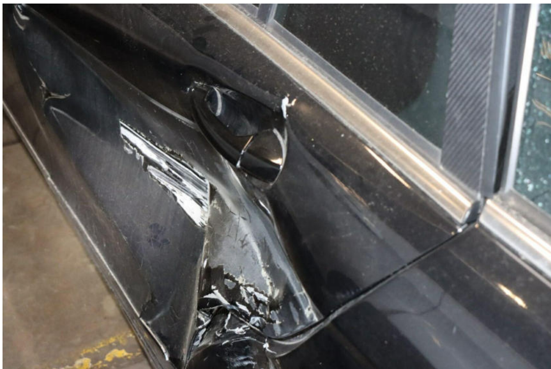
Bild 35 : Fondtür links großflächig eingedellt
