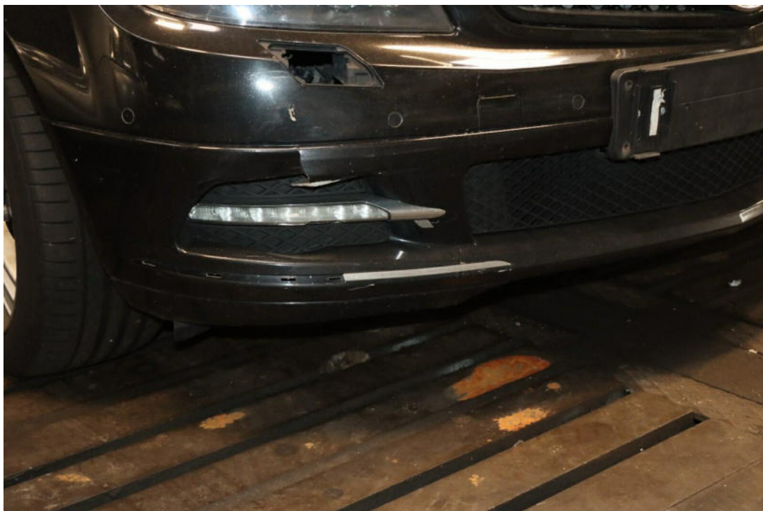
Bild 9 : Tagfahrleuchte Glas gebrochen
