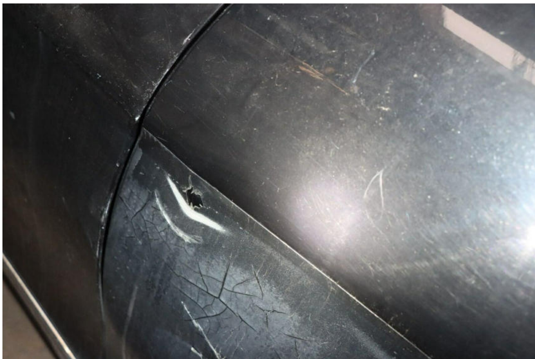
Bild 36 : Fondtür links großflächig eingedellt
