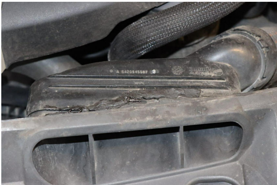
Bild 20 : Ansaugschlauch / Luftführung im Bereich Schloßträger lose, teilweise geklebt
