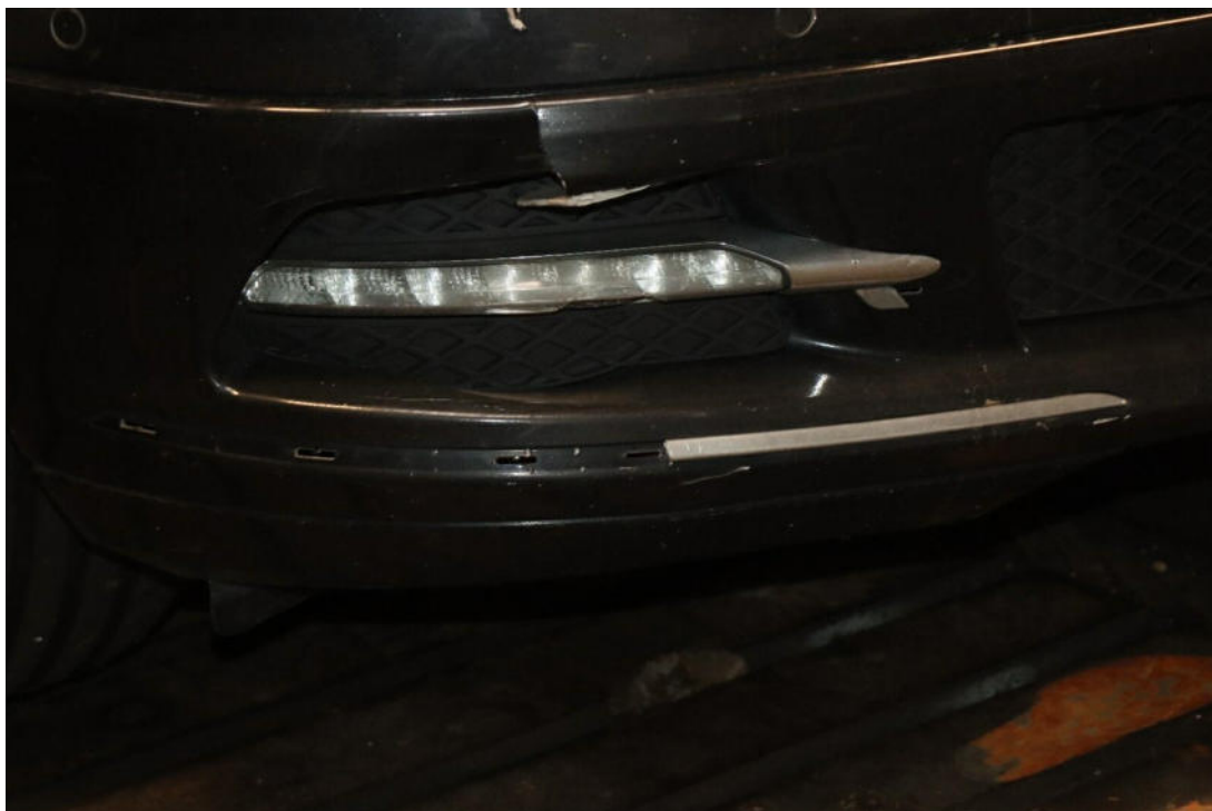
Bild 13 : Stoßfängerverkleidung Chromleiste vorne rechts unten gebrochen
