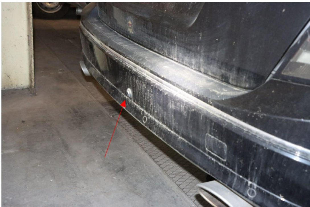
Bild 27 : Stoßfängerverkleidung Kamera in Stoßfängerverkleidung nachgerüstet, Funktion konnte nicht überprüft werden
