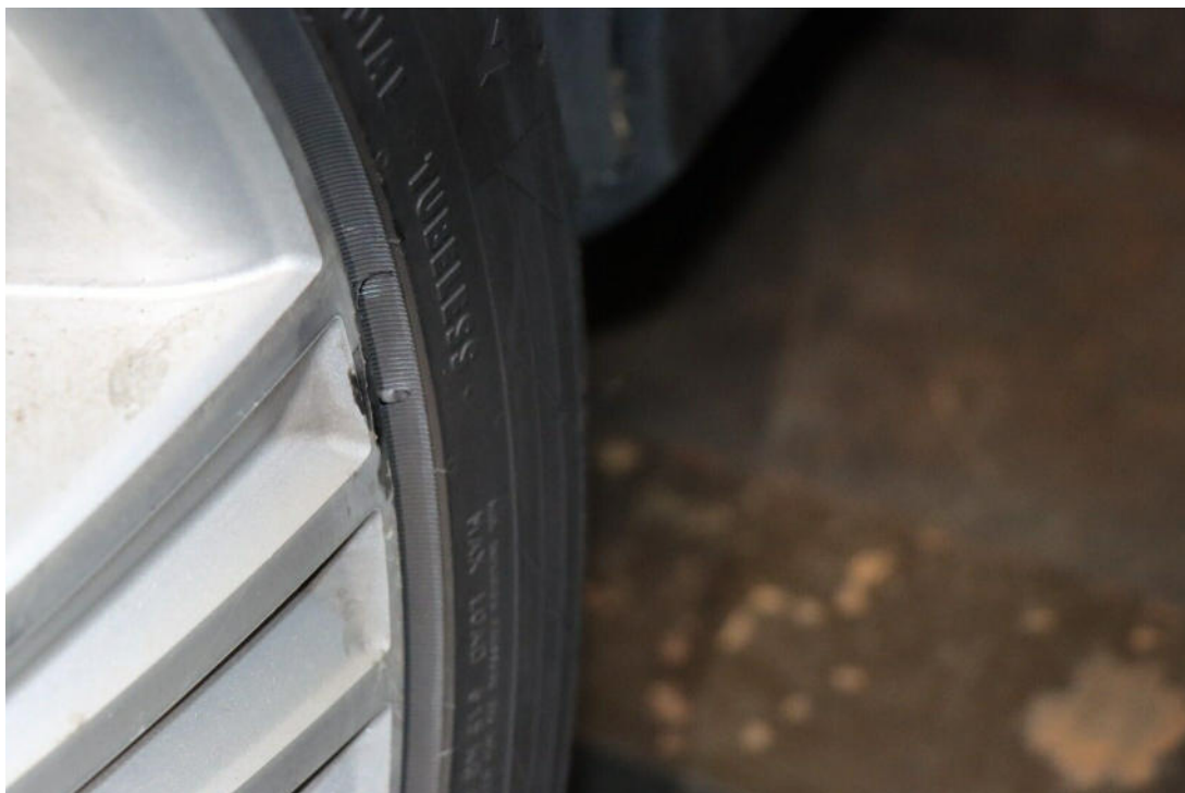
Bild 39 : Leichtmetallfelge vorne links Felgenhorn verschrammt
