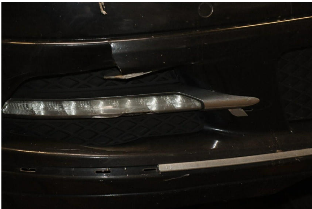
Bild 10 : Tagfahrleuchte Glas gebrochen
