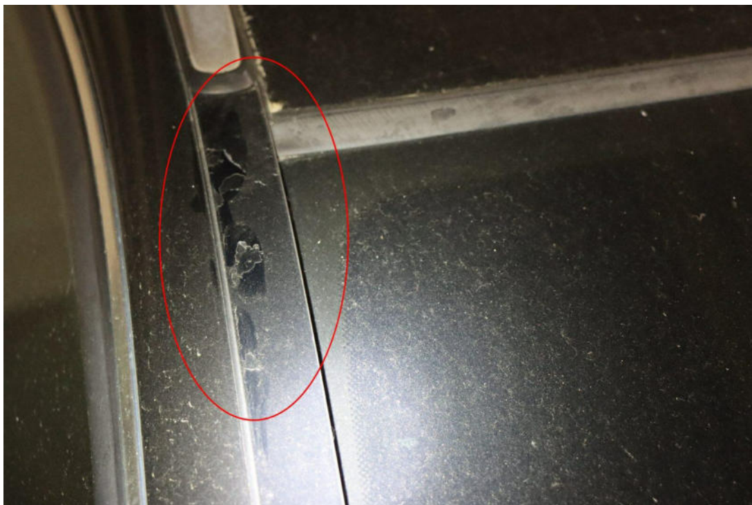
Bild 22 : Abdeckung Windlauf rechts Lackabplatzer
