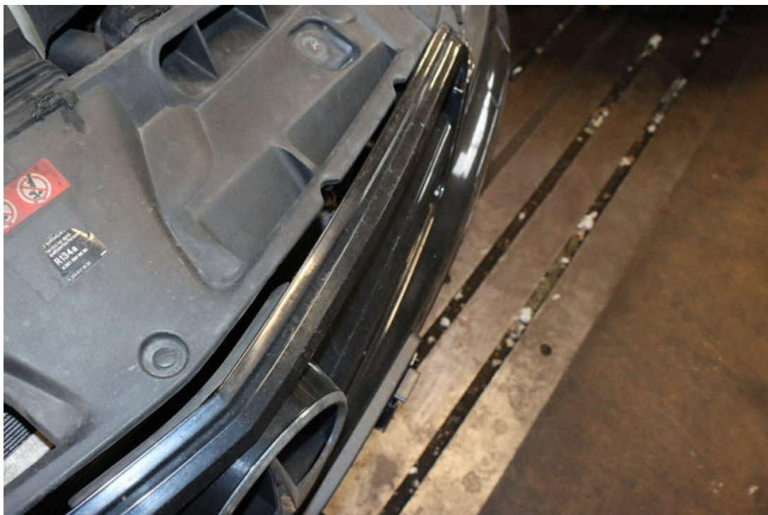
Bild 19 : Kühlergrill lose, prüfen Schadenerweiterung möglich
