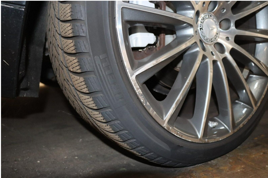
Bild 17 : Leichtmetallfelge hinten links im Bereich des Felgenhorn materialabtragend verschrammt
