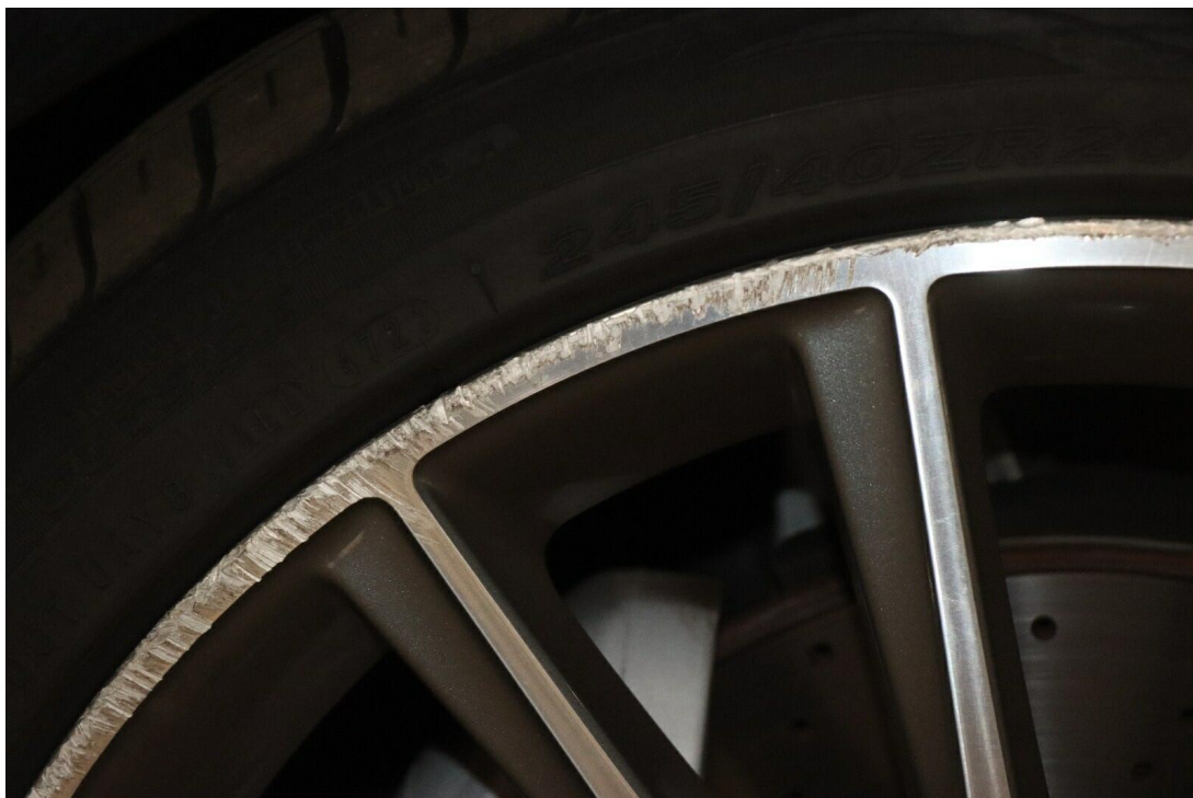
Bild 15 : Leichtmetallfelge vorne rechts im Bereich des Felgenhorn materialabtragend verschrammt
