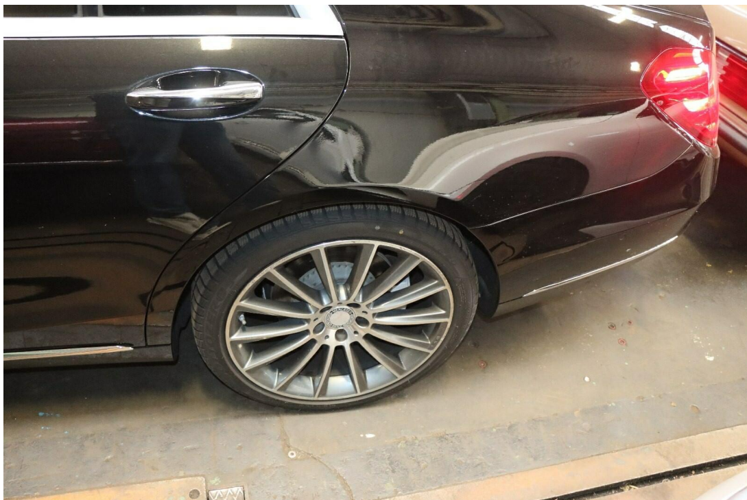
Bild 11 : Leichtmetallfelge hinten links im Bereich des Felgenhorn materialabtragend verschrammt
