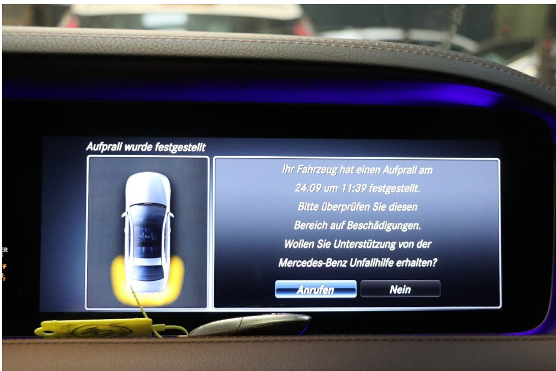
Bild 18 : Fehlerspeicher Prüfen - Fehlermeldung Auffahrkollision - Schadenerweiterung möglich
