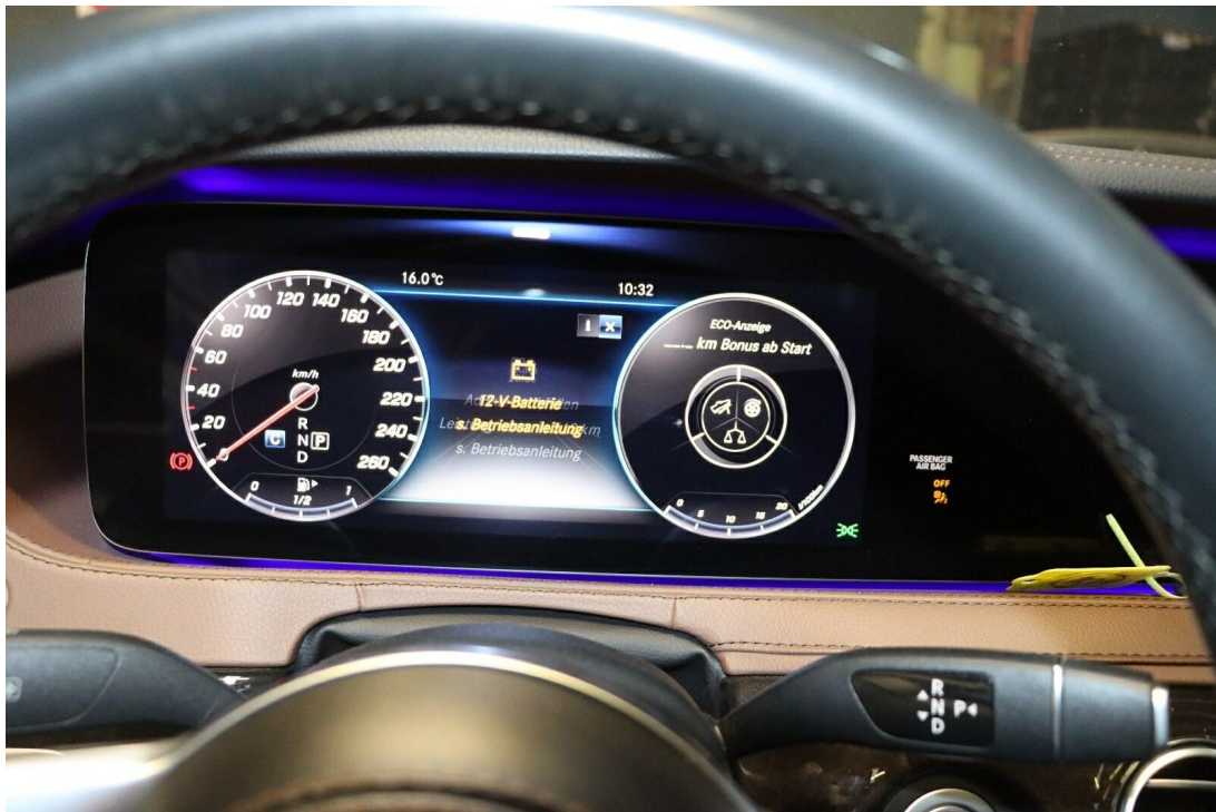
Bild 7 : Batterie(n) tiefentladen Starten nur mit Booster möglich
