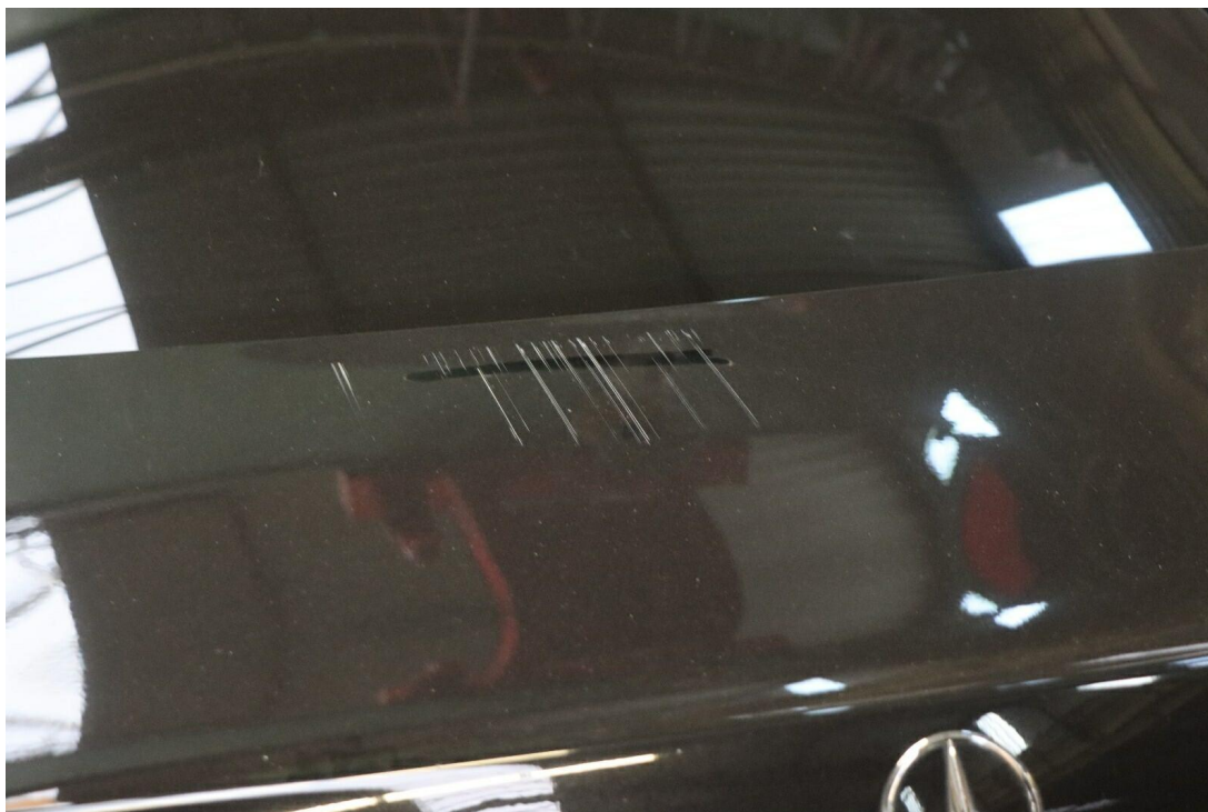
Bild 20 : Heckdeckel streifend verschrammt
