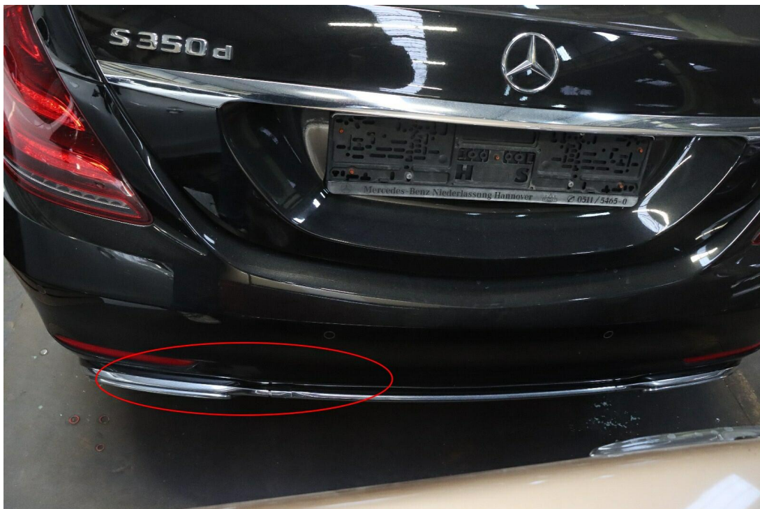
Bild 21 : Stoßfängerverkleidung hinten Zierleiste deformiert
