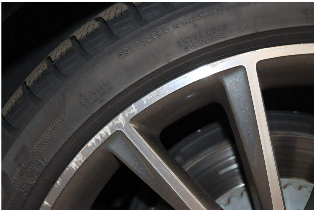
Bild 13 : Leichtmetallfelge hinten links im Bereich des Felgenhorn materialabtragend verschrammt
