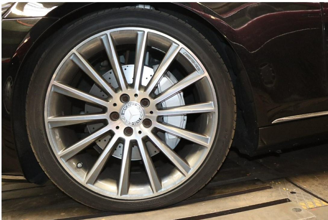
Bild 9 : Leichtmetallfelge vorne links im Bereich des Felgenhorn materialabtragend verschrammt
