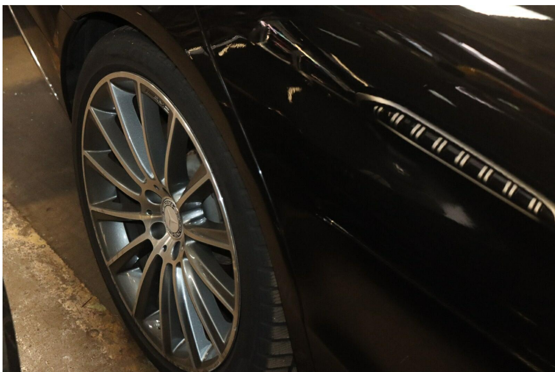
Bild 16 : Leichtmetallfelge hinten links im Bereich des Felgenhorn materialabtragend verschrammt
