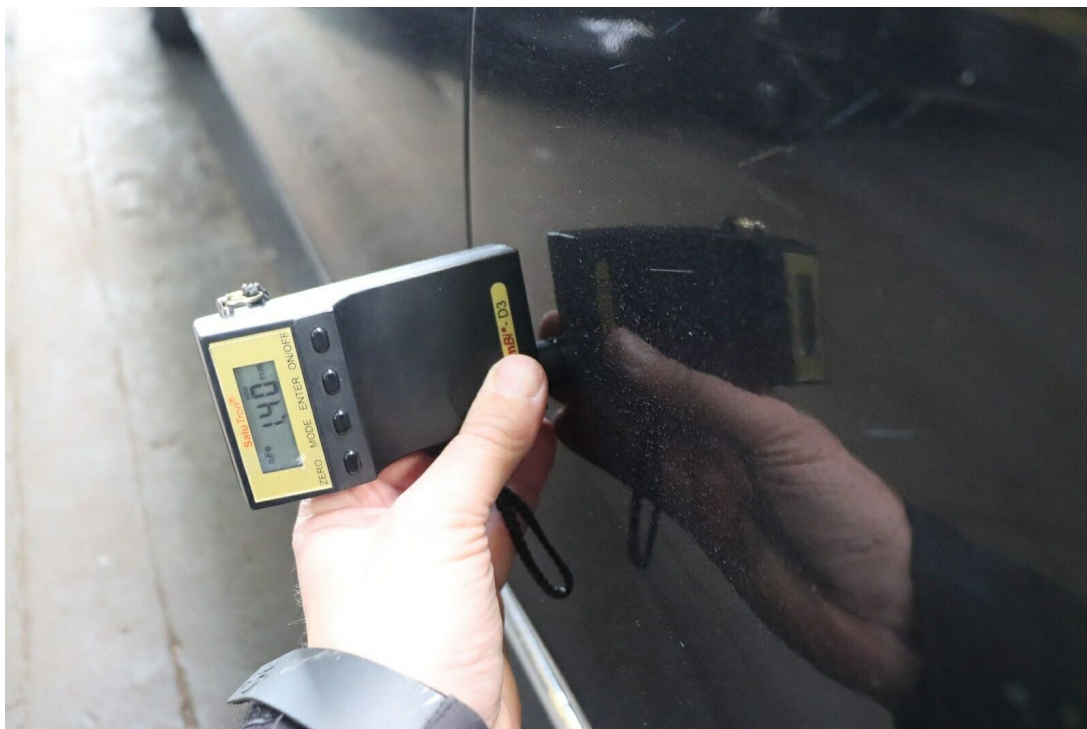
Bild 25 : Lackschichtdicke Kotflügel vorne rechts
