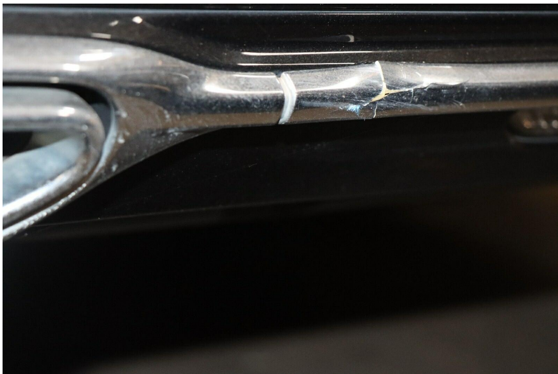
Bild 23 : Stoßfängerverkleidung hinten Zierleiste deformiert
