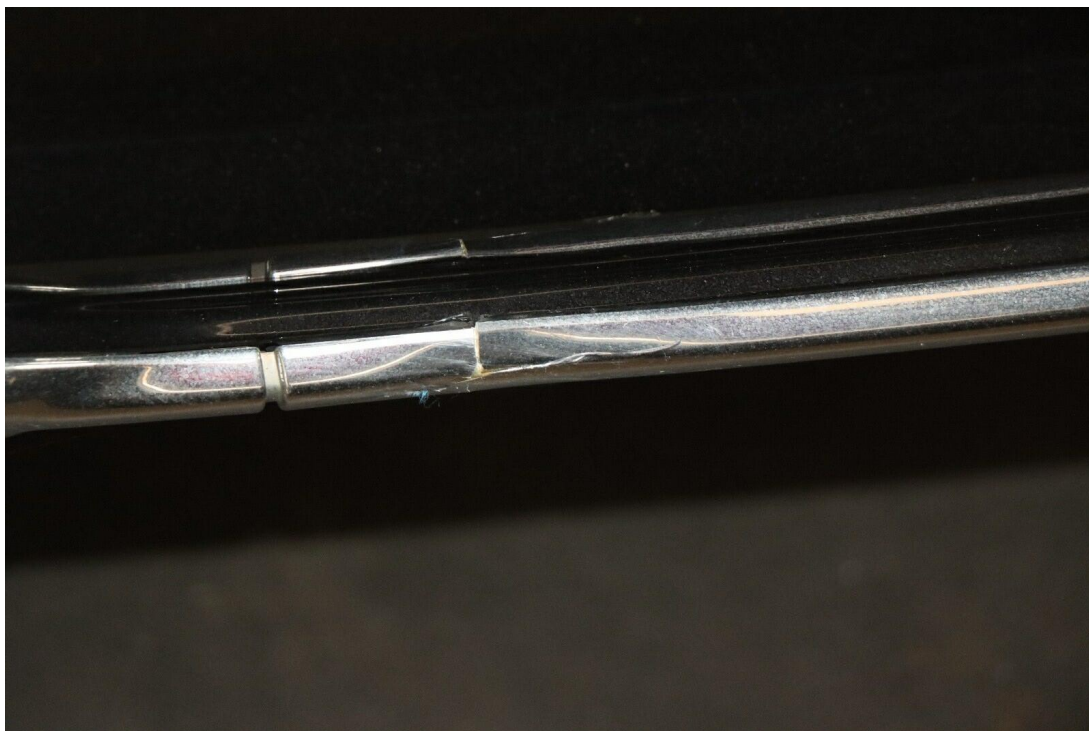
Bild 22 : Stoßfängerverkleidung hinten Zierleiste deformiert
