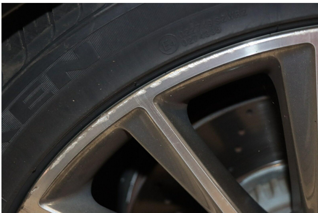
Bild 10 : Leichtmetallfelge vorne links im Bereich des Felgenhorn materialabtragend verschrammt
