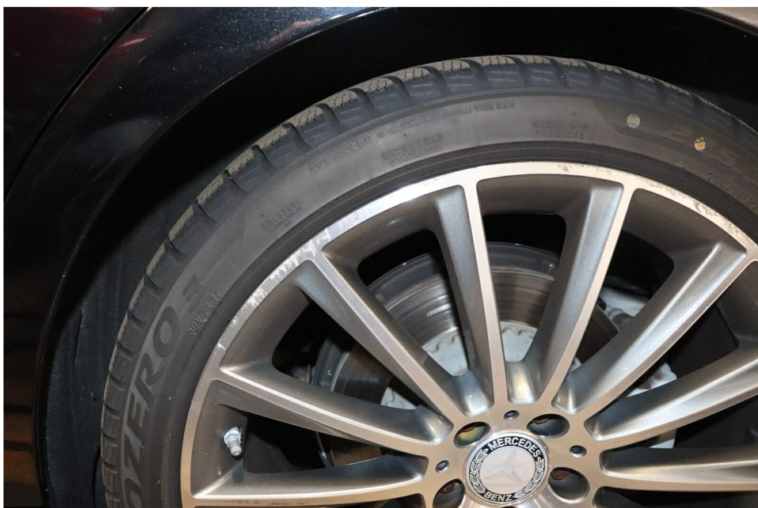
Bild 12 : Leichtmetallfelge hinten links im Bereich des Felgenhorn materialabtragend verschrammt
