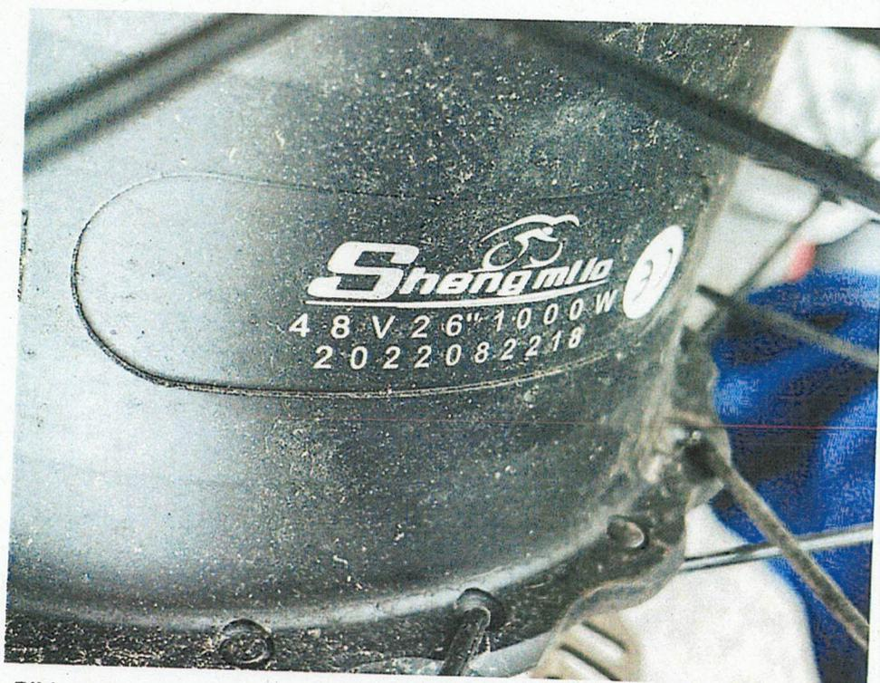
Bild 11: Radnabenmotor hinten
