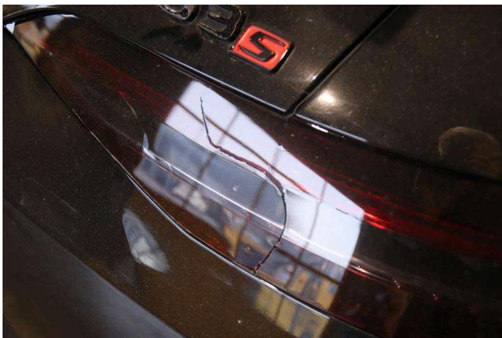
Bild: 6 Rücklicht rechts gebrochen
