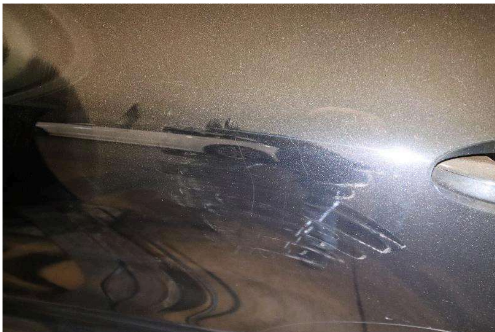
Bild: 18 Tür hinten links verschürft
