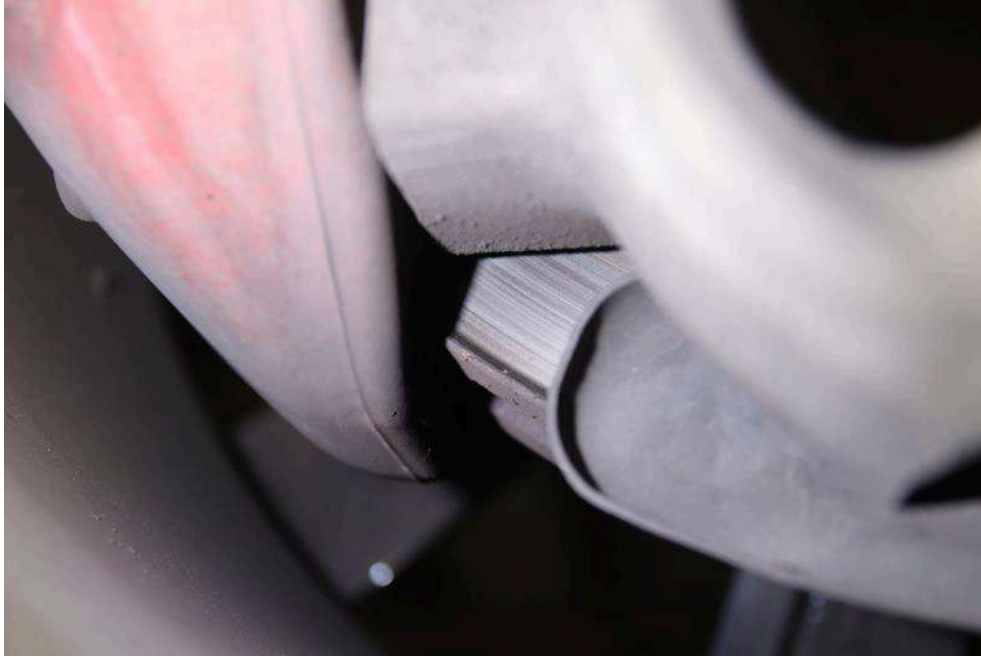
Bild: 45 Bremsscheiben vorne und hinten eingelaufen
