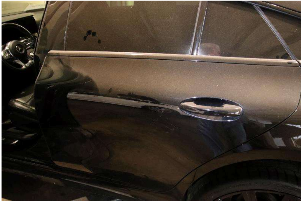
Bild: 17 Tür hinten links verschürft
