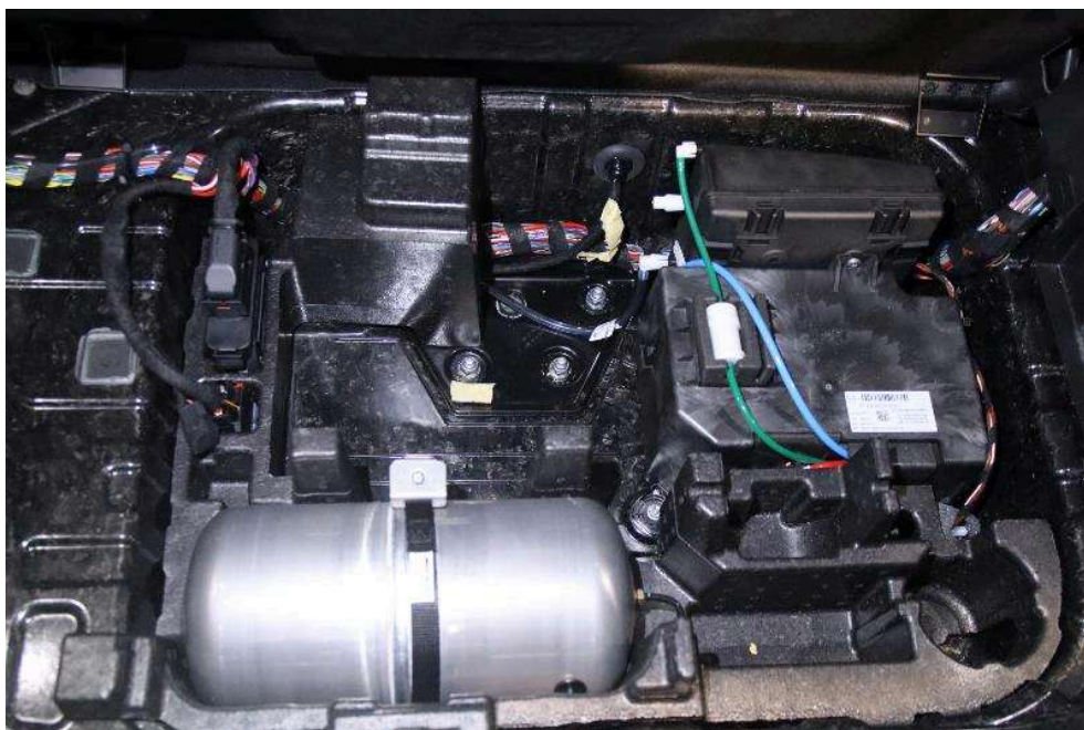
Bild: 28 Ansicht unter Laderaumboden, Flasche Reifendichtmittel und Kompressor fehlen
