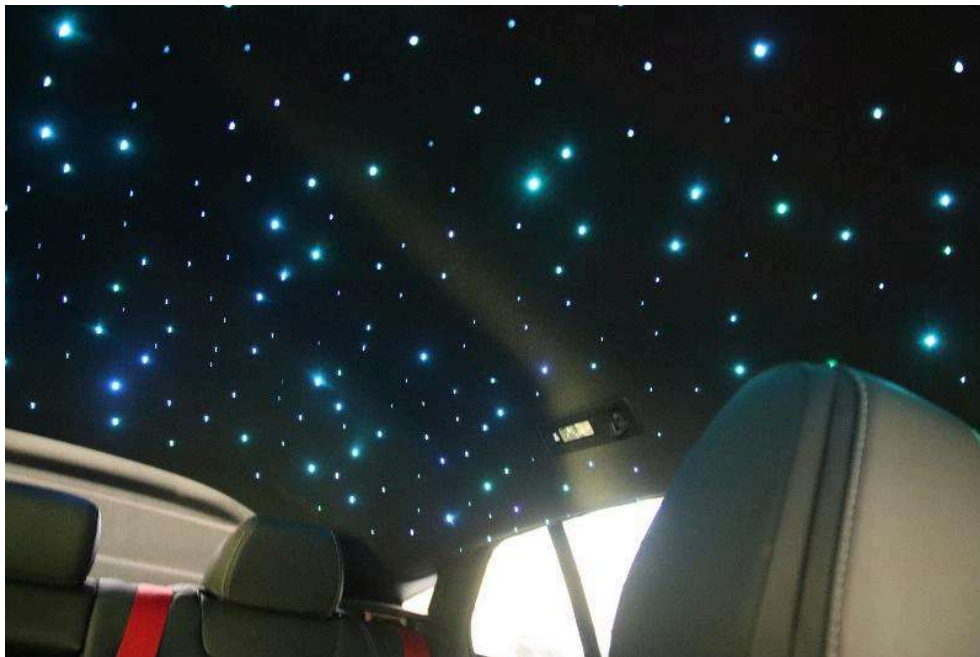
Bild: 27 Fahrzeughimmel zu Sternenhimmel umgebaut, Rückbau nicht möglich wegen Löchern
