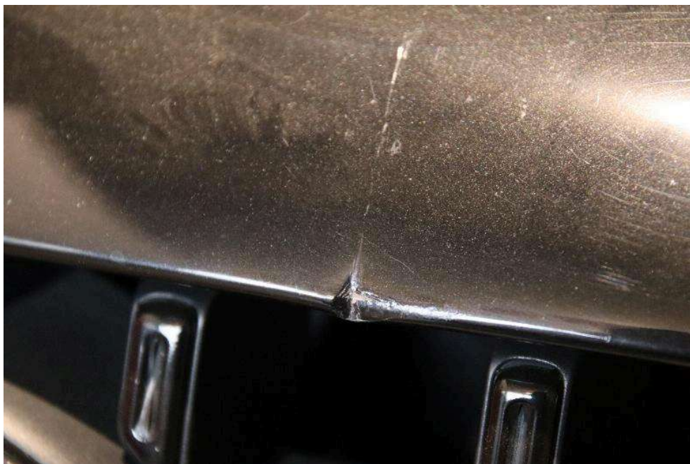
Bild: 15 Stoßfänger vorne plastisch verformt
