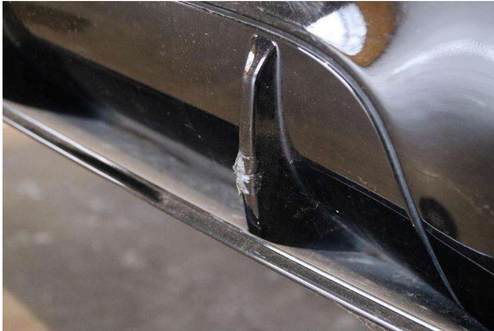
Bild: 13 Heck-Diffusor beschädigt, hoher Materialabtrag
