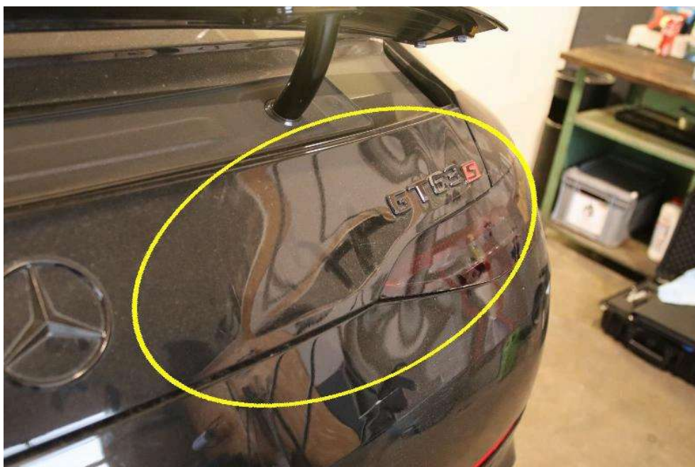
Bild: 8 Heckklappe stark eingedrückt
