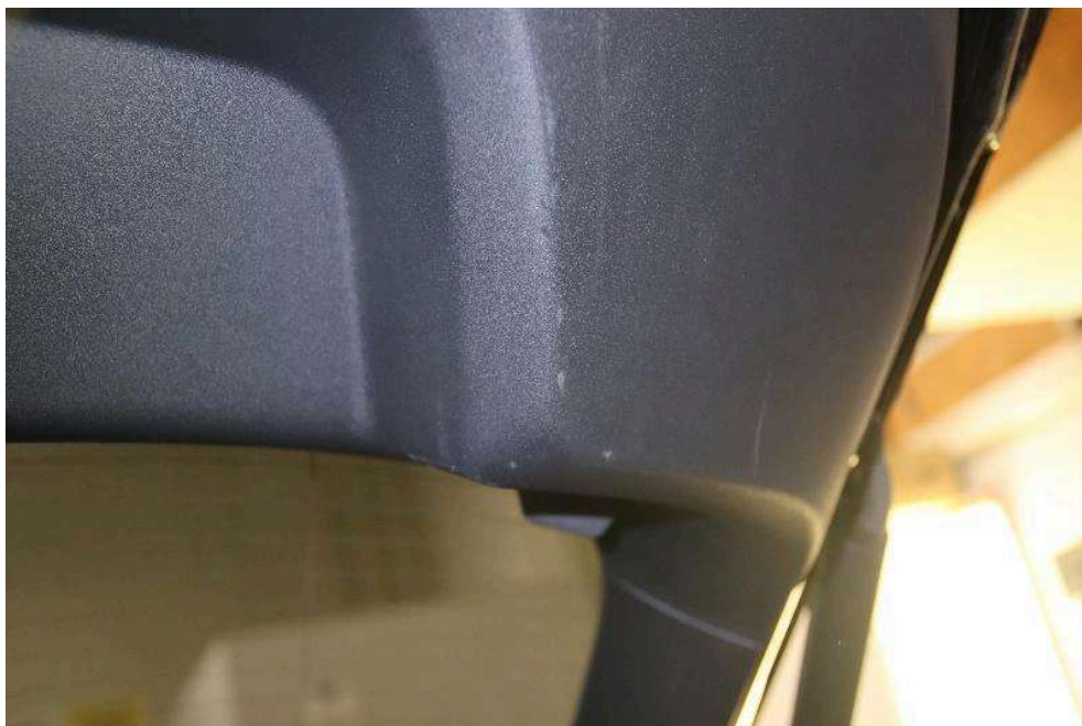
Bild: 32 Heckklappenverkleidung verschürft
