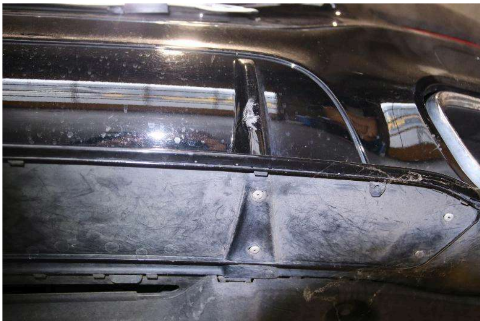
Bild: 14 Heck-Diffusor beschädigt, hoher Materialabtrag
