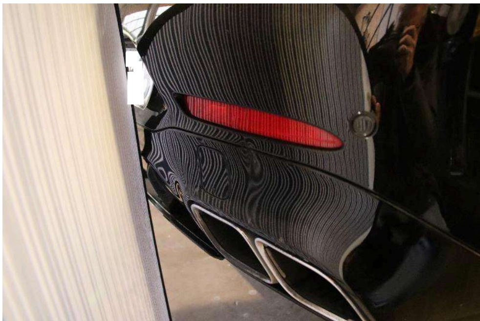
Bild: 10 Heckschürze plastisch verformt, Abgasblende verschoben und verformt
