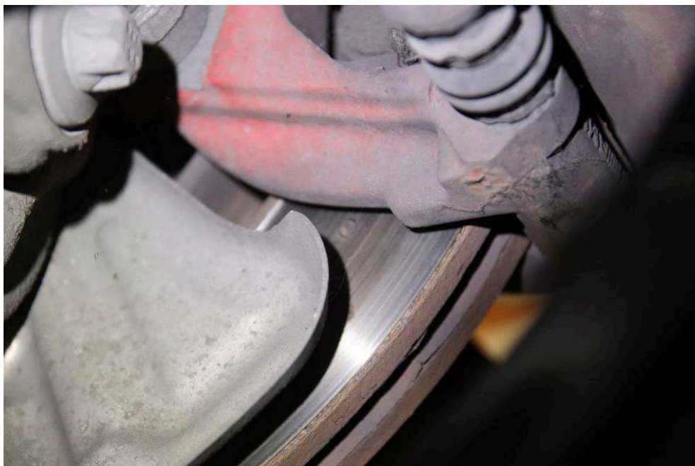
Bild: 44 Bremsscheiben vorne und hinten eingelaufen
