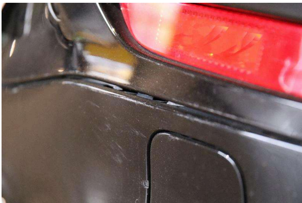
Bild: 12 Heckschürze ausgebrochen
