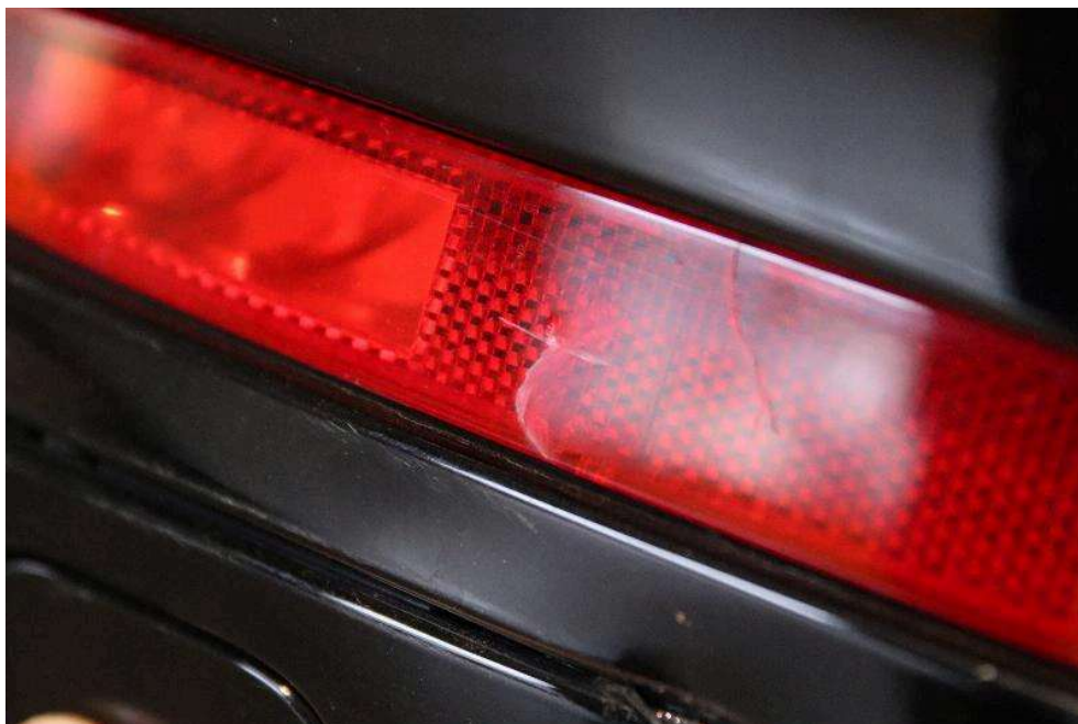
Bild: 11 Reflektor/Nebelschlussleuchte rechts gebrochen
