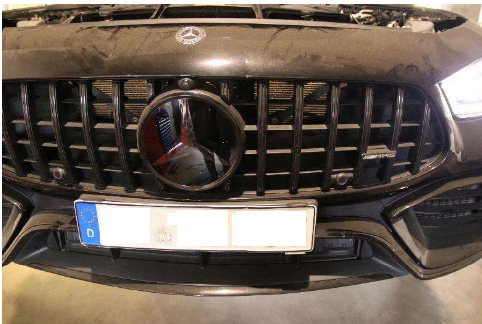
Bild: 16 Kennzeichen vorne mit Träger verformt
