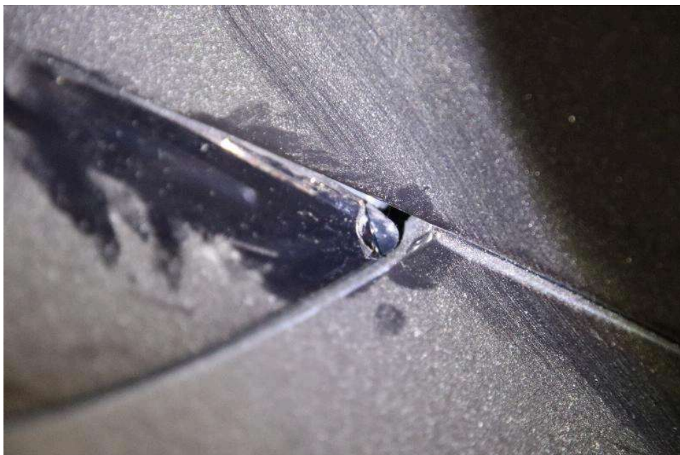
Bild: 22 Frontscheinwerfer mit unzulässiger Folie beklebt
