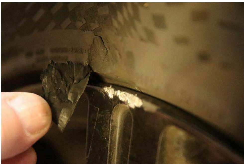
Bild: 48 Reifen und Felge vorne rechts beschädigt
