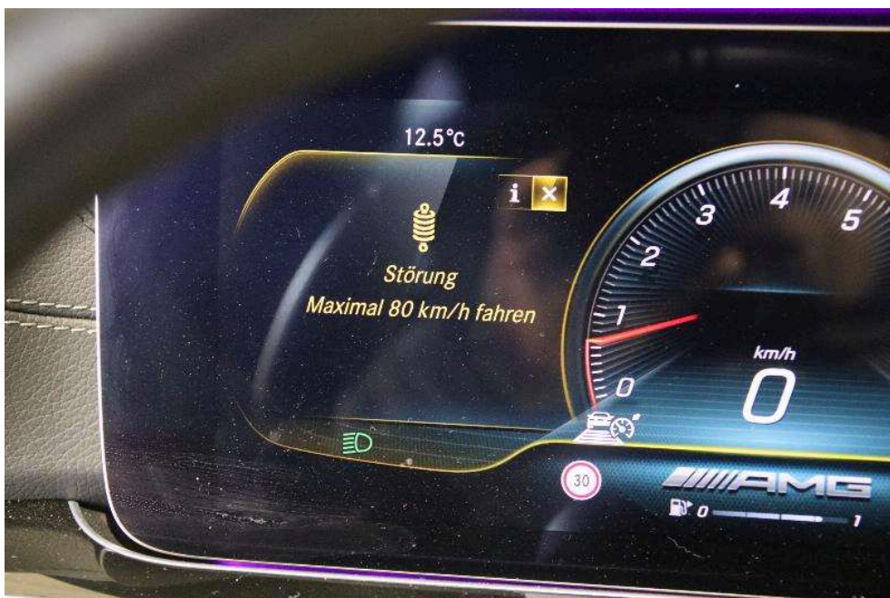
Bild: 52 Anzeige im Kombiinstrument Störung Fahrwerk
