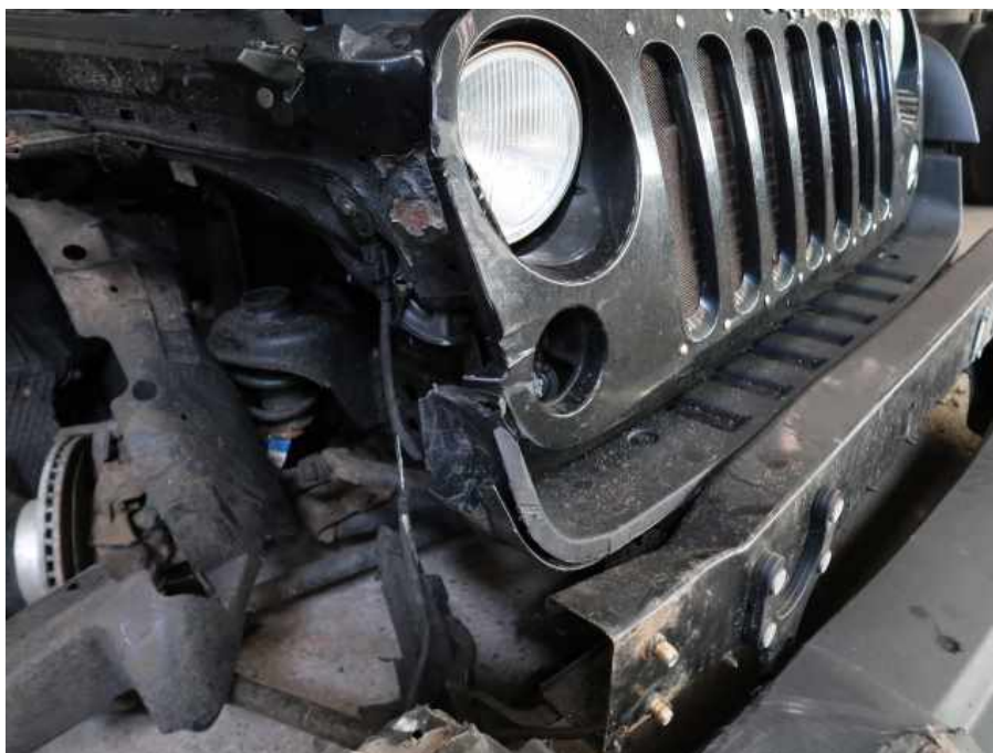
Verformter Kühlergrill und Querträger
